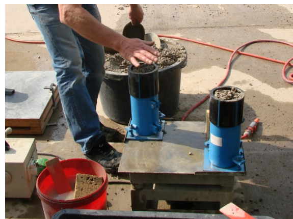
Abbildung 8: Herstellung der Zylinderproben des Prüfloses 1
