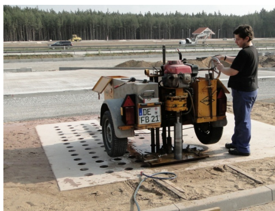
Abbildung 11: Bohrkernentnahme aus der Versuchsplatte
