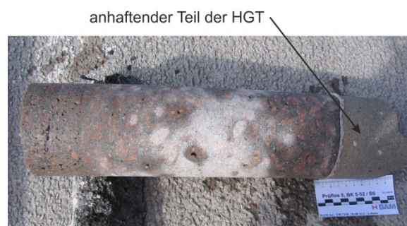
Abbildung 15: Bohrkern mit Vlies und anhaftendem Teil der hydraulisch gebundenen Tragschicht (HGT)
