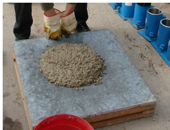
Abbildung 7: Frischbetonprüfung (Ausbreitmaß) während der Herstellung der Zylinder des Prüfloses 1
