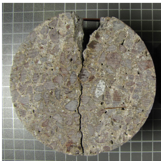
Abbildung 50: Schubbruch im Bereich der oberen Lasteinleitung einer Spaltzugprobe
