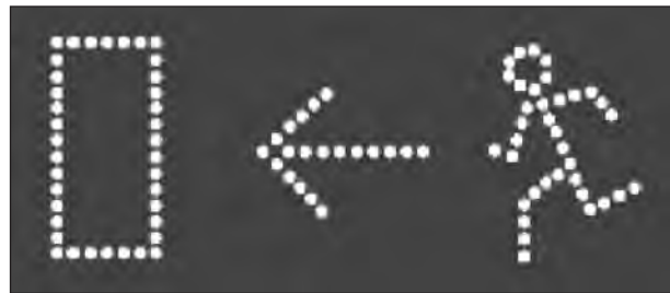
Bild 7.15: LED-Zeichen, jeder Punkt ist ein 5 mm 260 mcd grünes LED (aus: WRIGHT, COOK & WEBBER, o. J.)
