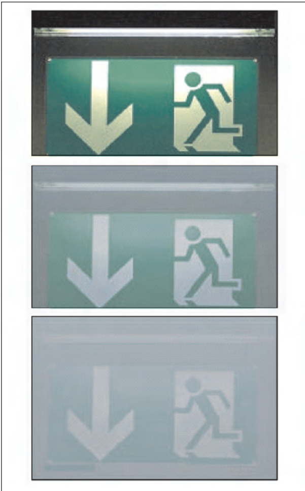
Bild 7.9: Brandrauch vermindert die Sichtbarkeit von Sicherheitszeichen (aus: BIESKE, 2003, S. 3)
