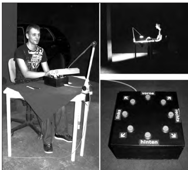
Bild 11.3: Versuchsteilnehmer mit Reaktionstastatur, links für das Foto beleuchtet, rechts realer Eindruck. Die Tastatur ist zur sicheren Bedienbarkeit beschriftet. Je nach Richtung, aus der der Proband den Sound gehört hat, drückt er die entsprechende Taste
