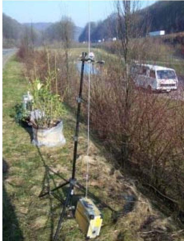
**Bild 121:** Luv-Messgerät mit Ansaugung in 2 Metern Höhe
