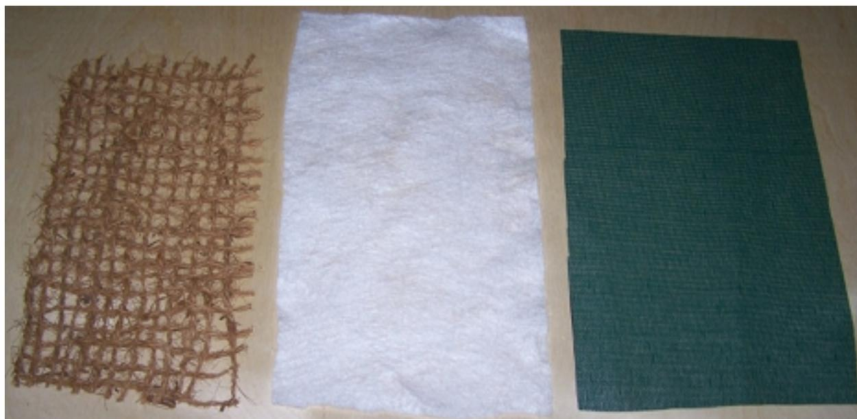
**Bild 31:** Gegenüberstellung der abiotischen Alternativen (links: Kokosfaser, mittig: Polyester-Filz, rechts: Windschutznetz)
