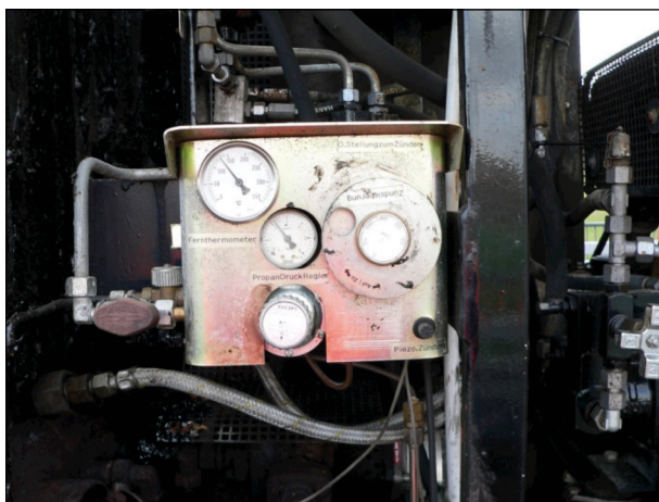
Bild 17: Erwärmung der Tränkmassse auf ca. 130 °C (1)
