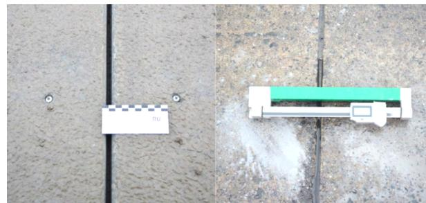
**Bild 19:** Messmarken und Fugenspaltmessung mit einem Setzdehnmessgerät (System der BAST in Anlehnung an [7])
