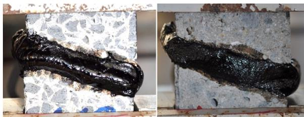
**Bild 98:** Einbauszustand der Systemprüfkörper bei +60 °C (links: FM1; rechts: FM4)
