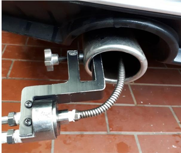
Abbildung 3-8 Entnahmesonde im Abgasendrohr
