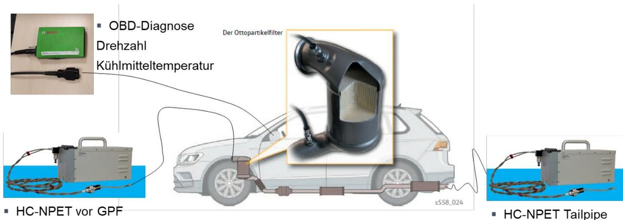
Abbildung 3-6 Skizze zur Anordnung/Aufbau der PN-Messgeräte und OBD-Diagnose (Prüffahrzeug A)
