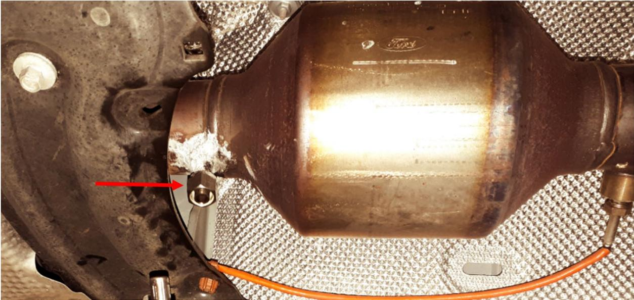
Abbildung 3-5 Edelstahlrohr mit Verbindungsmutter (Pfeil), eingeschweißt im Abgasstrang von Prüffahrzeug B
