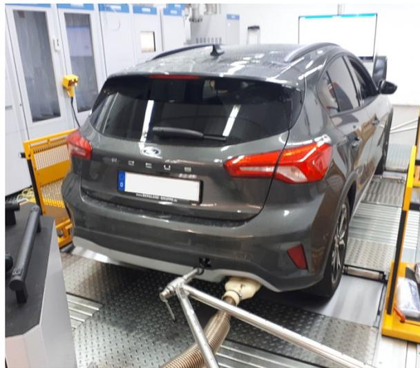
Abbildung 3-12: Prüffahrzeug B auf dem Rollenprüfstand im Abgaslabor
