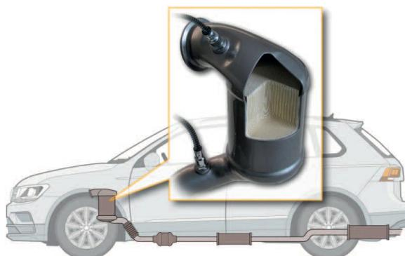
Abbildung 3-1 Anordnung von 3WC und GPF im Prüffahrzeug A (Volkswagen AG, 2017)
