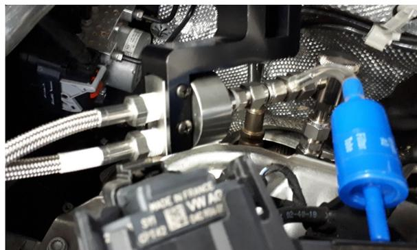
Abbildung 3-10 Druckminderer eingebaut in Prüffahrzeug A und mit Entnahmerohr und Entnahmesonde verbunden
