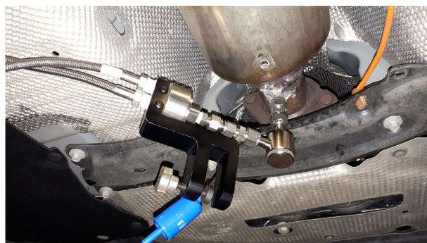
Abbildung 3-11 Druckminderer eingebaut in Prüffahrzeug B und mit Entnahmerohr und Entnahmesonde verbunden
