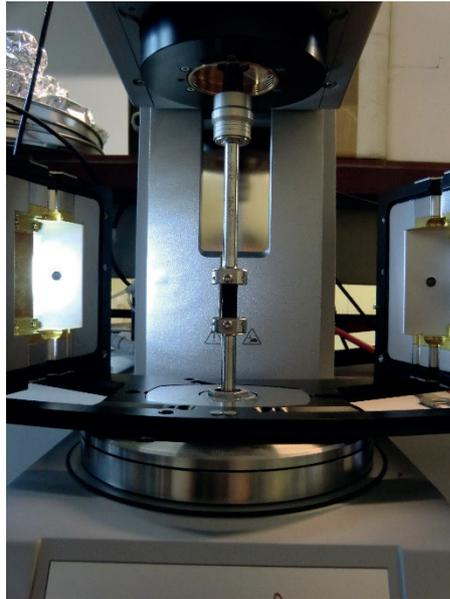
**Bild 20:** Festkörpereinspannung - Solid-Rectangular-Fixture (SRF)
