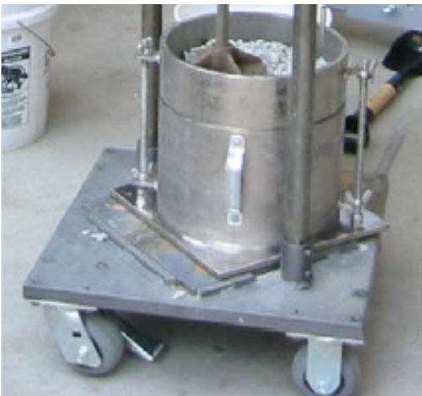
Bild 6: Ansicht des 11 Zoll Probenstopf mit eingesetzten Stampfer des Vibrationshammers [15]
