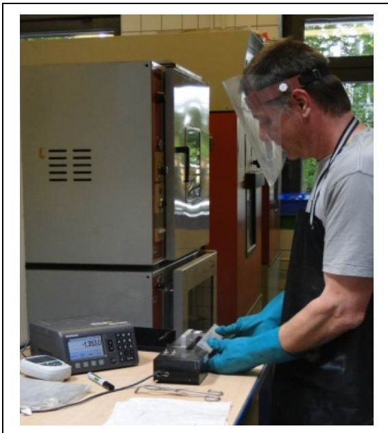
Abbildung 16: Dehnungsmessung beim Schnellprüfverfahren
