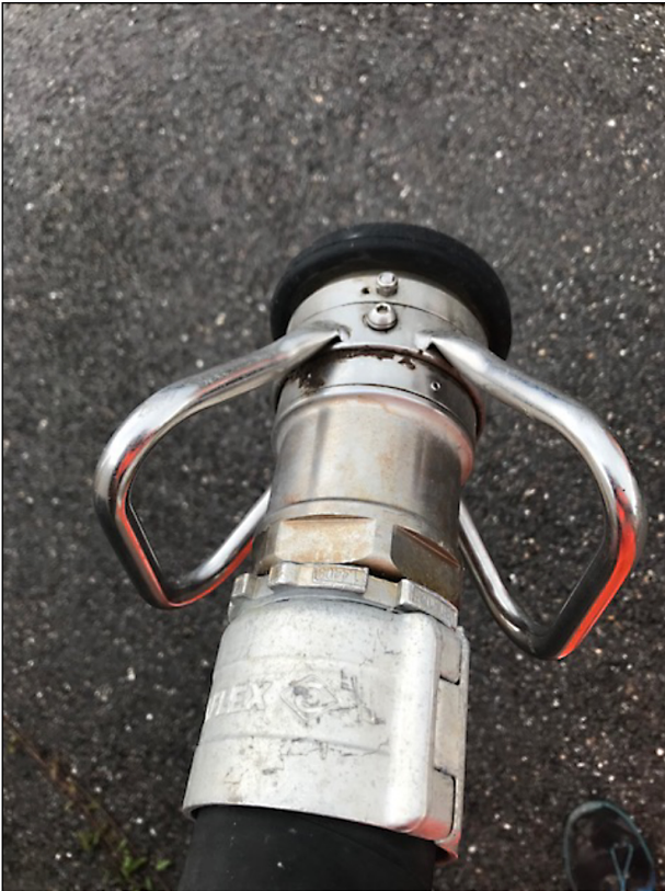
Bild 20: Schnellkupplung für tropffreies Betanken der Sole (Bild: AM Inning)
