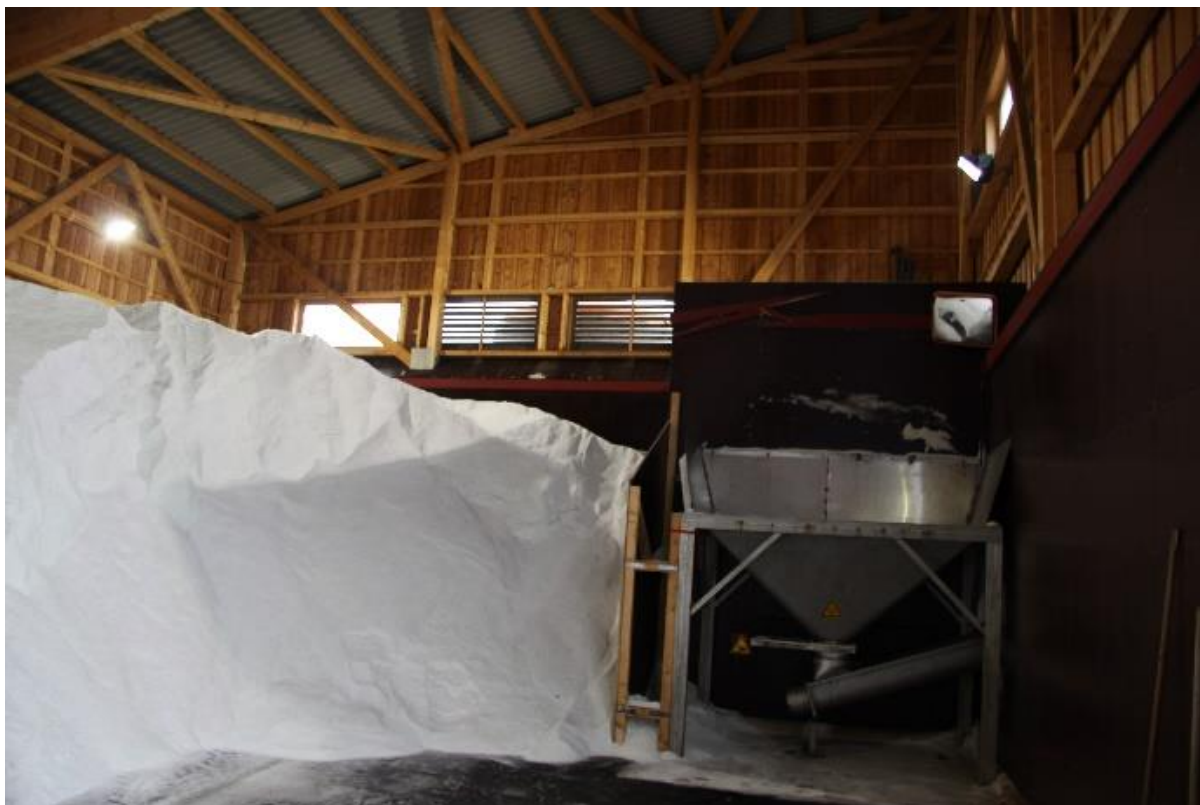
Streustoffhalle SM Northeim: Trichter zur Beschickung des Salzsilos (Bild: Cypra)
