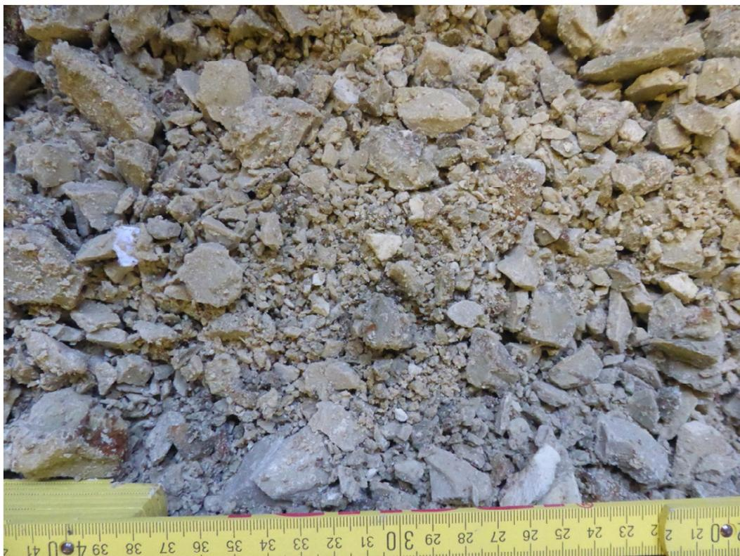
**Bild 5 / A:** aufbereitete Mischprobe, Bentonit < 31,5 mm
