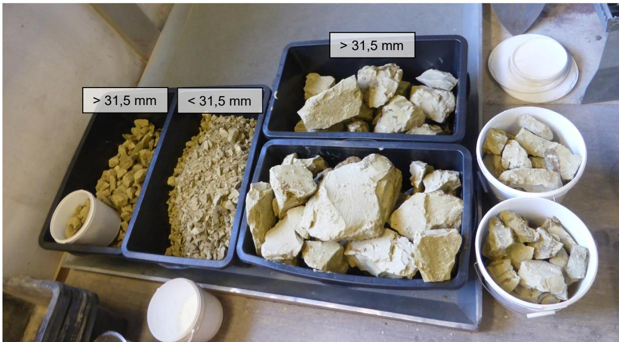
**Bild 4 / A:** aufbereitete Mischprobe, Bentonit (aufgeteilt in Anteile < 31,5 mm und Anteile > 31,5 mm)
