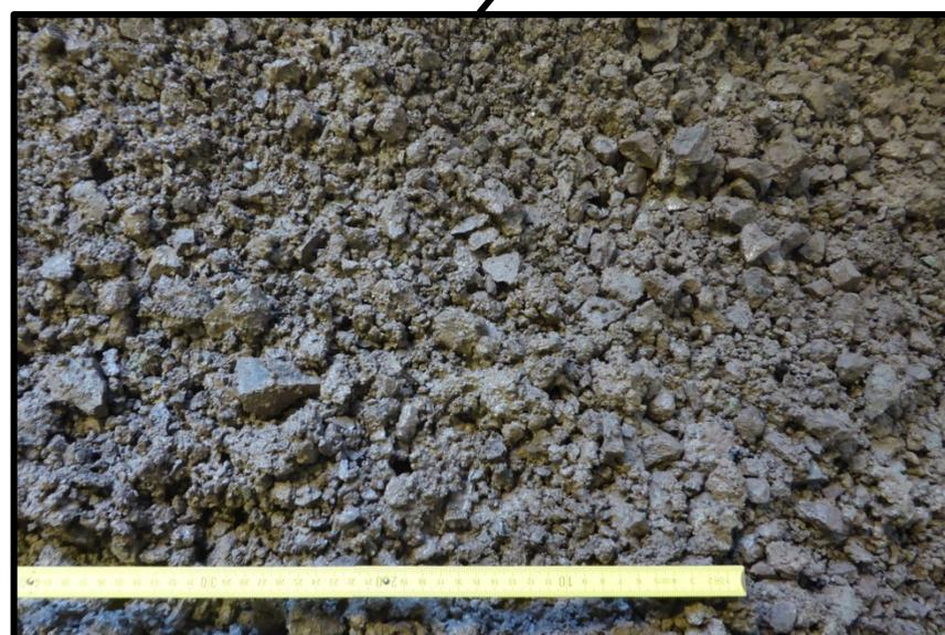
**Bild 8 / A:** aufbereitete Mischprobe < 31,5 mm, dunkelroter Mergel
