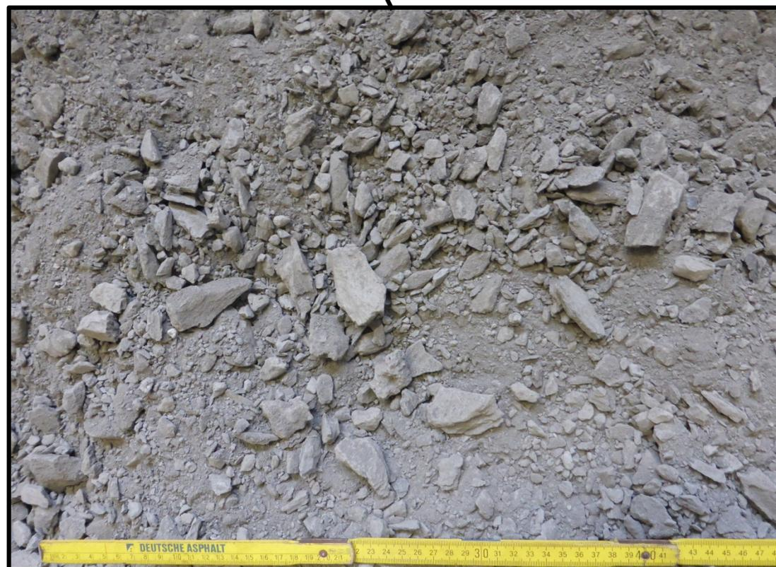
**Bild 2 / A:** aufbereitete Mischprobe < 31,5 mm, Opalinustonstein (MT)
