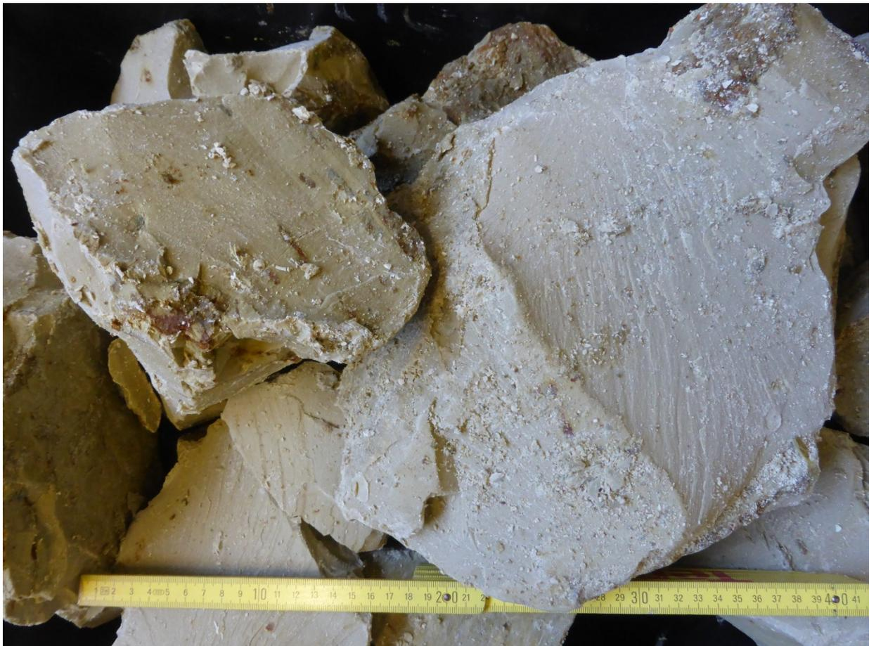
**Bild 6 / A:** aufbereitete Mischprobe, Bentonit > 31,5 mm
