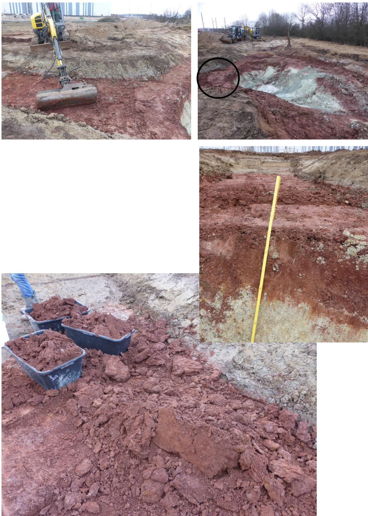
Bild 11 / A: Probenahme, Feuerletten-Zersatz
