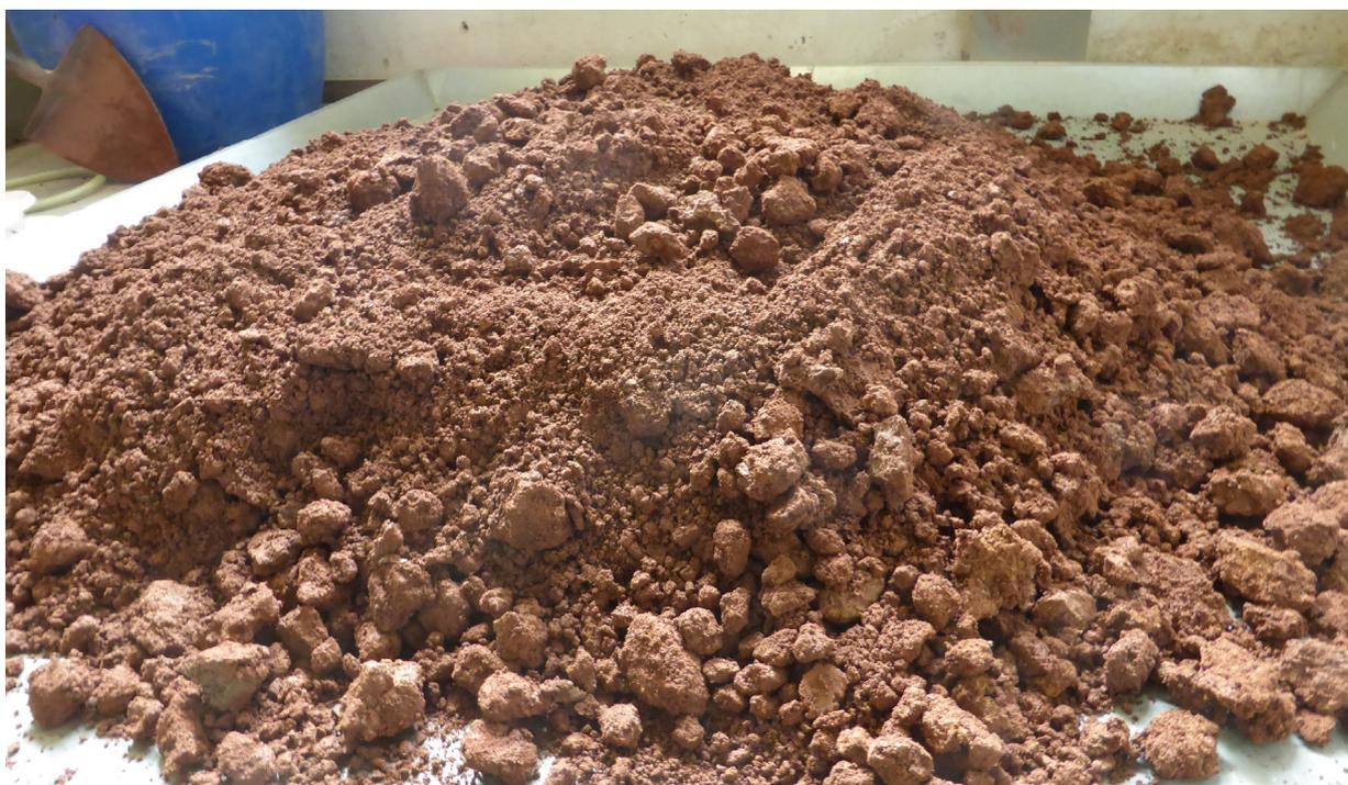
**Bild 12 / A:** aufbereitete Mischprobe < 31,5 mm, Feuerletten-Zersatz
