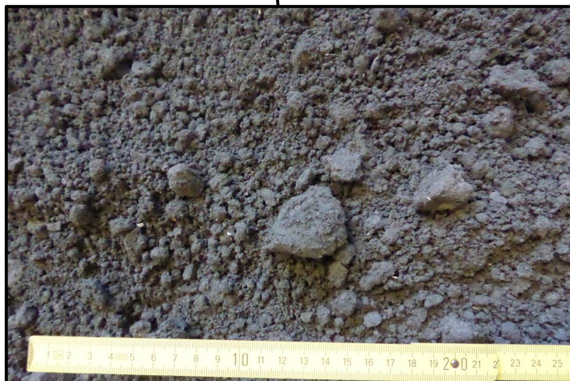
Bild 10 / A: aufbereitete Mischprobe < 31,5 mm, Emscher Mergel
