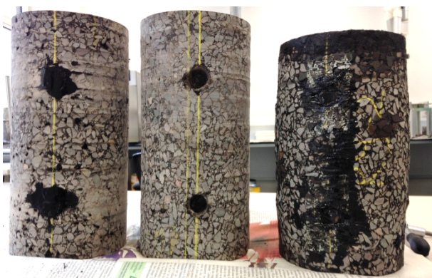
Bild 5.31: von links nach rechts: Probekörper für einen Zugversuch mit eingebauten Magneten, Probekörper für einen Druckversuch, Probekörper nach Versuchsende
