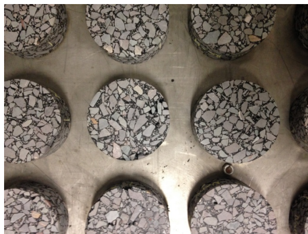
Bild 5.3 Lagerung der Probekörper auf dem Alterungstisch, Detailansicht
