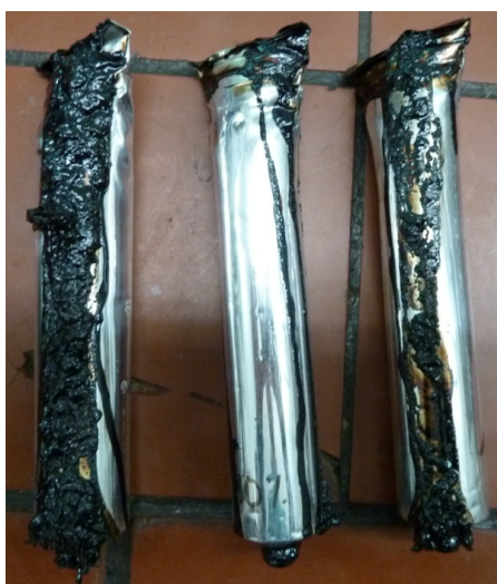
Bild 4.10 Aufgeschäumte NPBK Probe (oben); explosionsartig ausgetretene Tubentest-Probe (unten)
