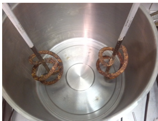
Bild 3.22: Reaktionsgefäß zur Synthese [MMT/PEI 10Q 80R10 ] – Addukte ( C2 – C7 ), (a) beheizbarer 30L – Rührkessel, (b) Blattrührer zum Anquellen / Mischen von MMT mit CTAB und Wasser, (c) Stahlhakenrührer zur Herstellung der Addukte.
