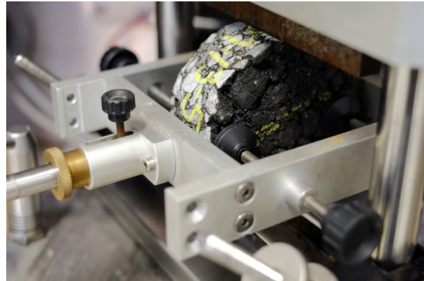
Bild 5.5 Asphaltprobekörper in eingebautem Zustand; Prüfvorrichtung für den Spaltzug-Schwellversuch
