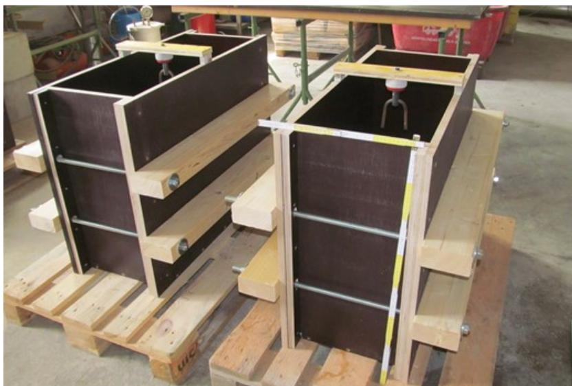
Bild 109: Schalungen für zwei Probekörper
