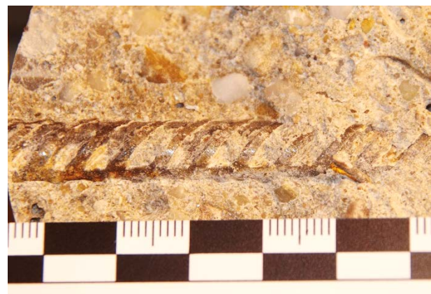
Bild 8: Stelle BK 4 stellenweise angerostet
