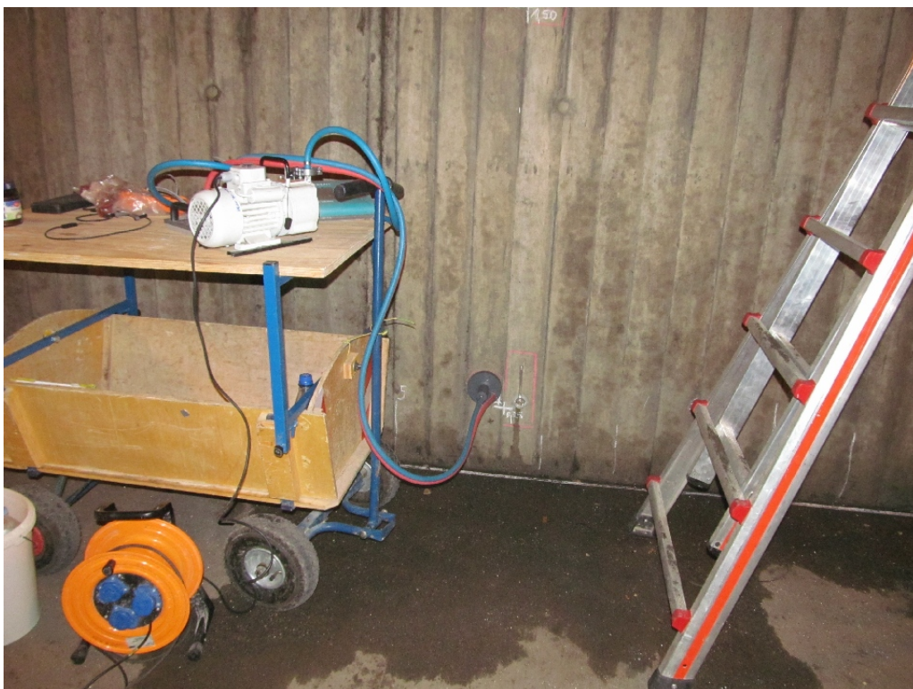
Bild 10 Messung der Luftpermeabilität
