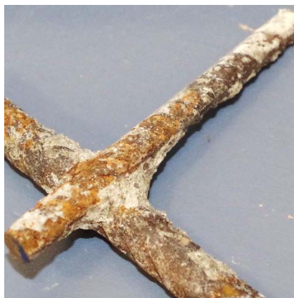
Bild 10: Stelle BK 2 flächig angerostet
