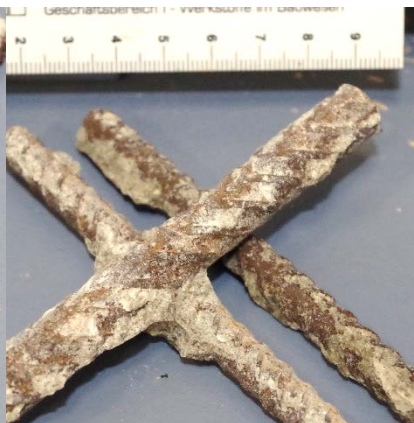
Bild 11: Stelle BK 3 flächig angerostet
