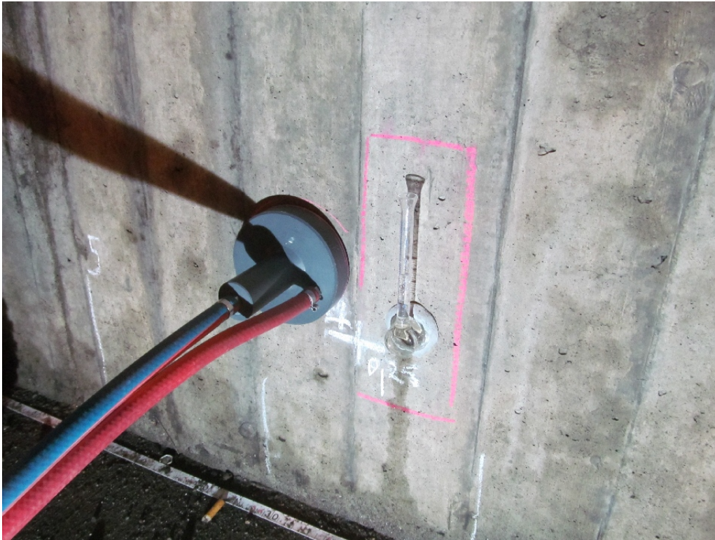
Bild 11 Messung der Luftpermeabilität (Messsonde links) und der kapillaren Wasseraufnahme
