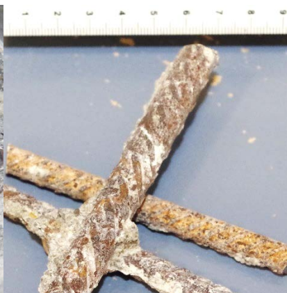
Bild 4: Stelle BK 5 flächig angerostet
