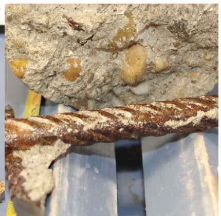
Bild 5: Stelle BK 6 flächig angerostet
