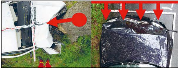
Abbildung 6: Arten der Kraffteinleitung (links: Baum, rechts: Schutzplanke) auf die Fahrzeugkarosserie (Ziegler et al. 2017)
