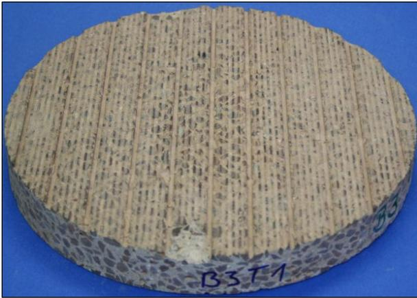
**Abbildung 270:** Bohrkerne (d = 300 mm) vor Beanspruchung mit der Prüfanlage ARTe: Waschbeton mit stetiger Sieblinie, Textur 1
