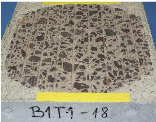
**Abbildung 259:** Bohrkerns ( $d = 300$  mm) nach Beanspruchung mit der Prüfanlage ARTe: Unterbeton, Textur 1
