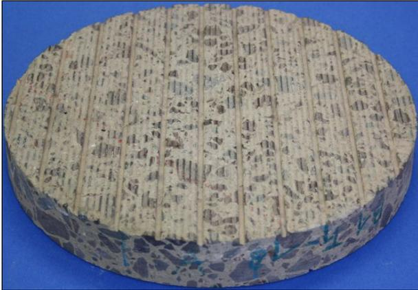
**Abbildung 258:** Bohrkerns ( $d = 300$  mm) vor Beanspruchung mit der Prüfanlage ARTe: Unterbeton, Textur 1
