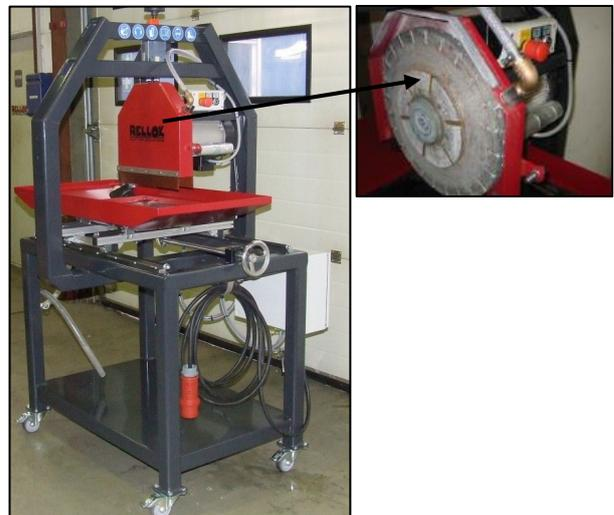
**Abbildung 107:** Laborgrindingmaschine mit Sägekopf und Sägeblättern
