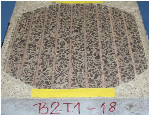
**Abbildung 265:** Bohrkerne (d = 300 mm) nach Beanspruchung mit der Prüfanlage ARTe: Waschbeton mit Ausfallkörnung, Textur 1
