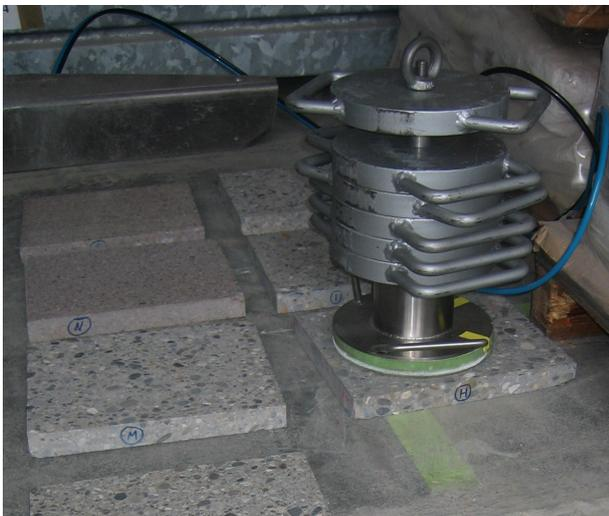
**Abbildung 115:** Bestimmung des Strömungswiderstands der Laborprobekörper
