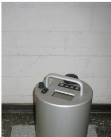
**Abbildung 111:** Messgerät ELAtextur auf einem Probekörper
