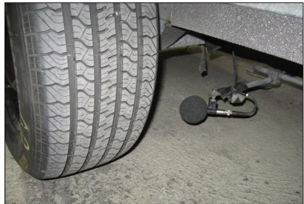
**Abbildung 82:** Reifen P mit Messmikrofon (Mikrofonposition vorne).
