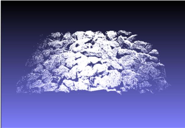
**Abbildung 56:** Punktwolke von einer grobkörnigen Fahrbahnoberfläche der Dimension 6 mal 12 Zentimeter
