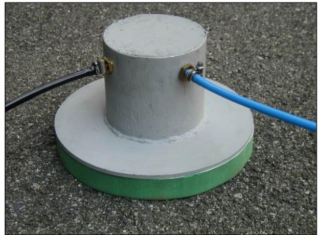
**Abbildung 63:** Messgerät für Strömungswiderstand: Messfuß mit elastischer Zwischenlage in unbelastetem Zustand
