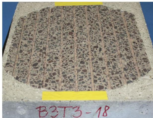
**Abbildung 275:** Bohrkerne (d = 300 mm) nach Beanspruchung mit der Prüfanlage ARTe: Waschbeton mit stetiger Sieblinie, Textur 3
