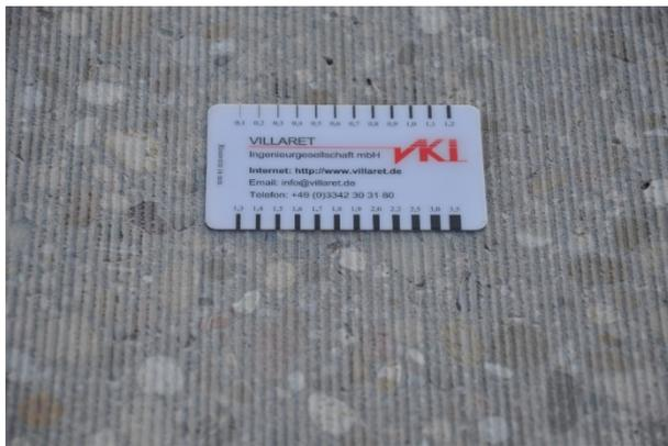
**Abbildung 307:** Grindingtextur auf der A 5, Testfeld V-1
