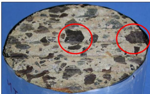
**Abbildung 253:** Nahaufnahme eines Bohrkerns des Unterbetons (Textur 3) nach 28 Frost-Tau-Wechseln
