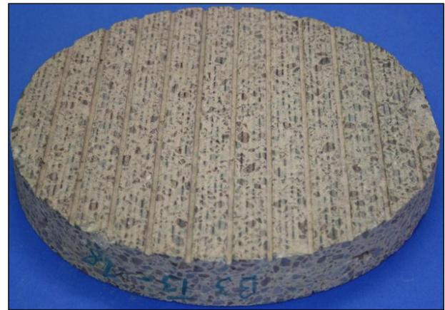
**Abbildung 274:** Bohrkerne (d = 300 mm) vor Beanspruchung mit der Prüfanlage ARTe: Waschbeton mit stetiger Sieblinie, Textur 3
