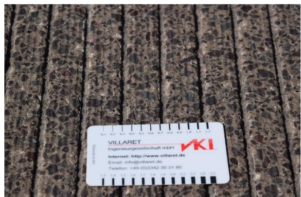
Abbildung 235: Grindingtextur auf der A 12, Testfeld 3.1
