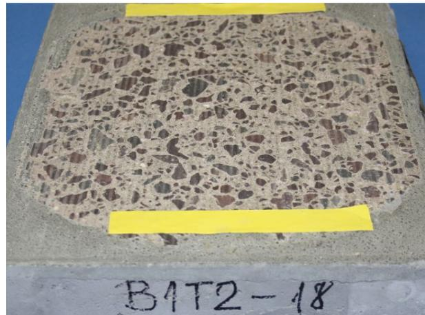
**Abbildung 261:** Bohrkerns ( $d = 300$  mm) nach Beanspruchung mit der Prüfanlage ARTe: Unterbeton, Textur 2
