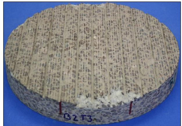
**Abbildung 268:** Bohrkerne (d = 300 mm) vor Beanspruchung mit der Prüfanlage ARTe: Waschbeton mit Ausfallkörnung, Textur 3
