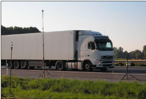
**Abbildung 74:** Beispielhafter Messaufbau nach der Statistischen Vorbeifahrtmethode (SPB)
