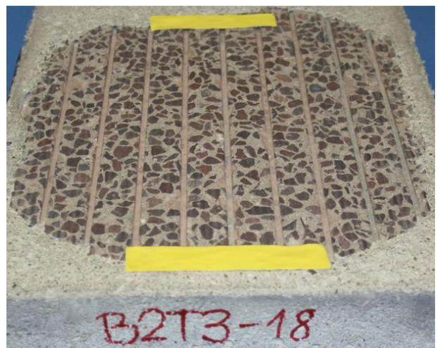
**Abbildung 269:** Bohrkerne (d = 300 mm) nach Beanspruchung mit der Prüfanlage ARTe: Waschbeton mit Ausfallkörnung, Textur 3
