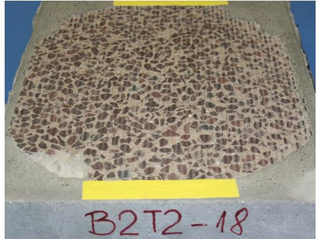
**Abbildung 267:** Bohrkerne (d = 300 mm) nach Beanspruchung mit der Prüfanlage ARTe: Waschbeton mit Ausfallkörnung, Textur 2
