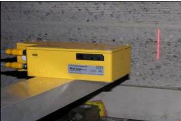
**Abbildung 16:** Lasermessung der Oberfläche im Labor, [SCOFIELD]
