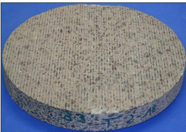
**Abbildung 272:** Bohrkerne (d = 300 mm) vor Beanspruchung mit der Prüfanlage ARTe: Waschbeton mit stetiger Sieblinie, Textur 2
