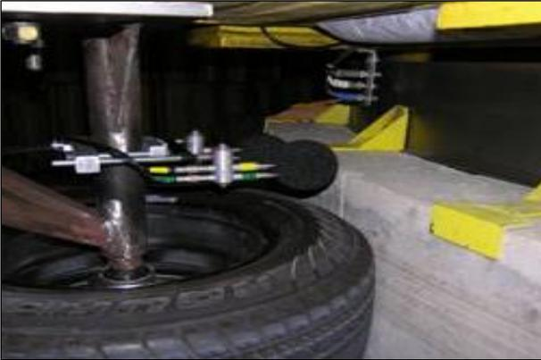
**Abbildung 15:** Messung der Reifen/Fahrbahngeräusche im Labor, [SCOFIELD]
