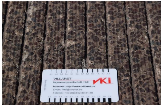
Abbildung 233: Grindingtextur auf der A 12, Testfeld 2.1
