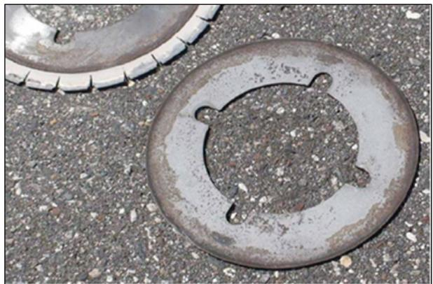
Abbildung 2: Schneidscheibe (links) mit Distanzscheibe (rechts)
