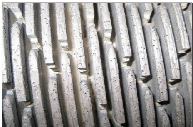
Abbildung 3: Diamantbesetzte Schneidsegmente
