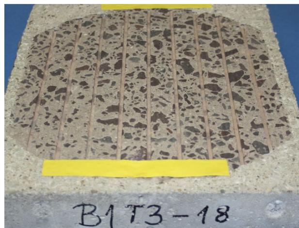
**Abbildung 263:** Bohrkerns ( $d = 300$  mm) nach Beanspruchung mit der Prüfanlage ARTe: Unterbeton, Textur 3
