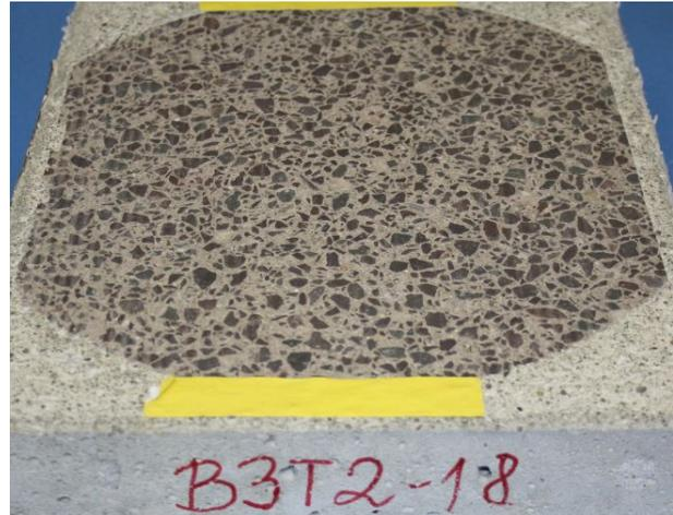
**Abbildung 273:** Bohrkerne (d = 300 mm) nach Beanspruchung mit der Prüfanlage ARTe: Waschbeton mit stetiger Sieblinie, Textur 2
