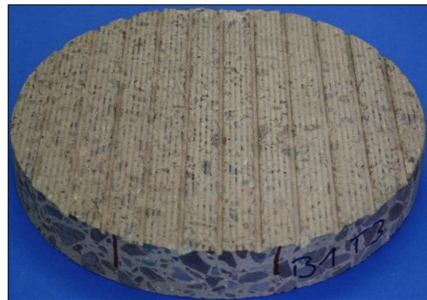
**Abbildung 262:** Bohrkerns ( $d = 300$  mm) vor Beanspruchung mit der Prüfanlage ARTe: Unterbeton, Textur 3
