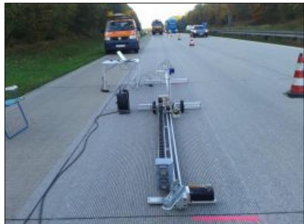
**Abbildung 27:** Aufstellung der Messsysteme für die Texturmessung: 3D-Kamera (hinten) und Laserprofilometer (vorne)
