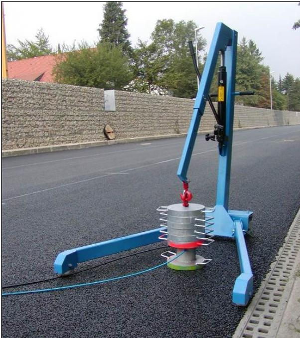
**Abbildung 64:** Messgerät zur Bestimmung des Strömungswiderstands in situ
