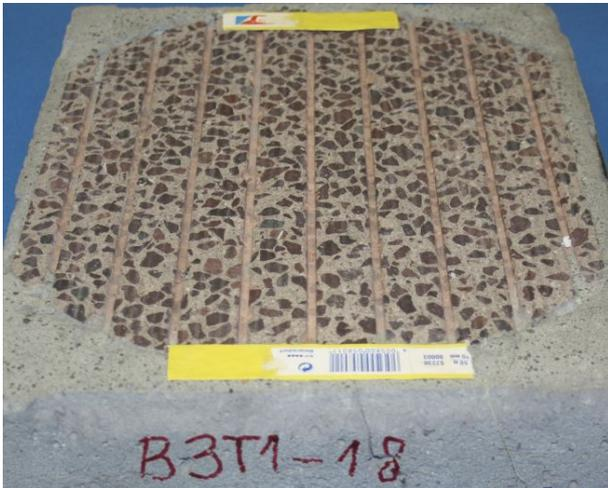
**Abbildung 271:** Bohrkerne (d = 300 mm) nach Beanspruchung mit der Prüfanlage ARTe: Waschbeton mit stetiger Sieblinie, Textur 1
