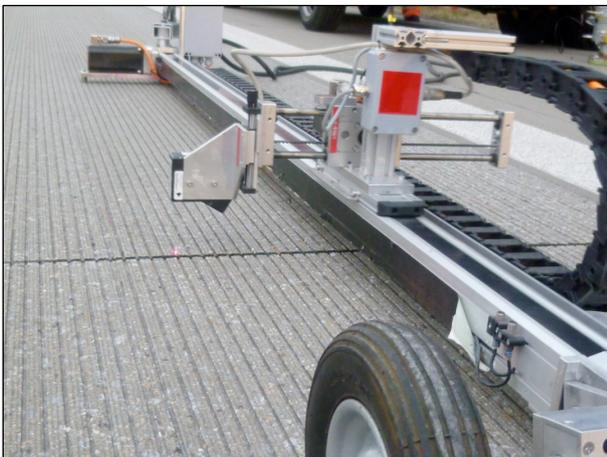
Abbildung 53: Laserprofilometer im Einsatz (A 13, MQ2)
