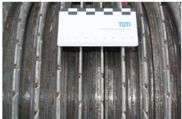
**Abbildung 303:** Wellenbesatz für Textur 2: oben: Grinding, unten: Grooving
