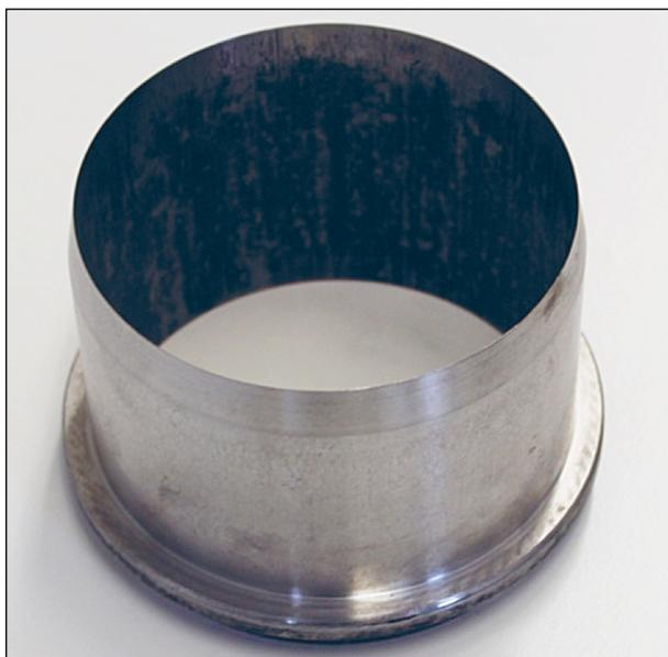
Bild 7: Stanzwerkzeug zur Herstellung von Proben für das KUNDT'sche Rohr mit einem Durchmesser von 100 mm
