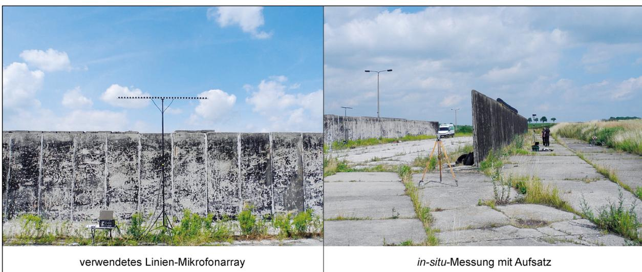
Bild 14: Messanordnung für die Fernfeldmessung durch AED
