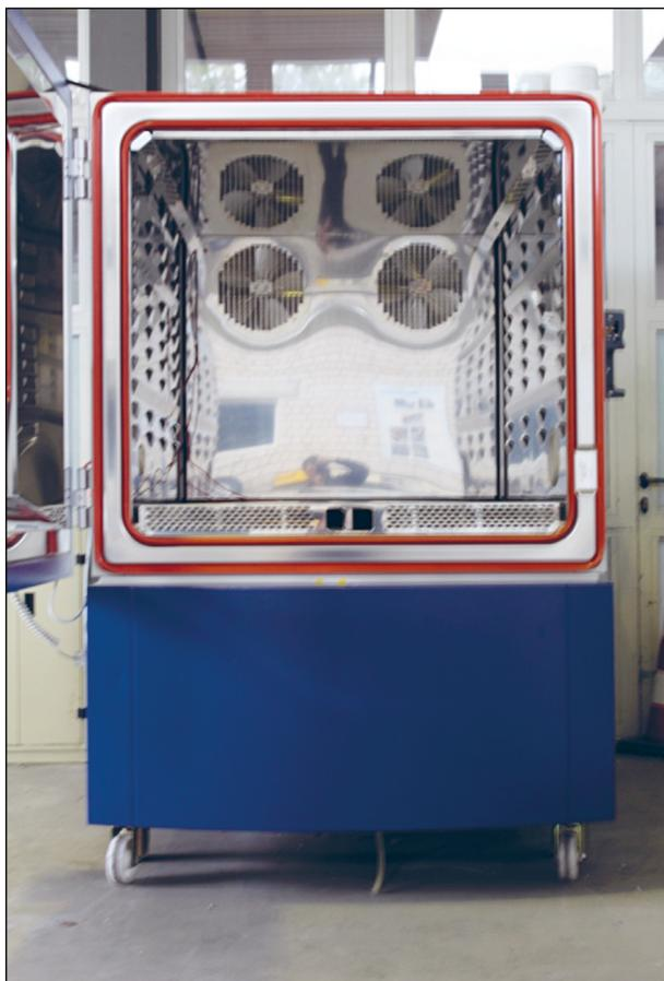
Bild 2: Für die Untersuchung der Temperaturbeständigkeit verwendete Klimakammer
