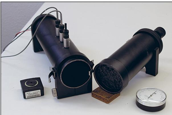
Bild 5: KUNDT'sches Rohr für einen Probendurchmesser von 100 mm
