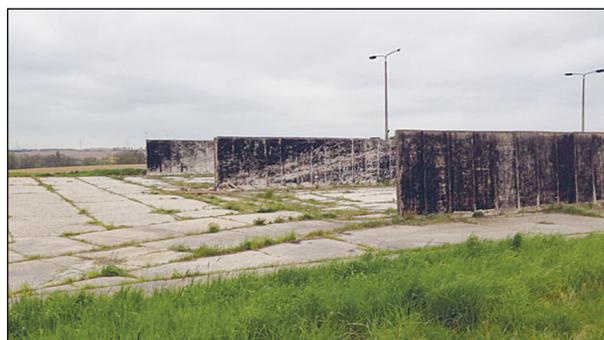
Bild 12: Messort mit drei parallelen Wänden zur Untersuchung durch AED
