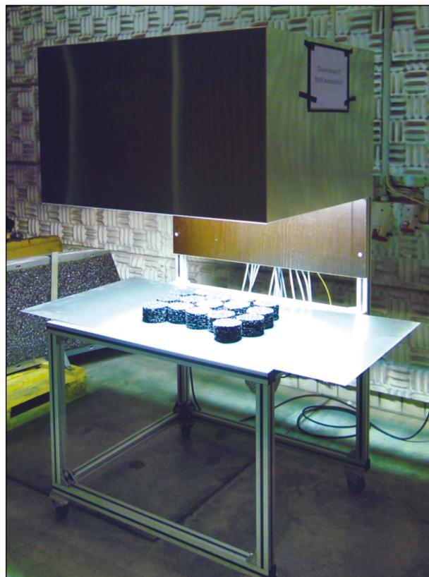
Bild 4: UV-Bestrahlungsgerät der BAST
