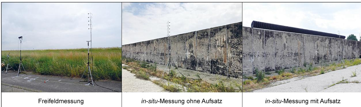
Bild 13: Messanordnung für die Nahfeldmessung durch AED
