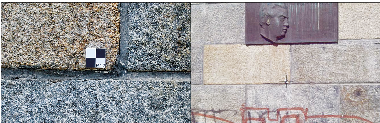
Bild 16: Ansicht Passpunkt P12 (links: Zielmarke im Detail, rechts: Zielmarke mit Fadenkreuz des Tachymeters)
