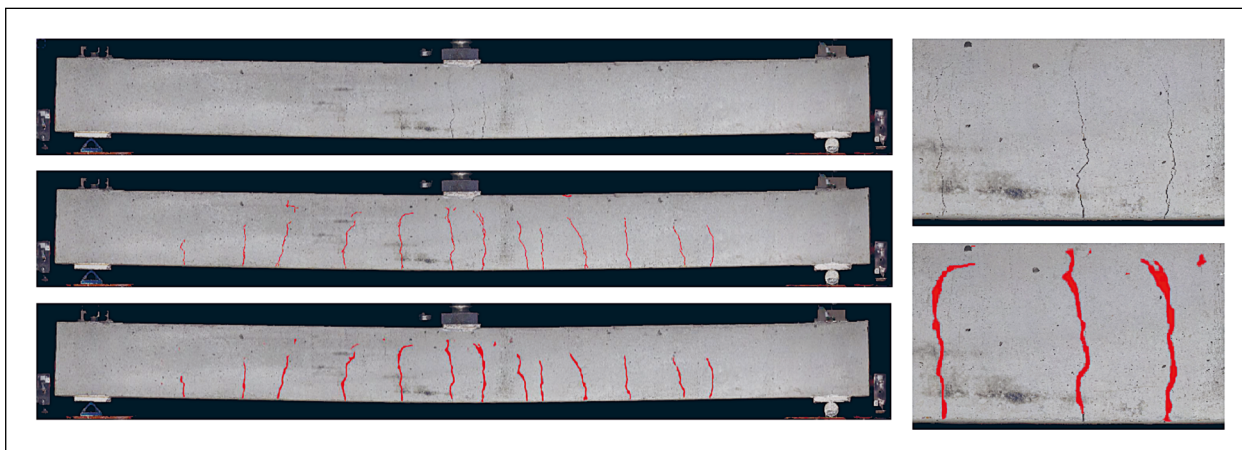
Bild 70: Fenster-basierte Ergebnisse (unten, rechts im Detail) von AlexNet nach Rissbildung durch einen Dreipunkt-Biegeversuch eines Betonbalkens (oben, rechts im Detail). Die manuell annotierten Risse sind zum Vergleich in der Mitte dargestellt
