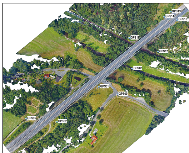
Bild 22: Draufsicht (grobes 3D-Bauwerks- und Geländemodell) der Elstertalbrücke mit den georeferenzierten Passpunkten in der Umgebung des Bauwerks
