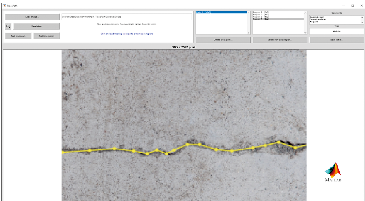
Bild 52: Benutzeroberfläche des interaktiven MATLAB-Tools CrackIdent zur manuellen linienhaften Annotation von Rissen
