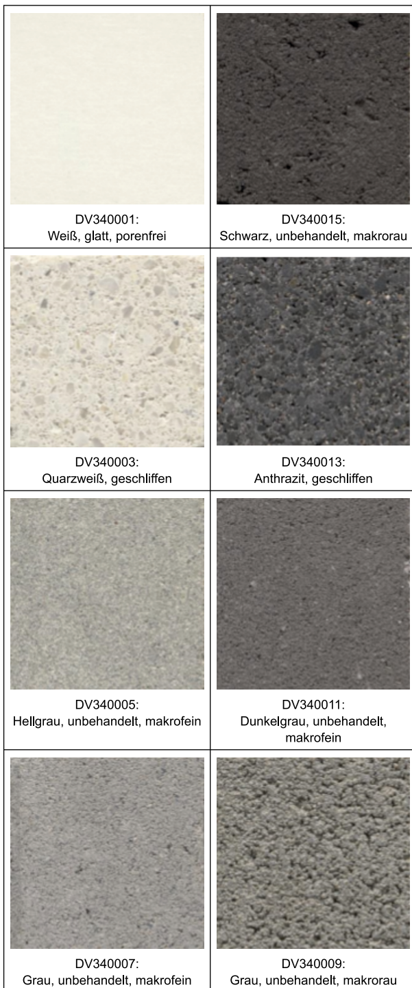
Bild 7.1: Fotografische Darstellung der untersuchten neutralfarbigen Betonsteinproben [WIL 2014]
