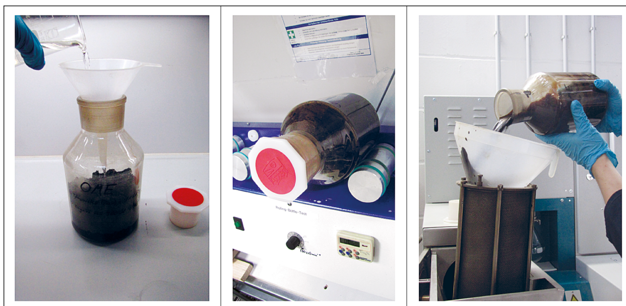
Bild 38: Weithalspyknometer mit Probe und OME (links), Flaschenrollgerät mit Pyknometer (Mitte), Einfüllen in Extraktionsanlage (rechts)
