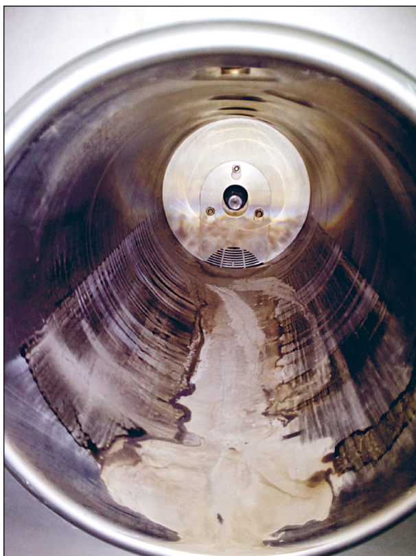
Bild 23: Rückstände von Füller und Bitumen in der Waschkammer nach Extraktion mit 2 Waschgängen und einer jeweiligen Dauer von ca. 15,7 min
