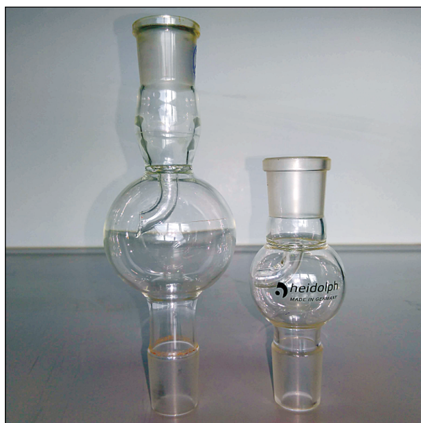
Bild 13: Neu angefertigte Schaumbremse mit doppelter Kapazität (links) und Standard-Schaumbremse des Herstellers Heidolph (rechts)
