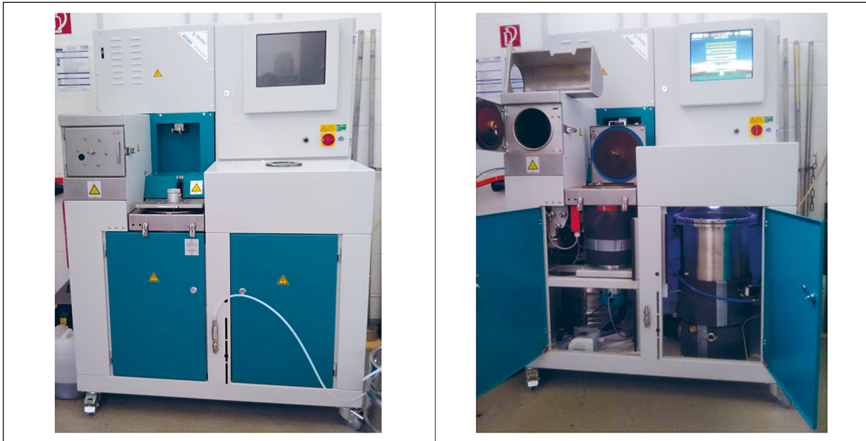
Bild 3: Vollautomatische Extraktionsanlage mit OME als Lösemittel am ISBS – links mit geschlossenen und rechts mit geöffneten Türen
