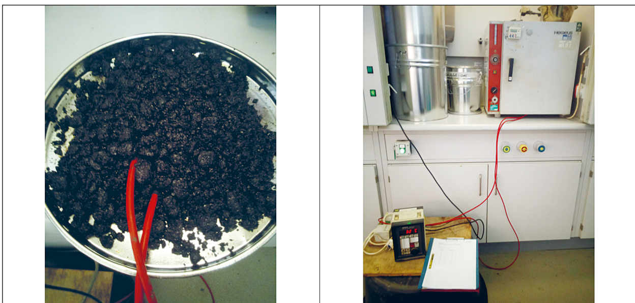
Bild 30: Mischgut mit Temperaturfühler (links) und Messung der Mischguttemperatur beim Vorwärmen im Ofen (rechts)
