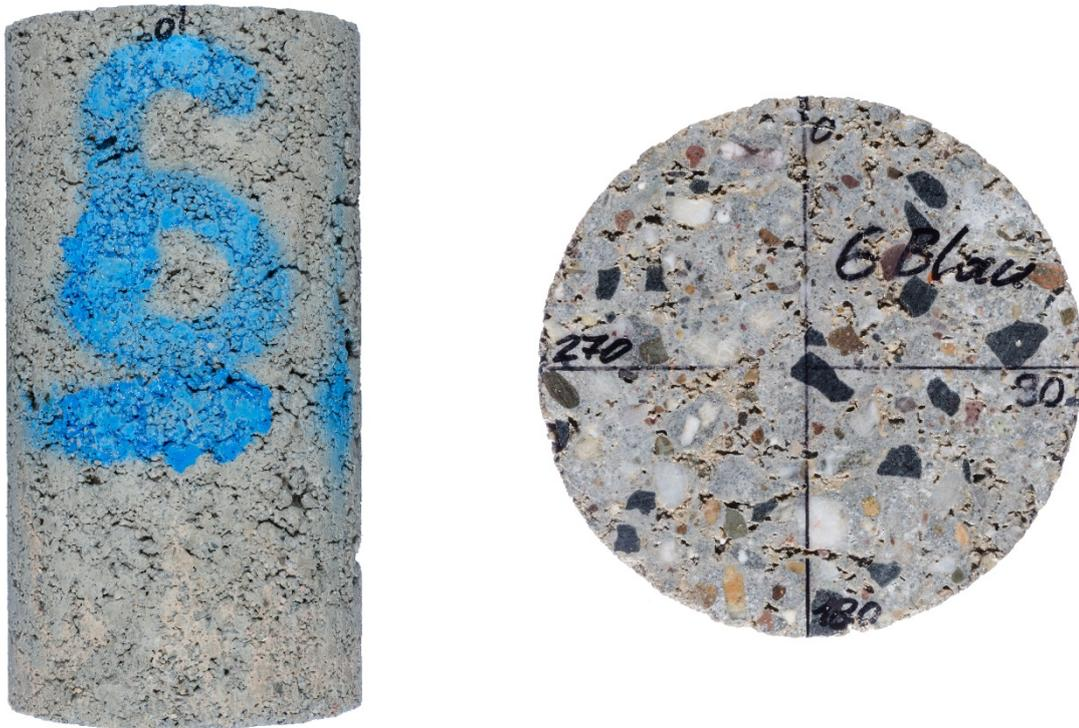
**Bild 46:** Im Labor hergestellter HGT-Prüfkörper (Zylinder Durchmesser 150 mm, Höhe 300 mm) aus RC-AKR-Material der Variante A9-0 (links) und geschliffene Stirnfläche (rechts) nach 9-monatiger Lagerung im Klima (40/100).
