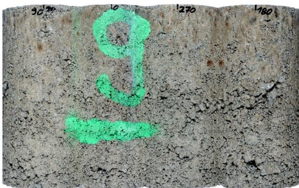
**Bild 49:** Gesamte Mantelfläche des HGT-Prüfkörpers aus RC-AKR-Material der Variante A9-1 nach 9-monatiger Lagerung im Klima (40/100).
