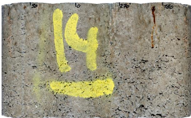
**Bild 61:** Gesamte Mantelfläche des HGT-Prüfkörpers aus RC-AKR-Material der Variante A14-2 nach 9-monatiger Lagerung im Klima (40/100).
