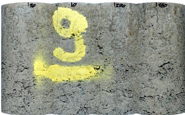
**Bild 51:** Gesamte Mantelfläche des HGT-Prüfkörpers aus RC-AKR-Material der Variante A9-2 nach 9-monatiger Lagerung im Klima (40/100).
