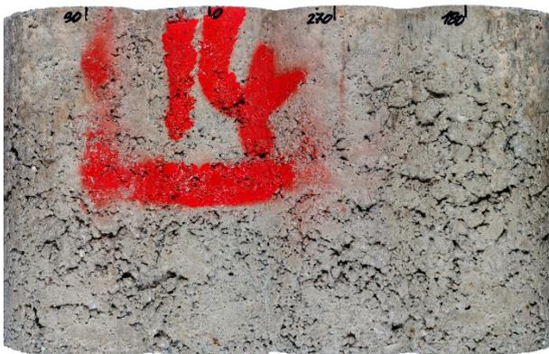
**Bild 63:** Gesamte Mantelfläche des HGT-Prüfkörpers aus RC-AKR-Material der Variante A14-3 nach 9-monatiger Lagerung im Klima (40/100).
