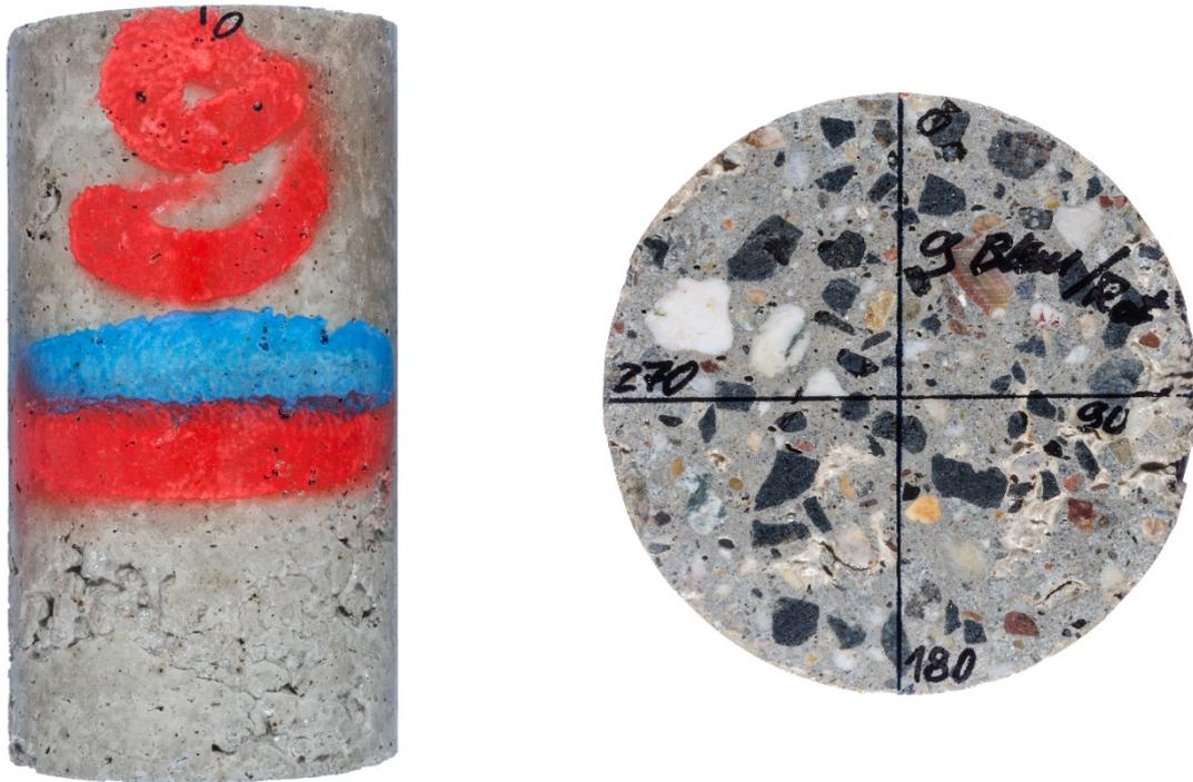
**Bild 54:** Im Labor hergestellter HGT-Prüfkörper (Zylinder Durchmesser 150 mm, Höhe 300 mm) aus RC-AKR-Material der Variante A9-Global (links) und geschliffene Stirnfläche (rechts) nach 9-monatiger Lagerung im Klima (40/100).
