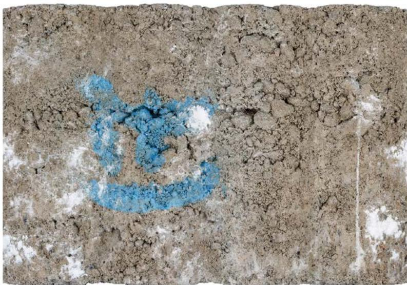
**Bild 75:** Gesamte Mantelfläche des HGT-Prüfkörpers aus RC-AKR-Material der Variante km 17+800 nach 9-monatiger Lagerung im Klima (40/100).
