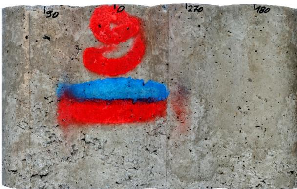
**Bild 55:** Gesamte Mantelfläche des HGT-Prüfkörpers aus RC-AKR-Material der Variante A9-Global nach 9-monatiger Lagerung im Klima (40/100).
