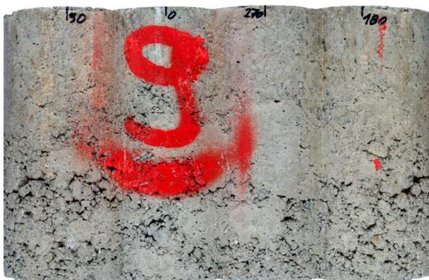
**Bild 53:** Gesamte Mantelfläche des HGT-Prüfkörpers aus RC-AKR-Material der Variante A9-3 nach 9-monatiger Lagerung im Klima (40/100).
