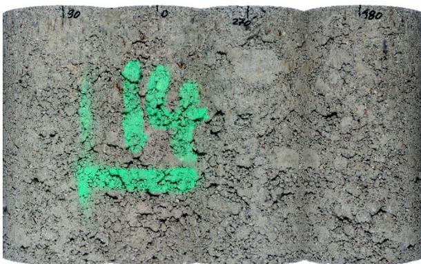
**Bild 59:** Gesamte Mantelfläche des HGT-Prüfkörpers aus RC-AKR-Material der Variante A14-1 nach 9-monatiger Lagerung im Klima (40/100).
