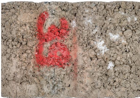
**Bild 69:** Gesamte Mantelfläche des HGT-Prüfkörpers aus RC-AKR-Material der Variante km 39+000 nach 9-monatiger Lagerung im Klima (40/100).
