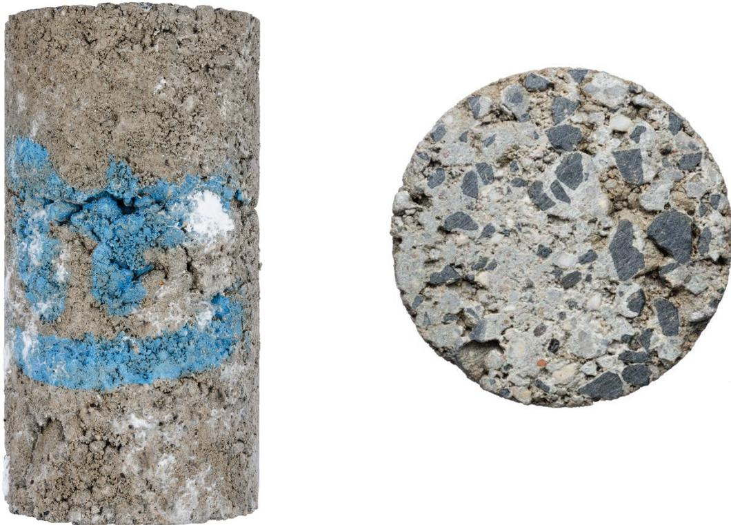
**Bild 74:** Im Labor hergestellter HGT-Prüfkörper (Zylinder Durchmesser 150 mm, Höhe 300 mm) aus RC-AKR-Material der Variante km 17+800 (links) und geschliffene Stirnfläche (rechts) nach 9-monatiger Lagerung im Klima (40/100).
