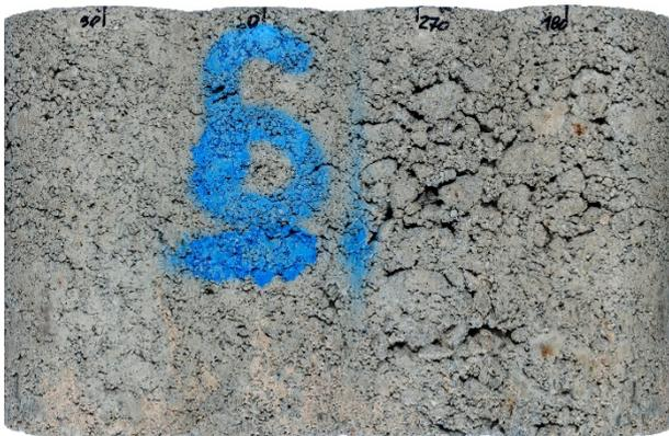
**Bild 47:** Gesamte Mantelfläche des HGT-Prüfkörpers aus RC-AKR-Material der Variante A9-0 nach 9-monatiger Lagerung im Klima (40/100).
