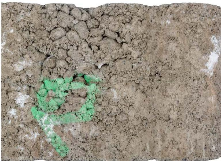
**Bild 73:** Gesamte Mantelfläche des HGT-Prüfkörpers aus RC-AKR-Material der Variante km 19+200 nach 9-monatiger Lagerung im Klima (40/100).
