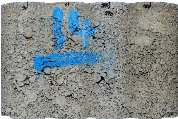
**Bild 57:** Gesamte Mantelfläche des HGT-Prüfkörpers aus RC-AKR-Material der Variante A14-0 nach 9-monatiger Lagerung im Klima (40/100).
