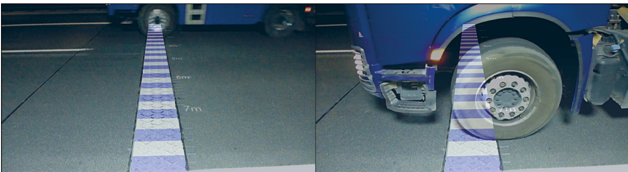
Bild 9: Bestimmung der Überfahrposition und Geschwindigkeit mittels Videoaufzeichnung
