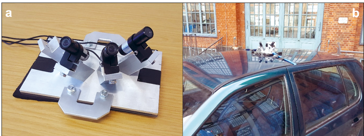
Bild 3-4: Kameras auf konstruierter Halterung a), Kamerasystem auf Messfahrzeug b)
