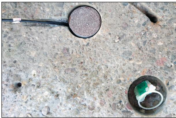
Bild 42: Feuchtesensoren (BS2 links oben und BAM rechts unten) auf der duraBAST (eigene Aufnahme)
