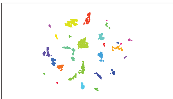
Bild 74: Eingebettete Merkmale des Dehnungssensors MS18 eingefärbt nach Gruppierung durch den DBSCAN Algorithmus (Nachbarschaftsgröße: 9). Hier wurden keine Ausreißer erkannt.
