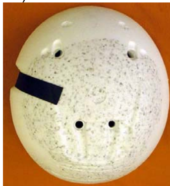
Abbildung 3-12: Draufsicht auf die Schutzpolsterung. Es sind die 4 Belüftungskanäle zu erkennen sowie die unterschiedliche Dichte des EPS
