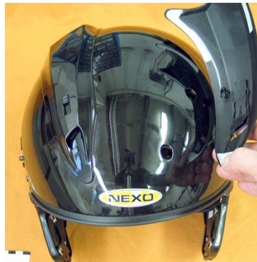
Abbildung 3-32: Kopfbelüftung mit einseitig demontierter Abdeckung
