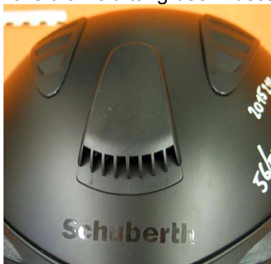
Abbildung 3-46: Draufsicht auf das Kopfbelüftungssystem
