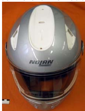
Abbildung 3-28: Belüftung bei demontierter Abdeckung
