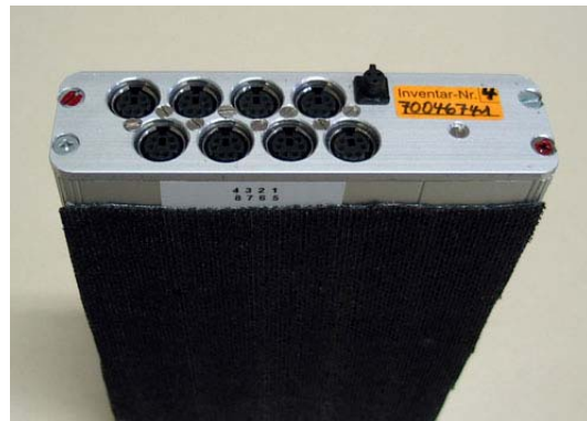
Abbildung 4-10: Zentraleinheit li. Seite: Anschlussbuchsen für 8 Kanäle plus Fernmarker
