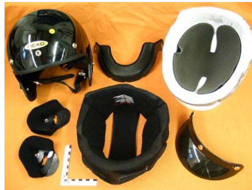
Abbildung 3-36: Übersichtsaufnahme der Bestandteile nach Zerlegung
