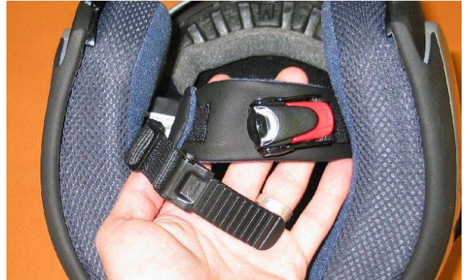
Airoh SV 55 - Zahnriemenschluss *Ratschen Schnellverschluss
