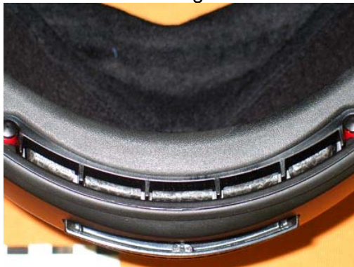
Abbildung 3-42: Draufsicht auf die Gesichtsfeldbelüftung
