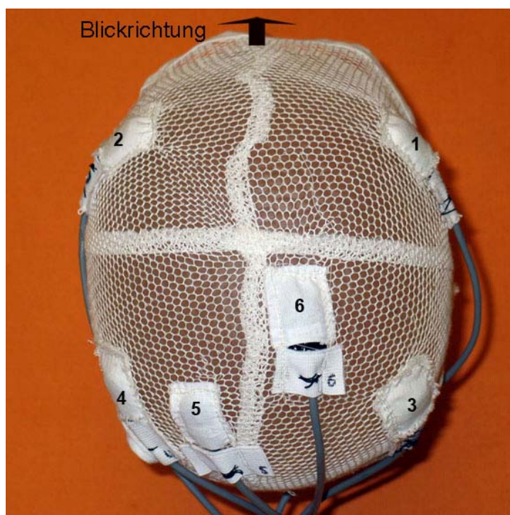
Abbildung 4-20: Position Temperaturmessfühler (Teil 1 und 2)
