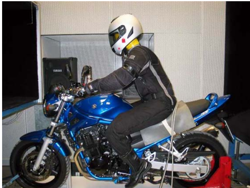
Abbildung 4-23: Auf dem Motorrad installierter Kraftmessroboter
