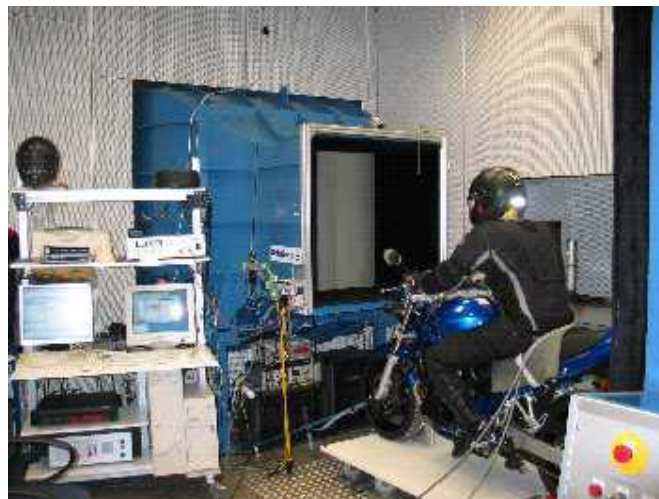
Abbildung 4-8: Übersichtsaufnahme Windkanal mit Messtechnik
