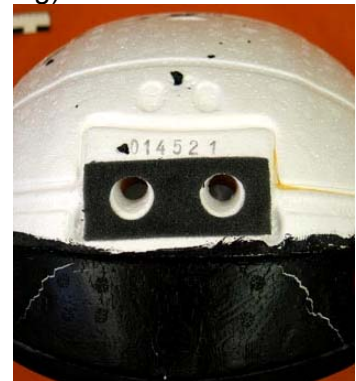
Abbildung 3-44: Belüftungskanälen und Abdichtung
