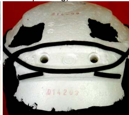
Abbildung 3-39: Schutzpolsterung mit Belüftung und Dichtlippe
