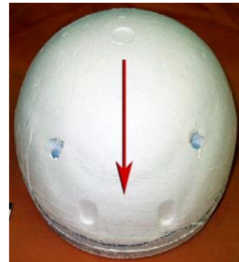
Abbildung 3-33: Schutzpolsterung; Pfeil zeigt in Fahrtrichtung
