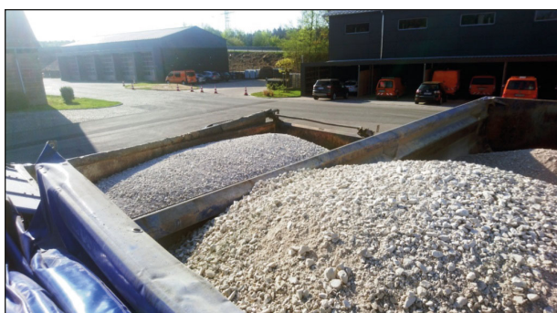
Bild 122: Ladungsverteilung, 3-Achs-Lkw im Hintergrund, 5-Achs-Lkw im Vordergrund
