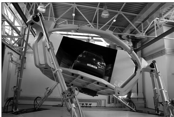
Bild 12: Dynamischer Fahrsimulator des DLR
