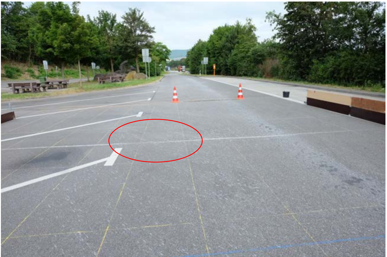
Bild 28: Blick auf den zusammengekehrten Salzstrang nach Überfahrt 2
