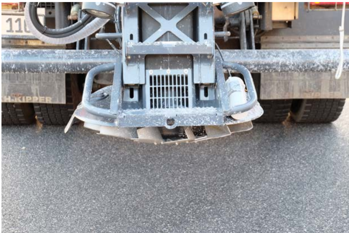
Bild 4: Detailansicht Streuteller mit Blick auf Streuflügel und Fächer
