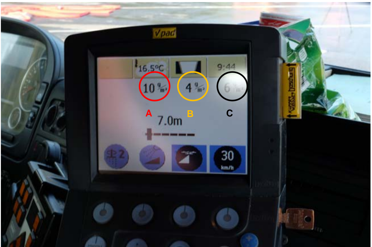
Bild 14: V- Pad: Darstellung der 3 Werte: A: Pumpe Trockenstoff; B: Fördermenge adaptive Pumpe (Solezugabepunkt 1); C: Fördermenge Pumpe für Solezugabepunkt 2 am Streuteller
