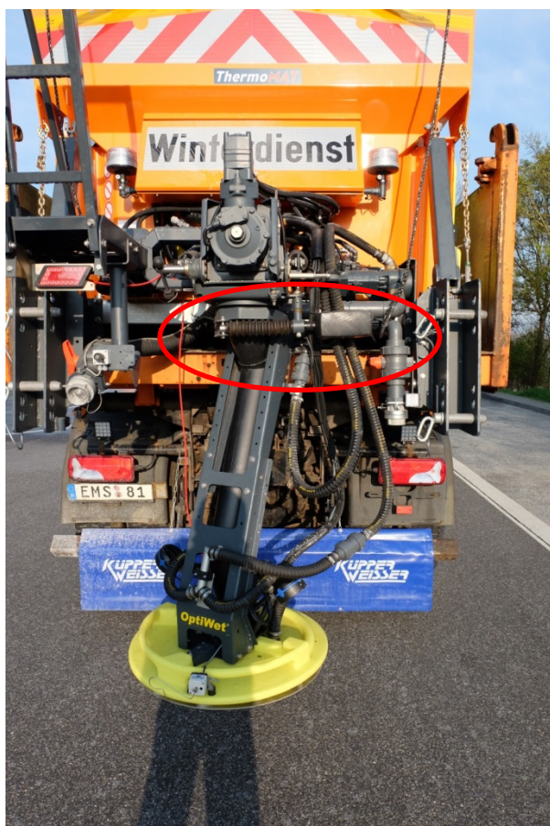
Bild 29: Hubzylinder für die Verstellung der Streustreifenlage
