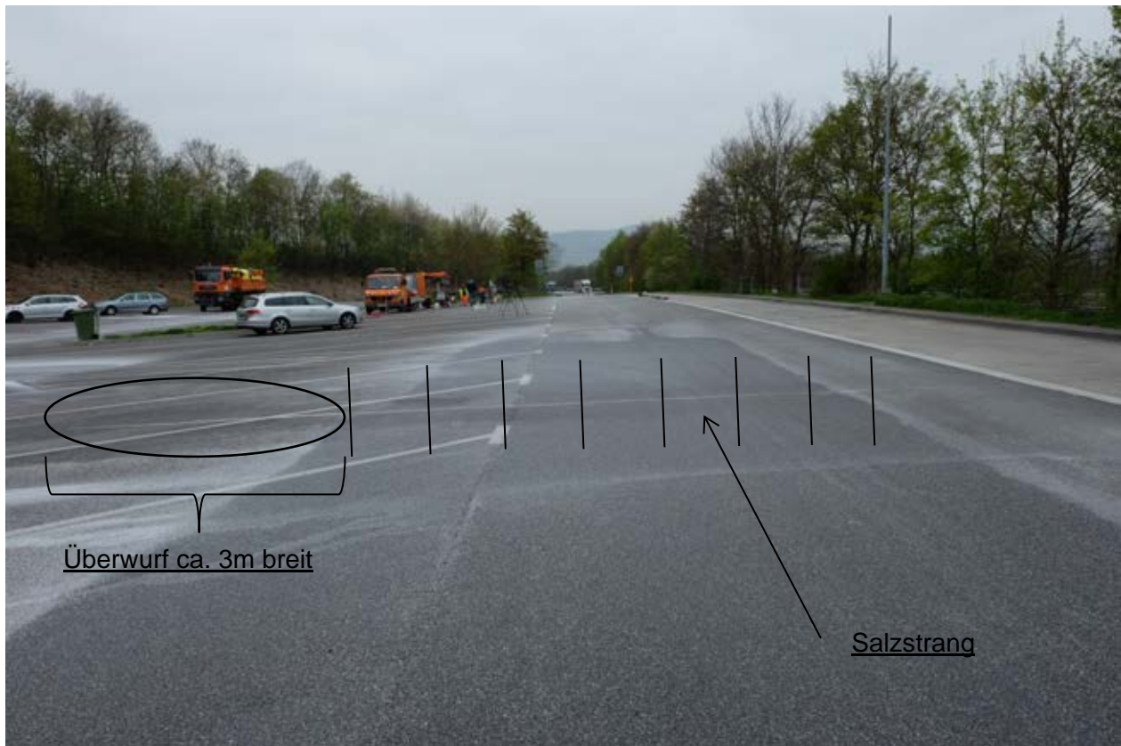
Bild 36: Streubildlegung für den Prüfpunkt 20 g/m 2 - 7 m- 50 km/h
