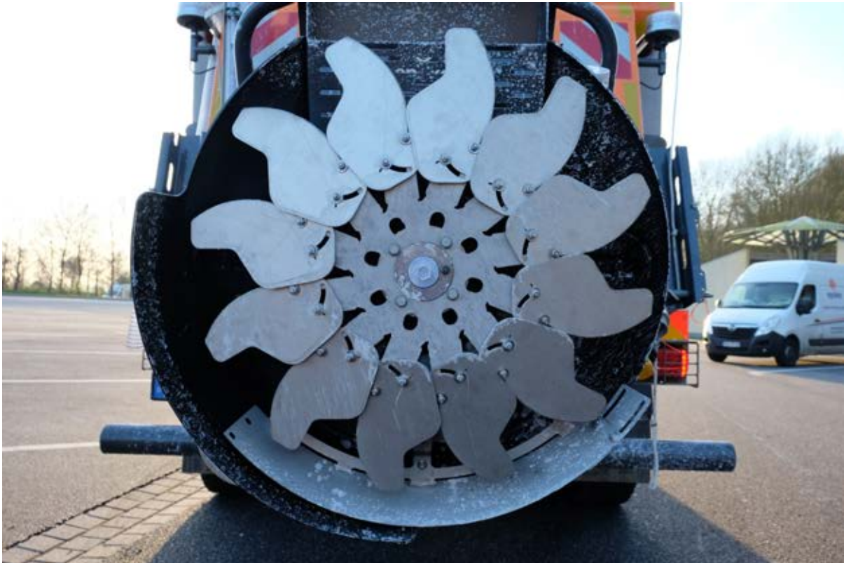
Bild 5: Blick auf die Unterseite des Streutellers mit Anordnung der Flügel
