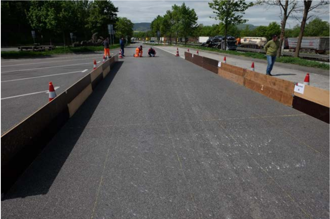
Bild 10: Blick auf Prüffeld nach Überfahrt 2; an der getrockneten Sole kann man die Reichweite erkennen
