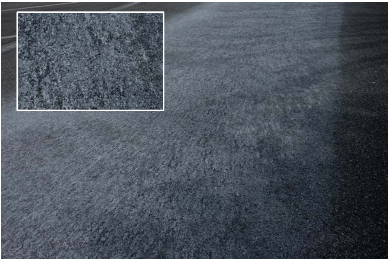
Bild 16: Blick auf Streustoffverteilung Salz 0-2mm im Detail
