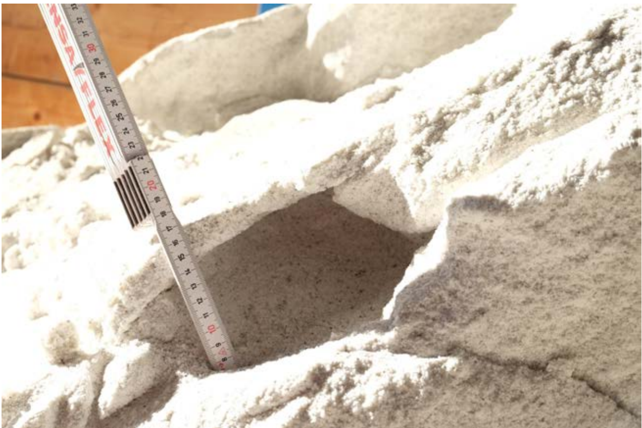
Bild 26: Blick auf eine Brückenbildung
