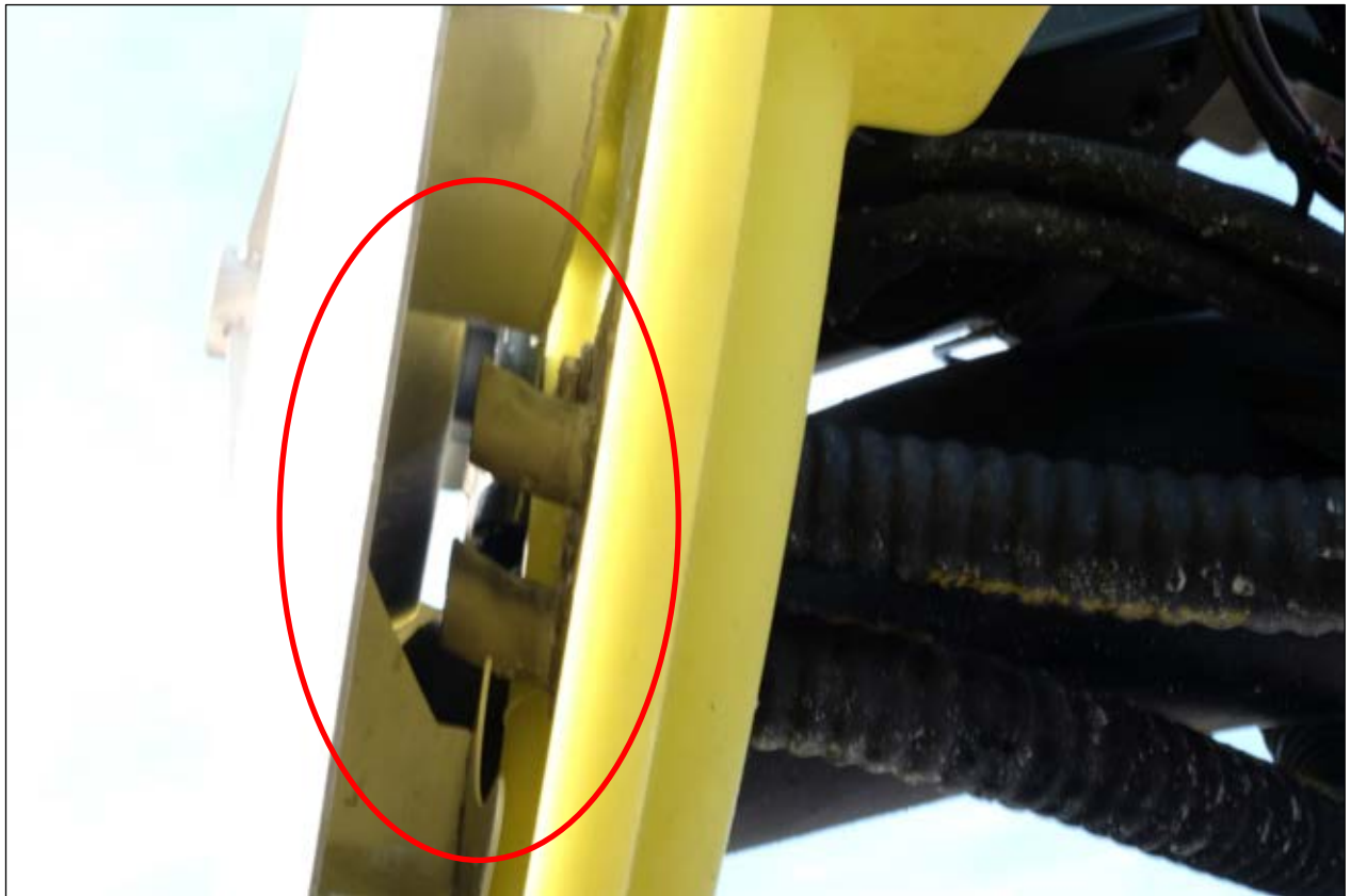
Bild 11: Detailansicht des zweiten Solezugabepunktes am Streuteller mit zwei Düsen
