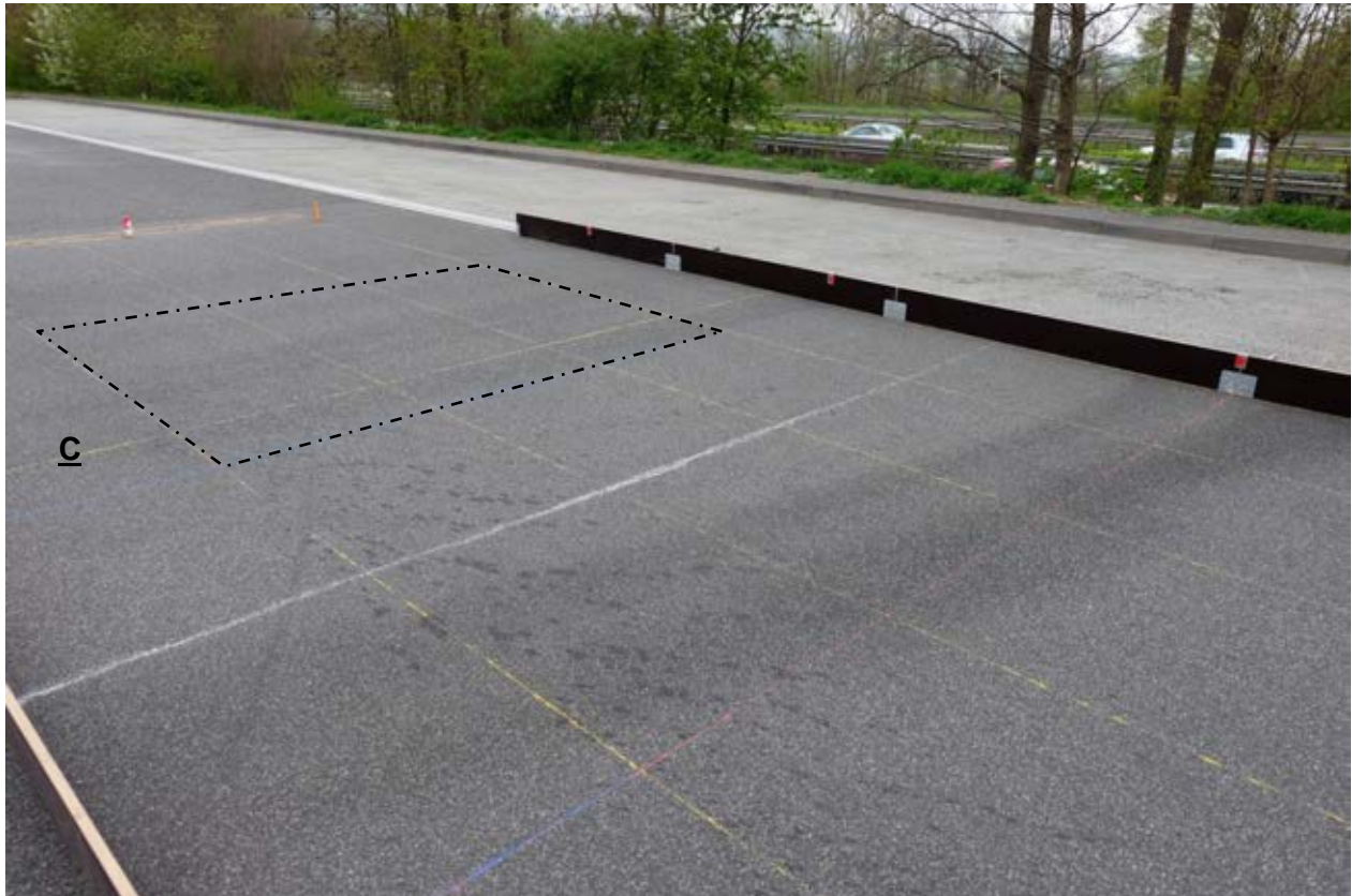
Bild 19: Blick auf das Prüffeld C, Überfahrt 2 mit zusammengefügtem Salz im Zwischenfeld
