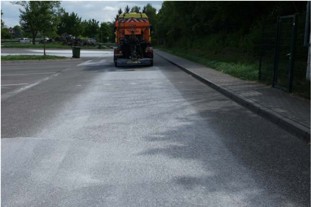
Bild 15: Blick auf Streustoffverteilung bei Einstellung auf extrafeines Salz 0-2mm
