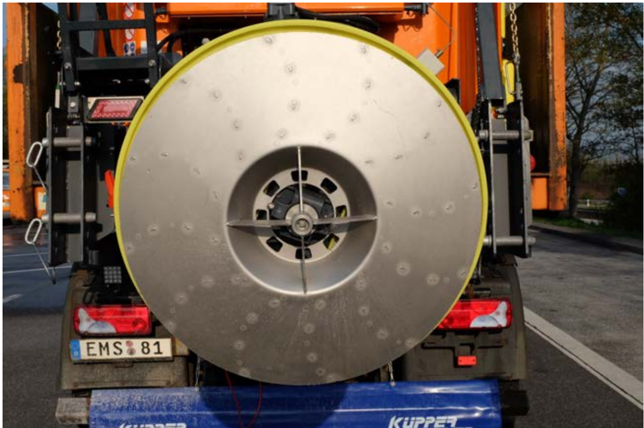
Bild 5: Blick auf die Unterseite des Streutellers
