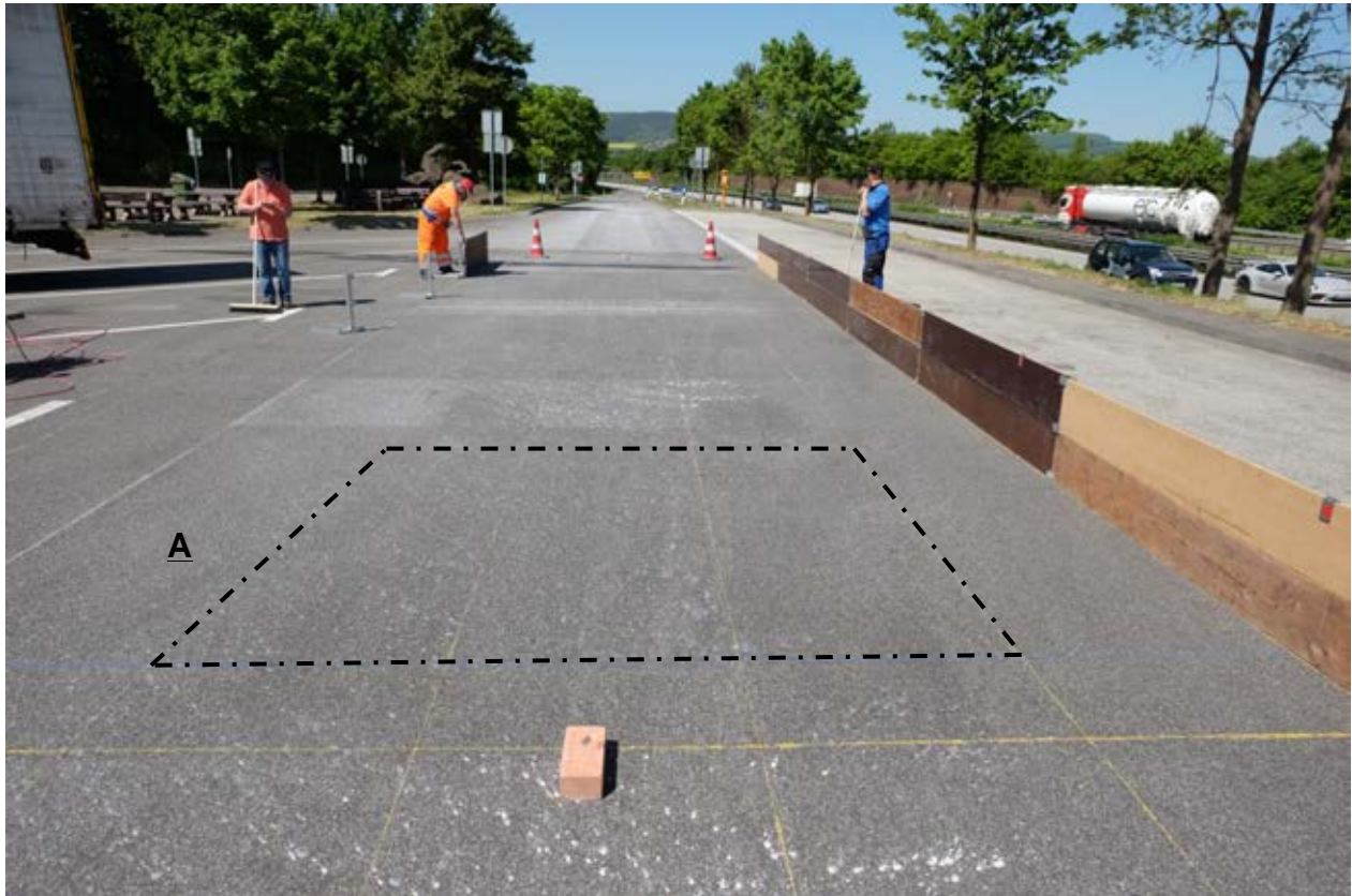
Bild 12: Blick auf Prüffeld nach Überfahrt 2; im Vordergrund ist Messfeld A zu sehen; der Klinkerstein markiert die gefahrene Mitte
