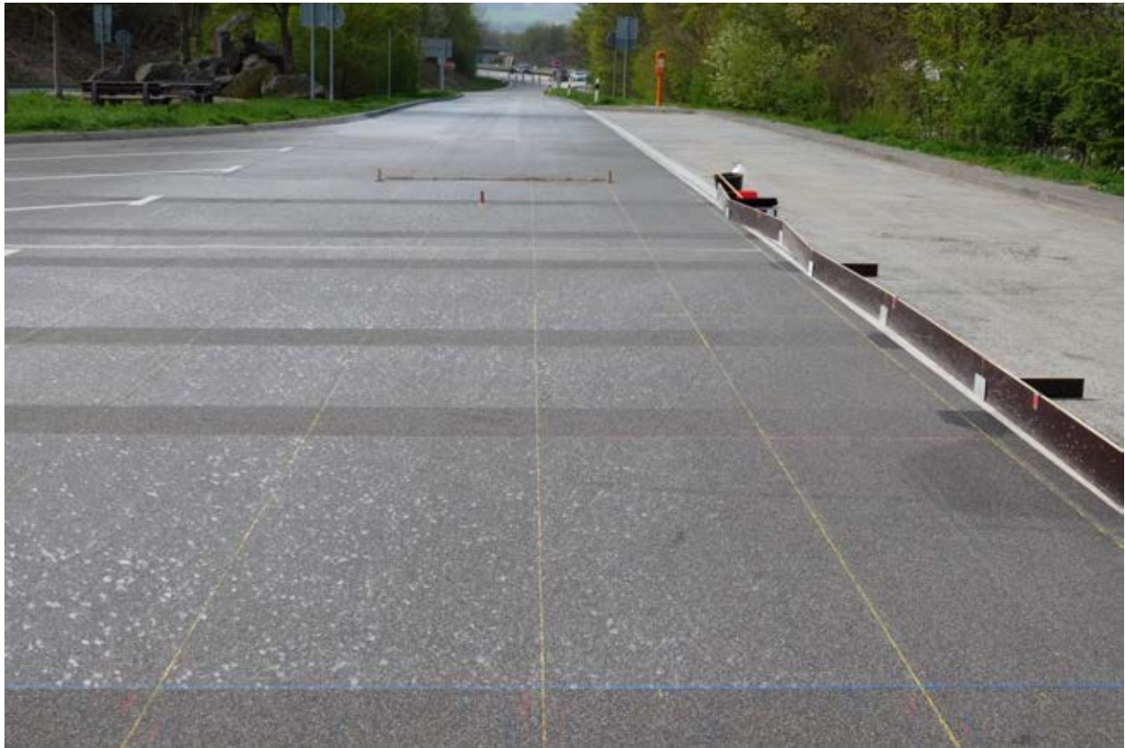
Bild 34: Blick auf die Soleverteilung des rechten Streubereiches
