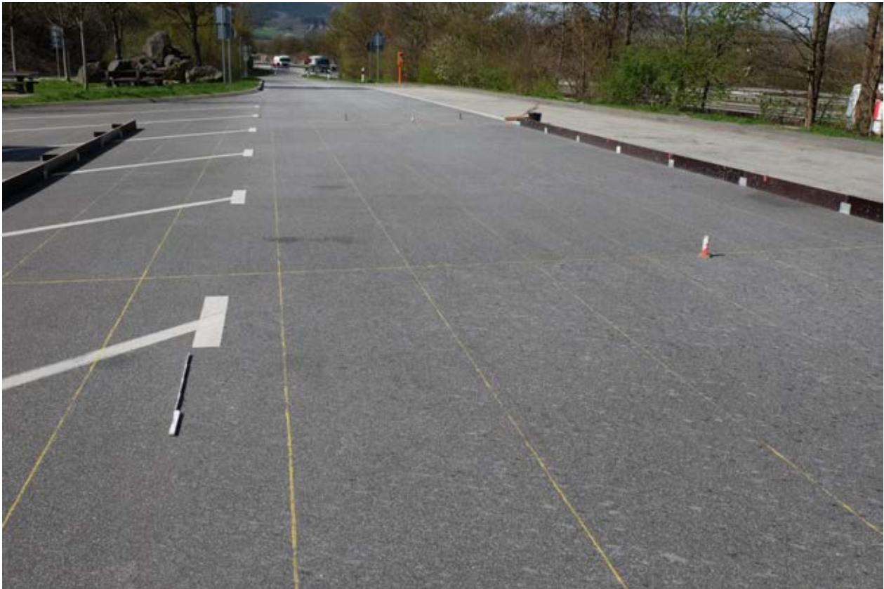
Bild 18: Blick auf das Prüffeld nach Überfahrt 2, Lage des Meters (Zollstock) markiert die linke Streuweite der Sole
