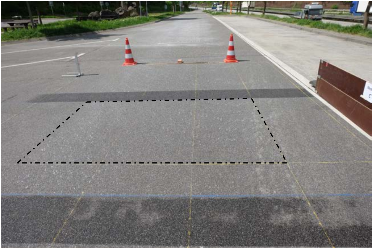
Bild 12: Blick auf Messfeld C, Überfahrt 1, extrafeines Salz
