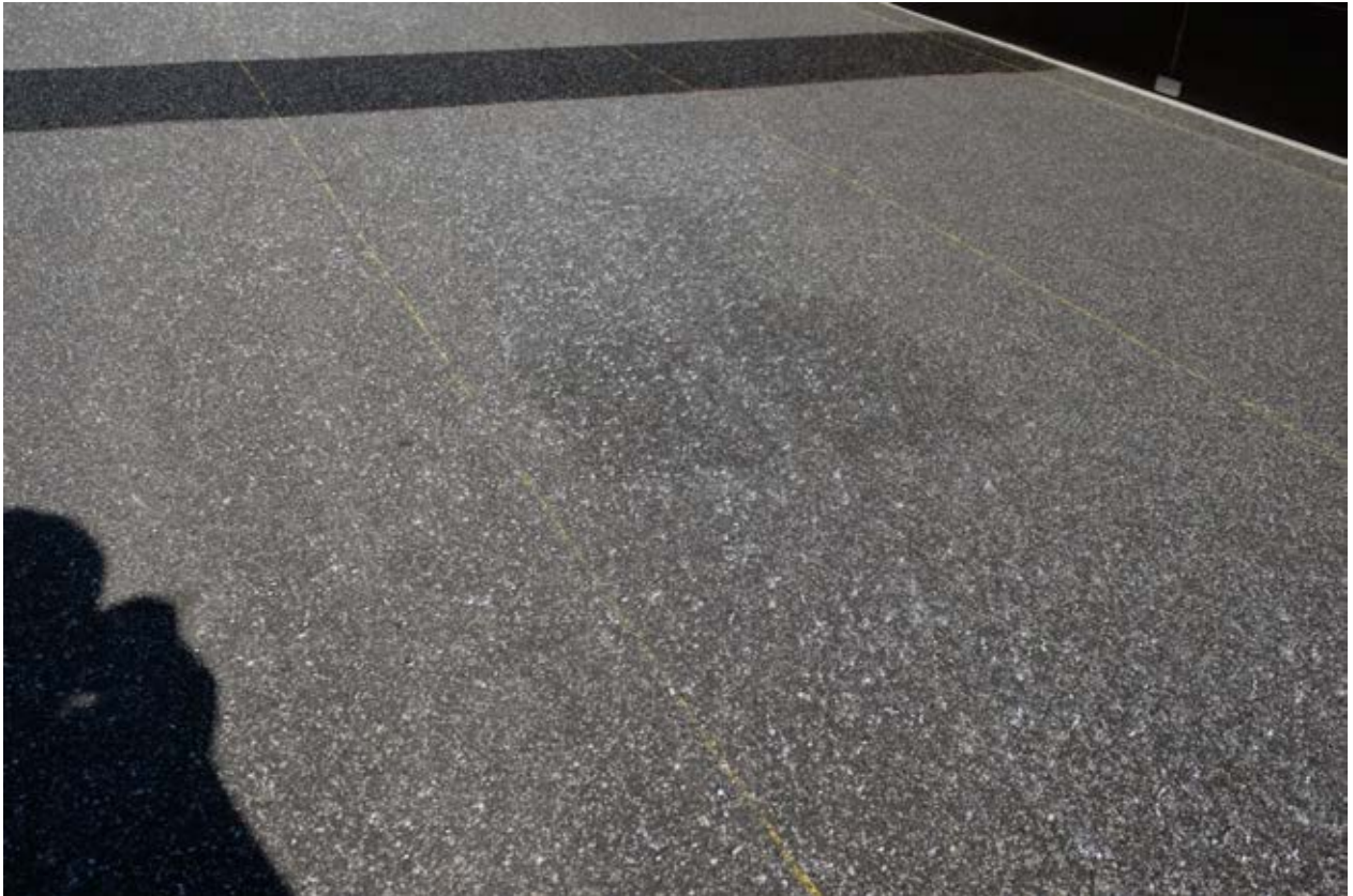
Bild 24: Intensive Soleablegung im Bereich der Streumitte
