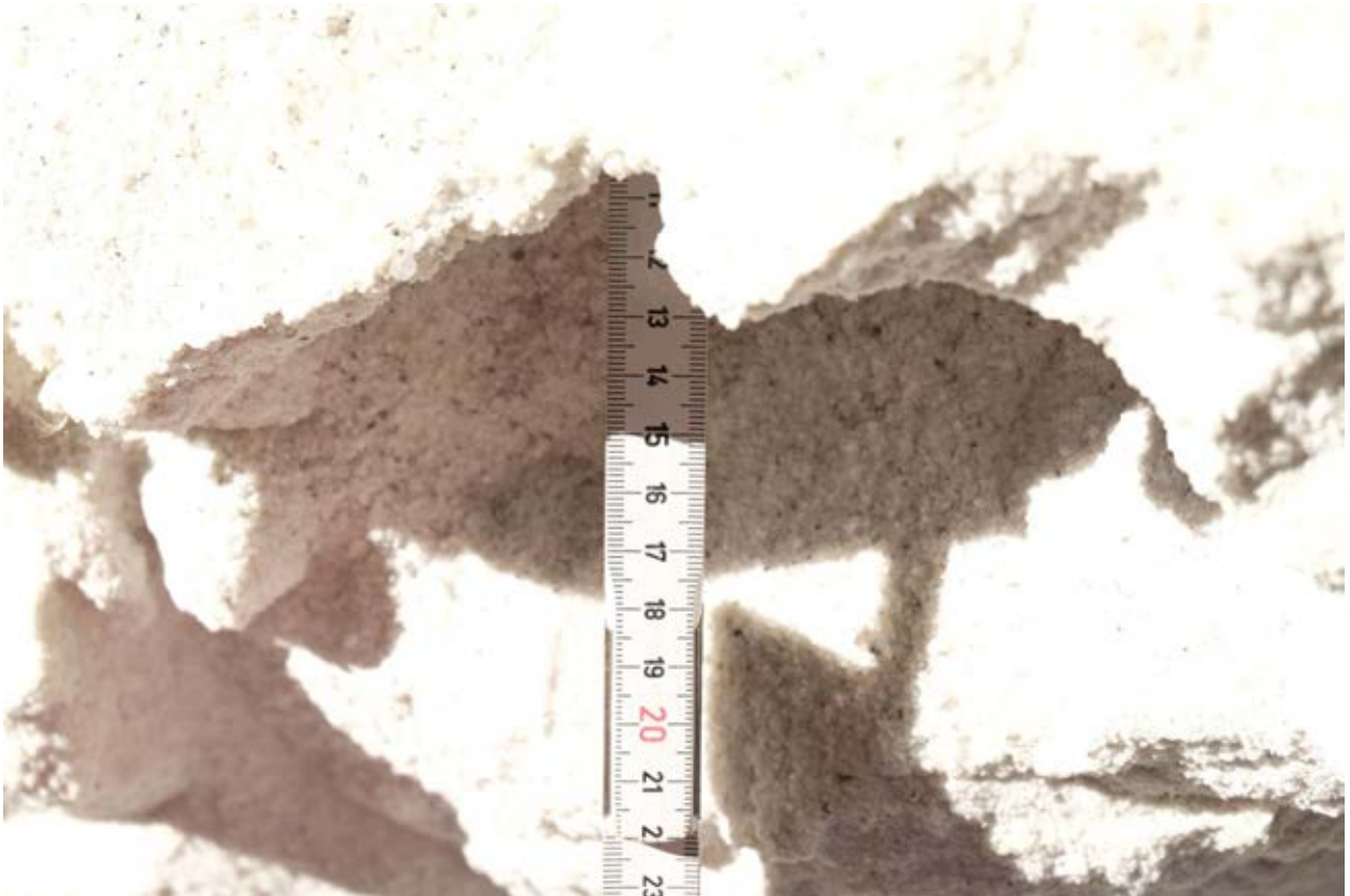
Bild 27: Darstellung der Tiefe einer Holraumbildung unterhalb der Salzkruste
