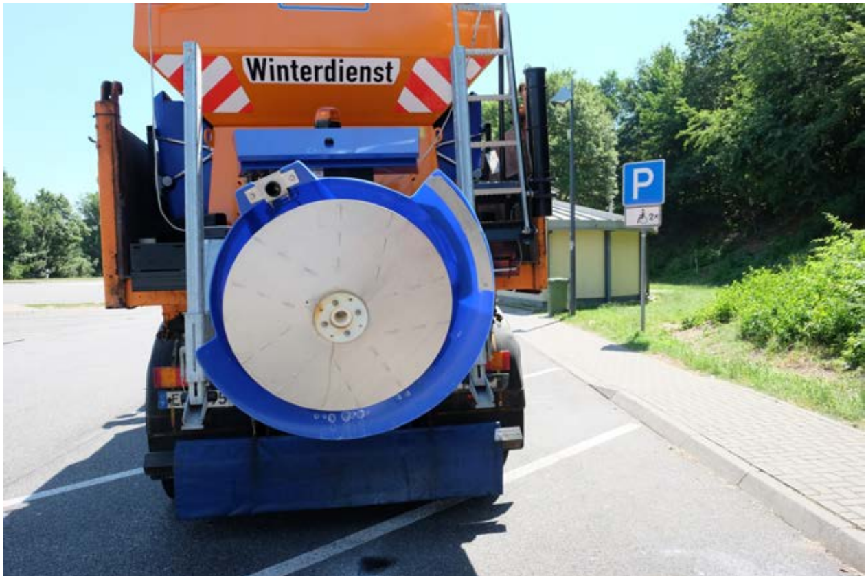
Bild 5: Blick auf die Unterseite des Streutellers
