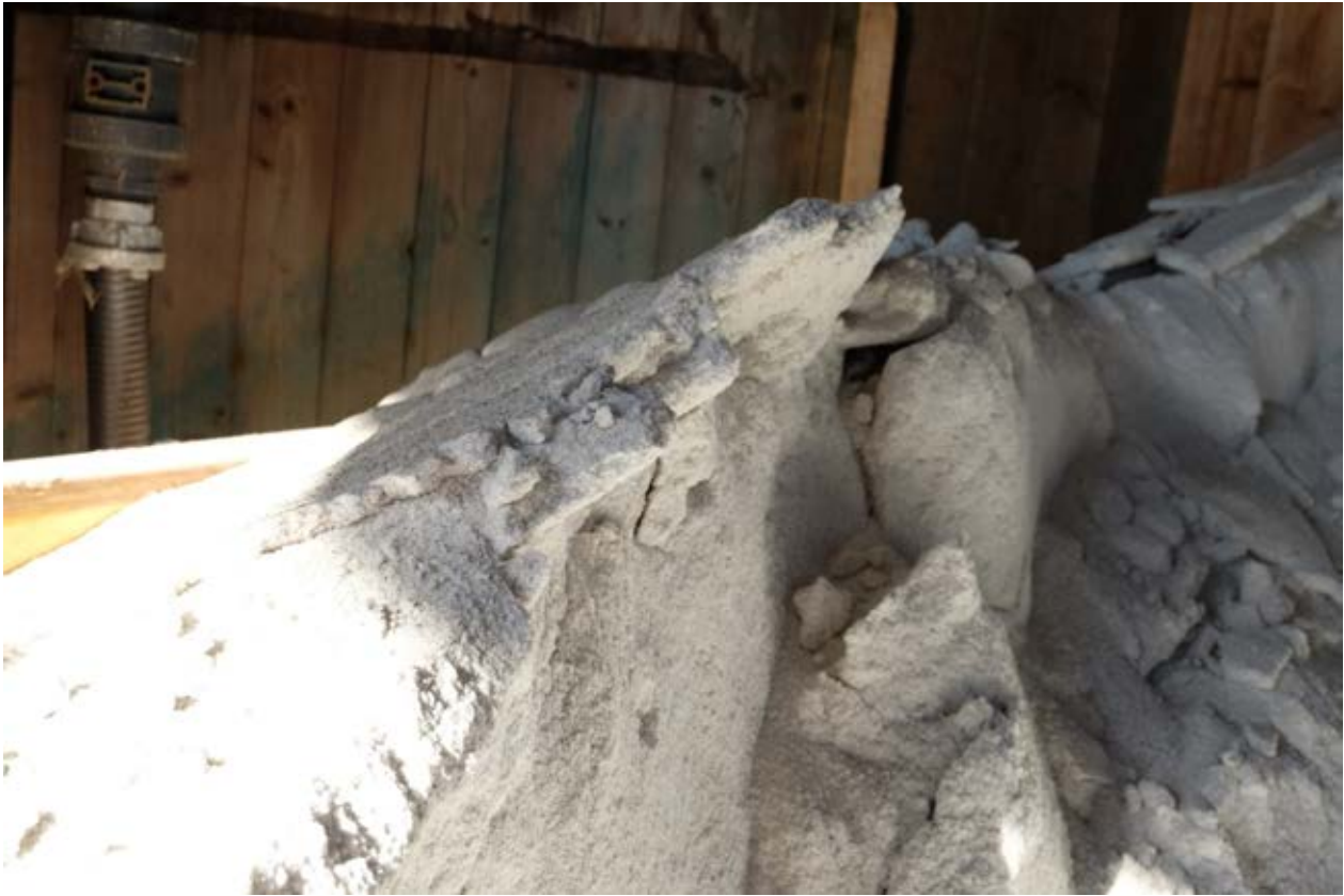
Bild 24: Brückenbildung extrafeines Salz 0-2mm, Salzhalle Mendig
