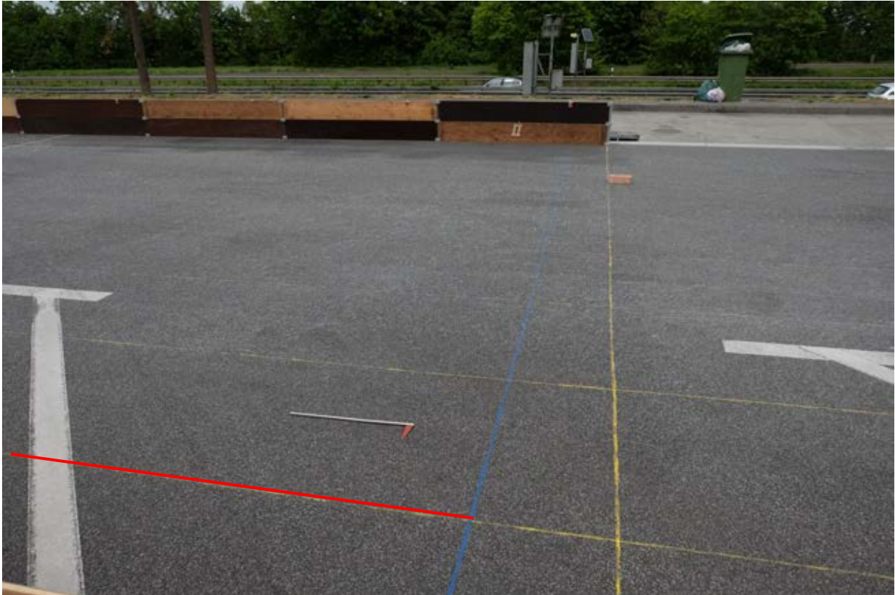
Bild 20: seitlicher Blick auf das Messfeld A; die Edelstahlstange markiert die Wurfweite der Sole nach links; die rote Linie markiert das Ende der Streubreite von 5,5m-links
