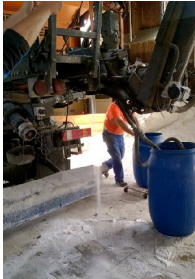
Bilder 26 und 27: Nachrieseln des Siedesalzes nach Beendigung der statischen Prüfung
