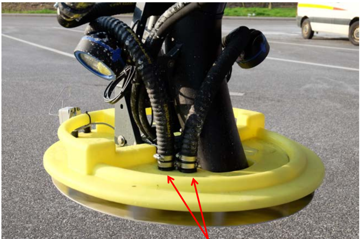
Bild 10: Zweiter Befeuchtungspunkt am Streuteller mit 2 Düsen (Solezugabepunkt 2)
