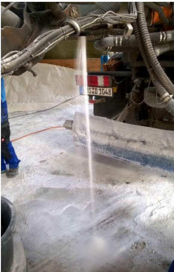
Bilder 26 und 27: Nachrieseln des Siedesalzes nach Beendigung der statischen Prüfung
