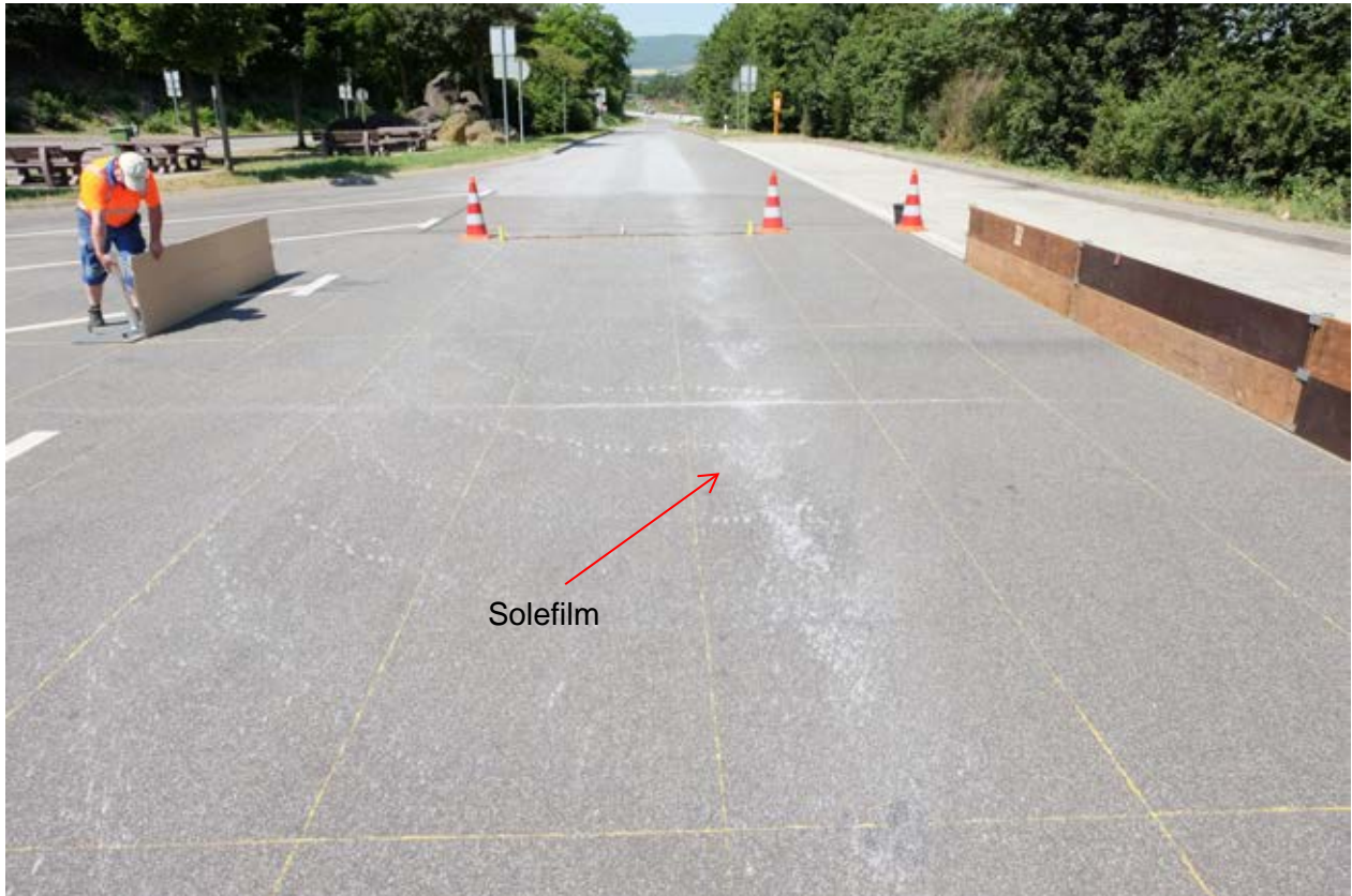
Bild 21: Blick auf Streubereich mit auffälligem Solefilm
