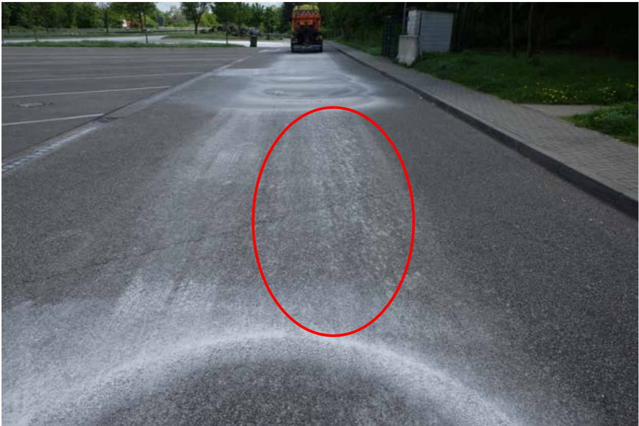
Bild 14: Blick auf die Streustoffverteilung bei Einstellung auf Steinsalz
