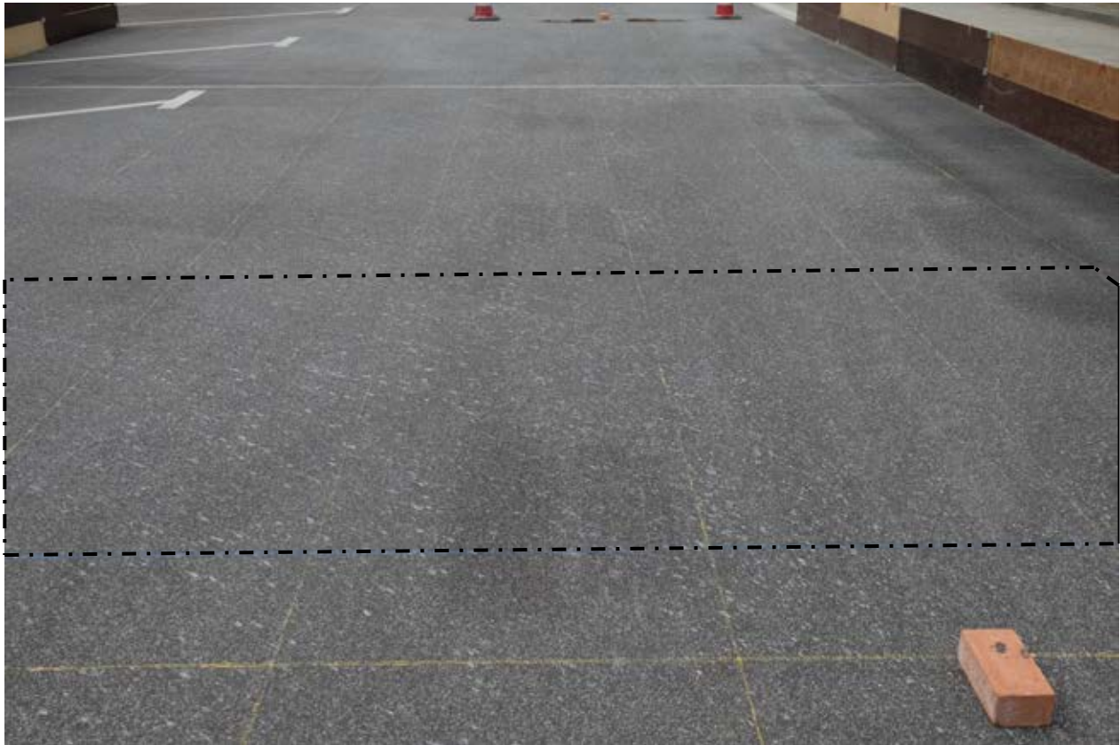
Bild 21: Blick auf das Messfeld A, Überfahrt 1 mit Blick auf die feine Streustoffverteilung;
