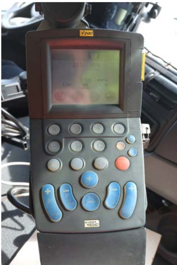
Bild 6: Bedienpult V- Pad, Software: Windows CE 2.78B
