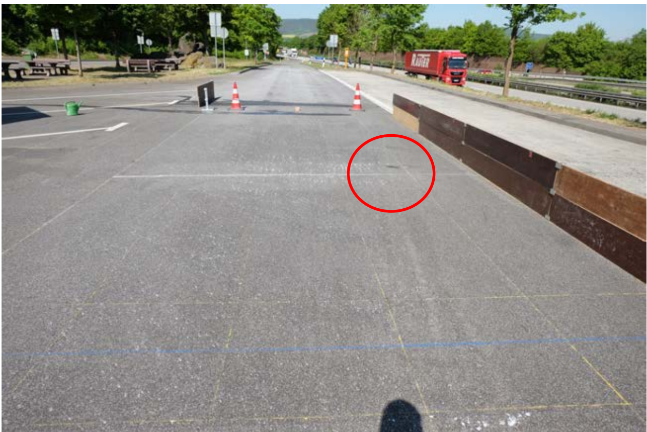
Bild 11: Blick auf zusammengefügten Salzstrang nach der Überfahrt 1; rot umrandet ist ein „Streuloch“ zu erkennen
