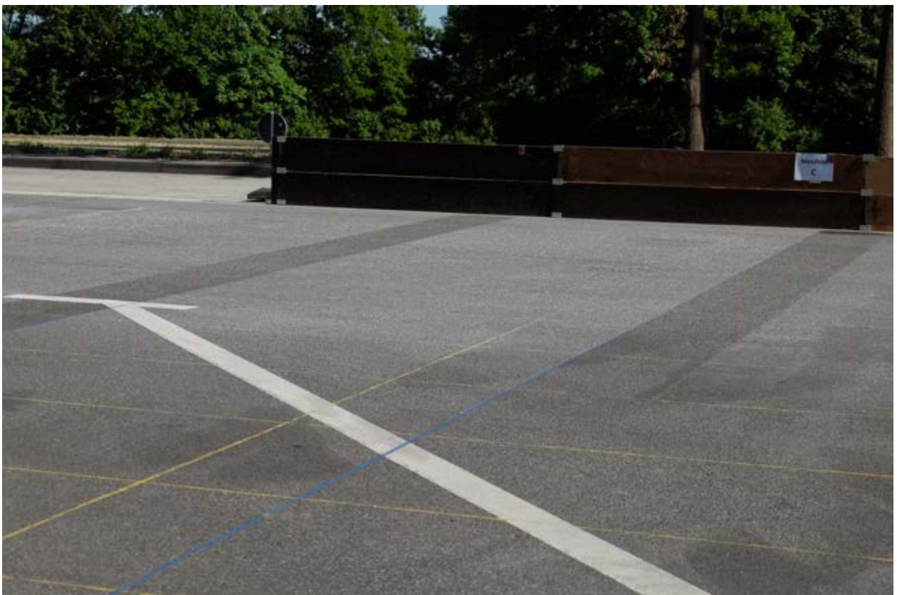
Bild 26: Blick auf Messfeld C aus der Ferne: Die abgestreute Fläche erscheint grau
