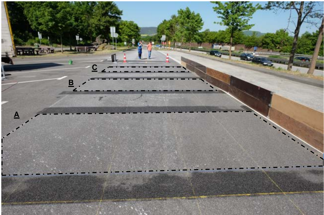
Bild 7: Blick auf das Prüffeld nach Überfahrt 1 mit den 3 Messfeldern A, B und C
