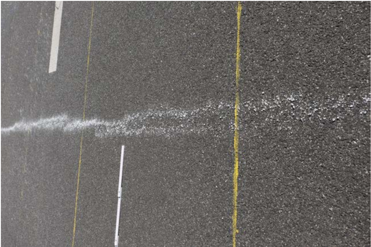
Bild 20: Entmischung des Salzes auf der rechten Seite
