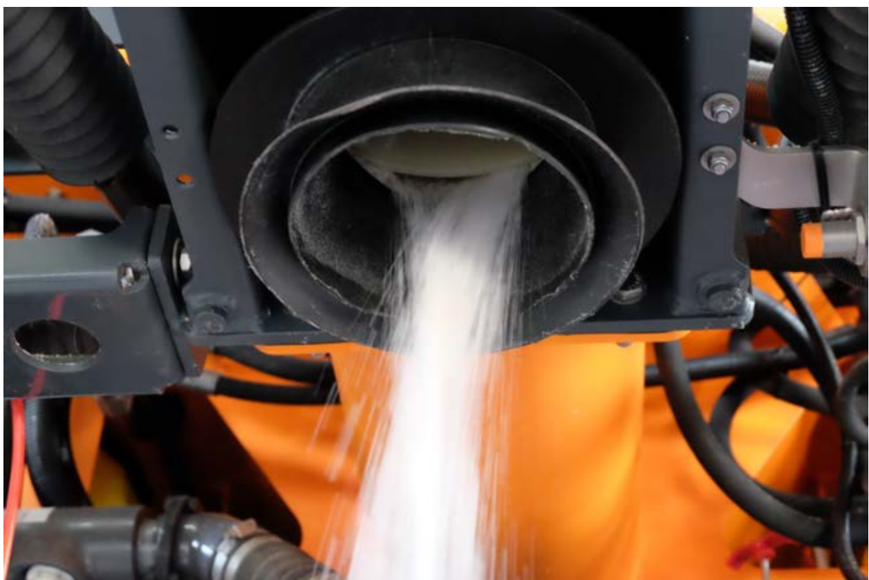
Bild 6: Blick auf das Schneckenende während der Salzförderung
