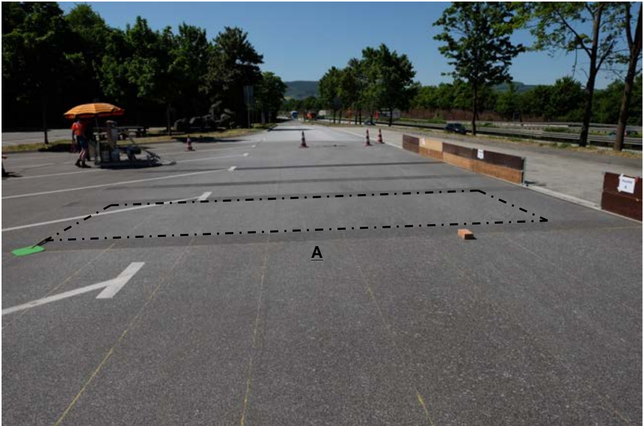
Bild 16: Blick auf das Prüffeld; im Vordergrund Messfeld A; die grüne Tafel markiert die Reichweite der Sole nach links; der Klinkerstein die gefahrene Fahrzeugmitte
