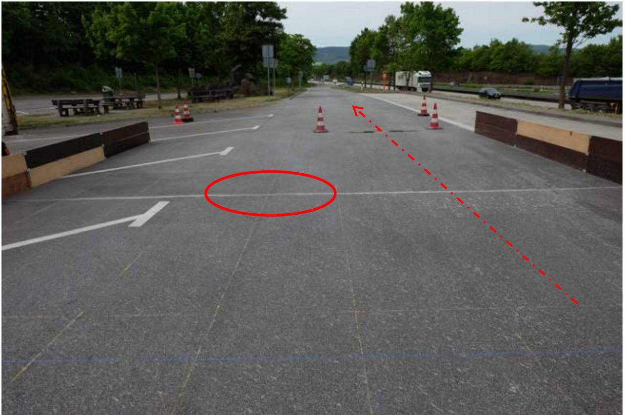
Bild 17: Blick auf das zusammengekehrte Salz nach Überfahrt 1; die rote Linie markiert die Streumitte
