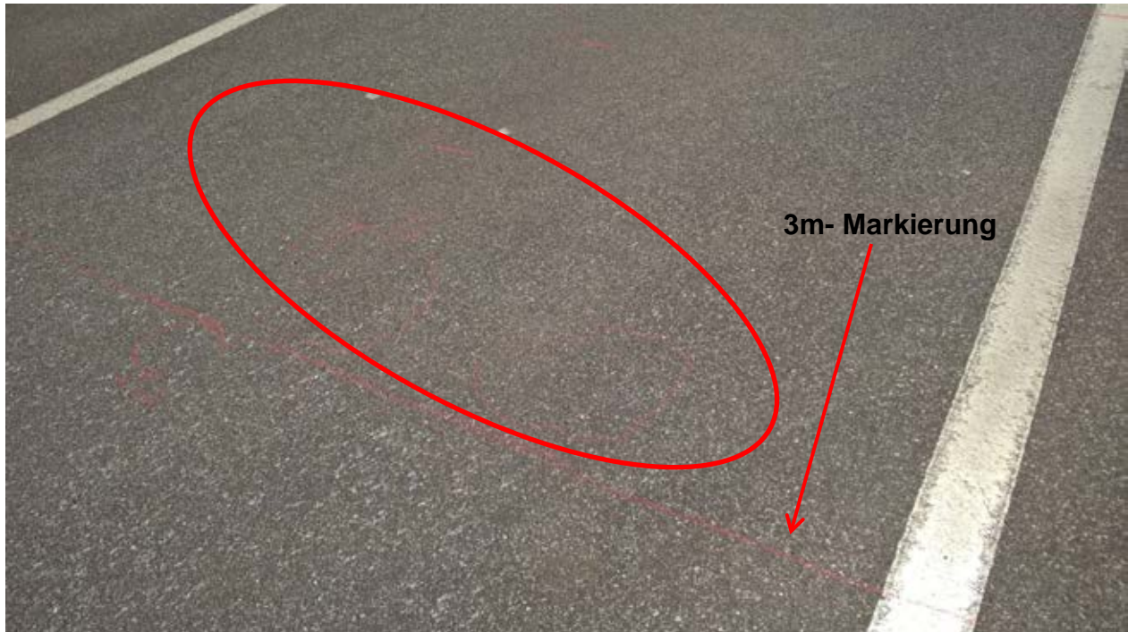
Bild 36: Getrocknete Sole unmittelbar vor der 3m- Markierung
