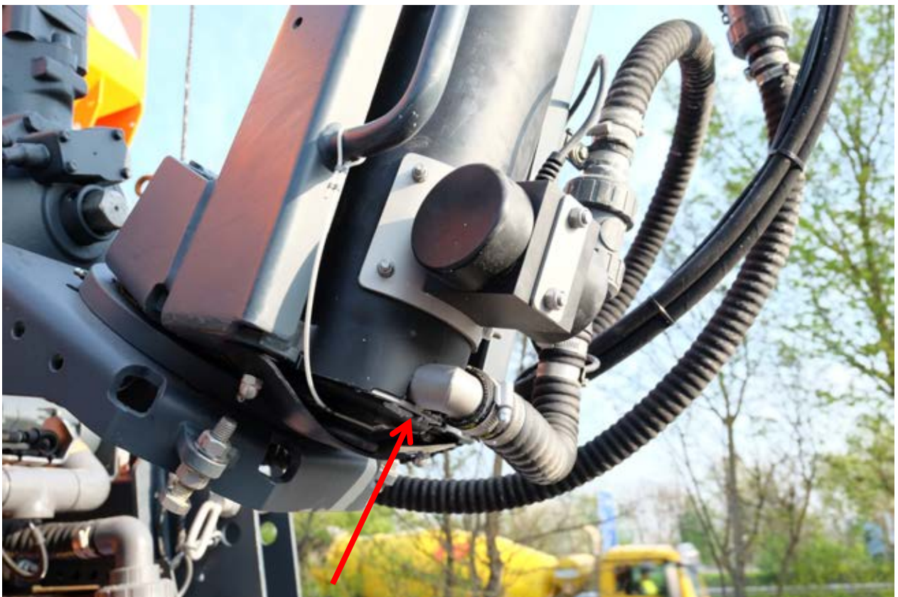
Bild 8: Blick auf den Solezugabepunkt 1 (adaptives Verfahren)
