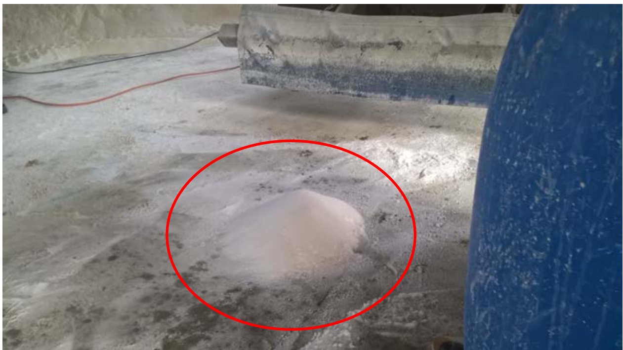
Bild 30: Salzmasse durch Nachrieseln beträgt ca. 1,4kg
