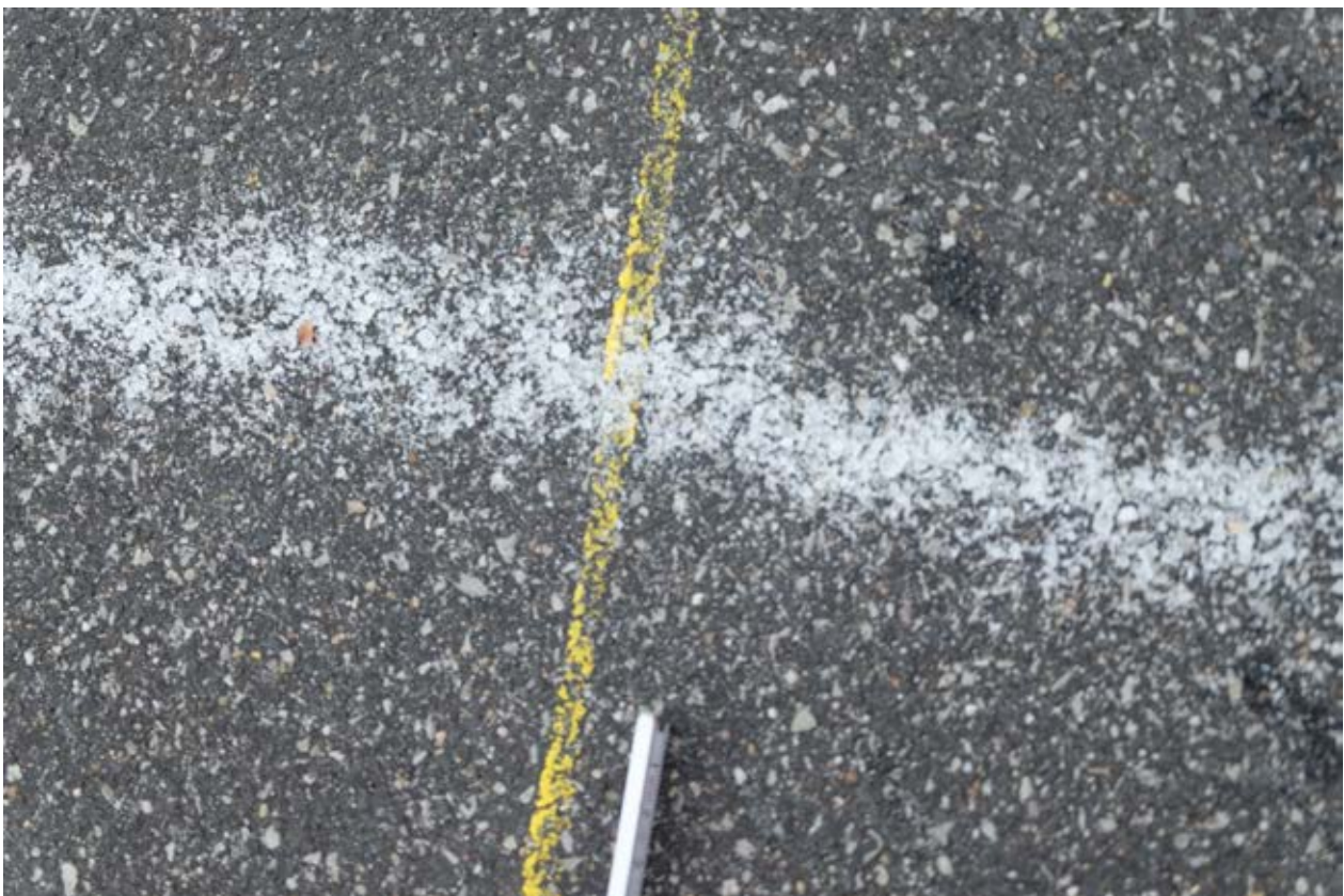
Bild 27: Grenzbereich der Sole im linken Streubreitenbereich mit Blick auf das Salz
