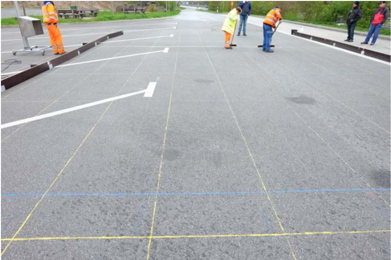
Bild 26: Detailansicht der verteilten Sole im linken Streubereich
