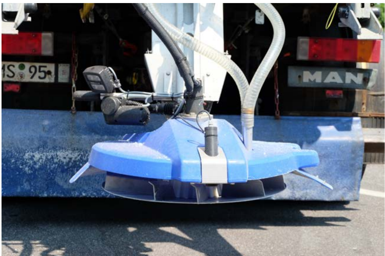
Bild 4: Detailansicht Streuteller mit Blick auf die Streuflügel und Fächer
