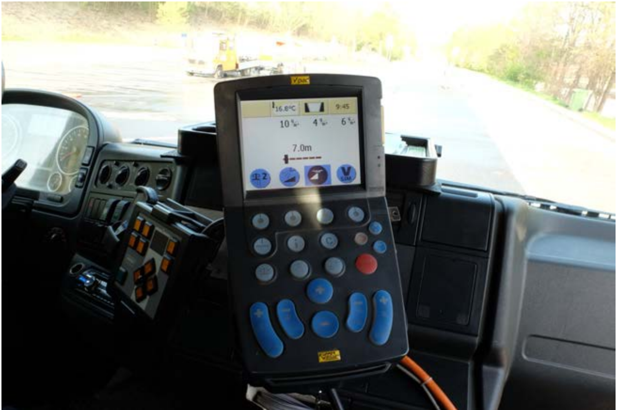
Bild 13: Bedienpult V- Pad, Software: Windows CE 2.77D
