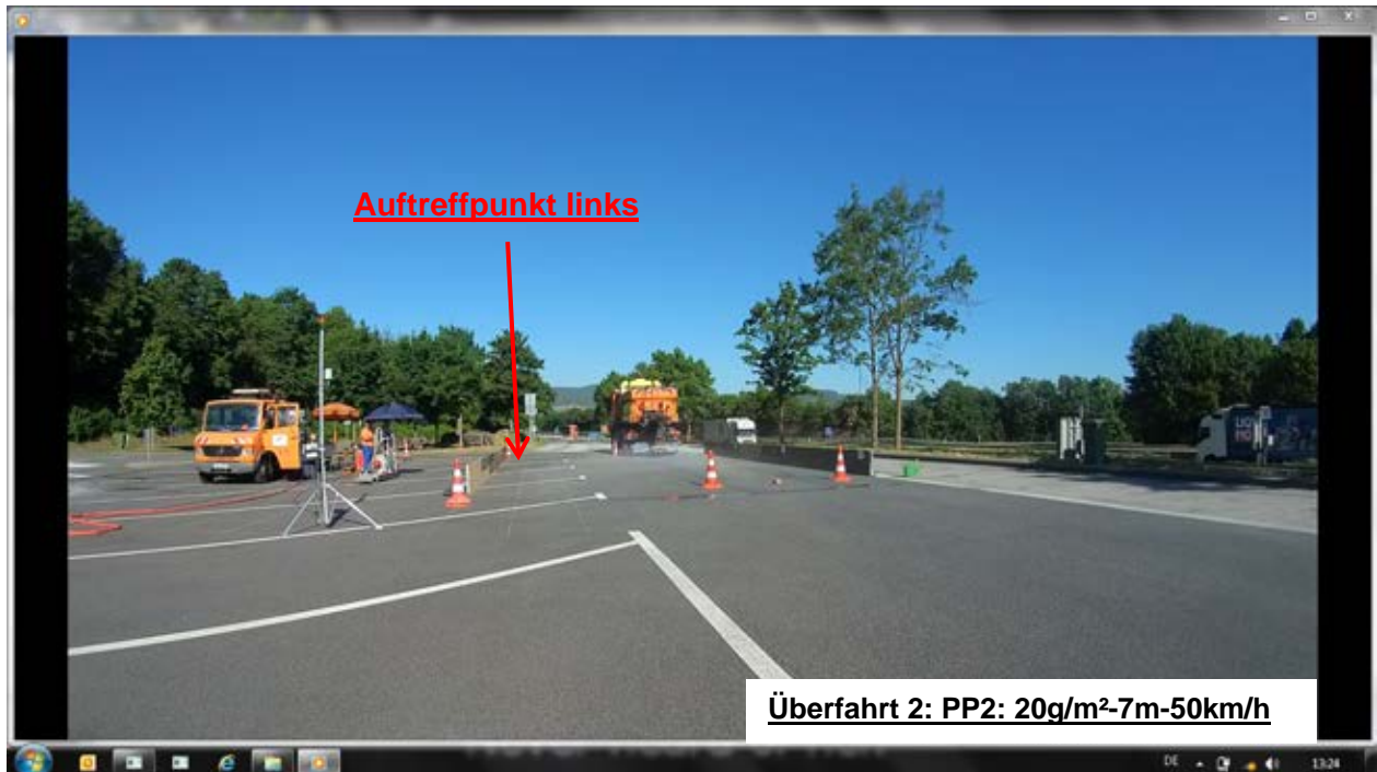
Bild 14: Streumaschinenüberfahrt 2; der Auftreffpunkt der Sole links ist mit einem roten Pfeil markiert
