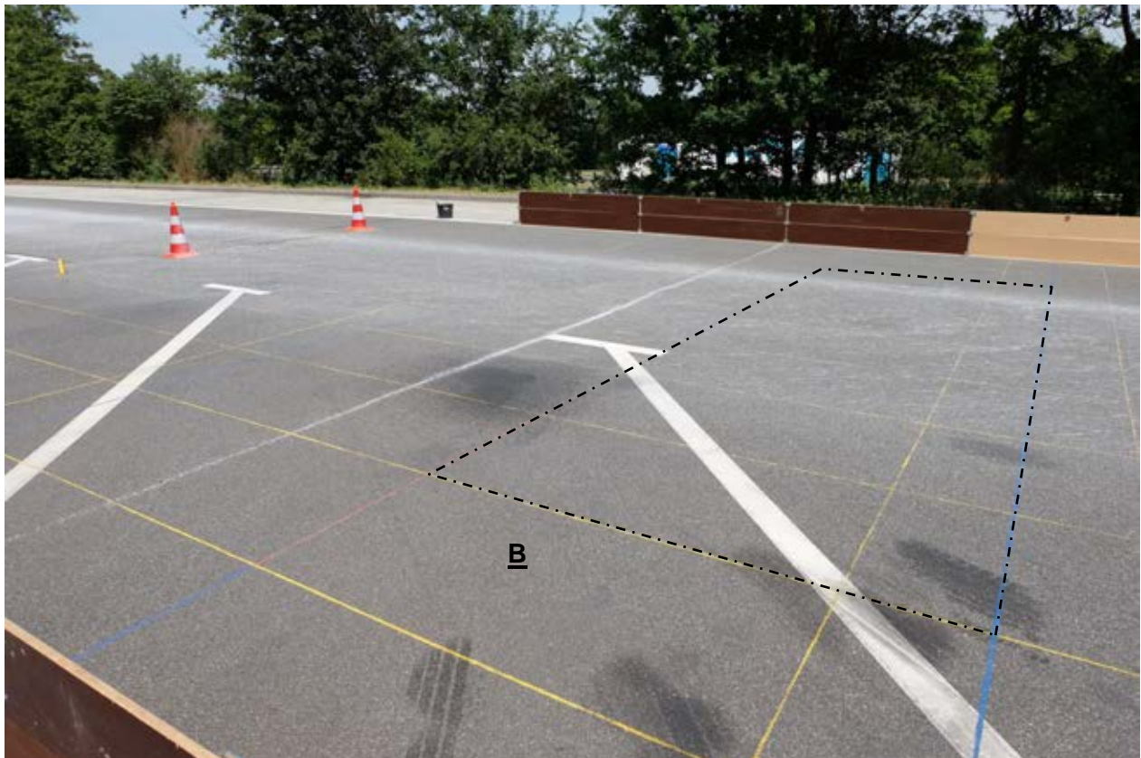
Bild 25: Blick auf das Prüffeld B, Überfahrt 1 mit Sicht auf zusammengefügten Salzstrang
