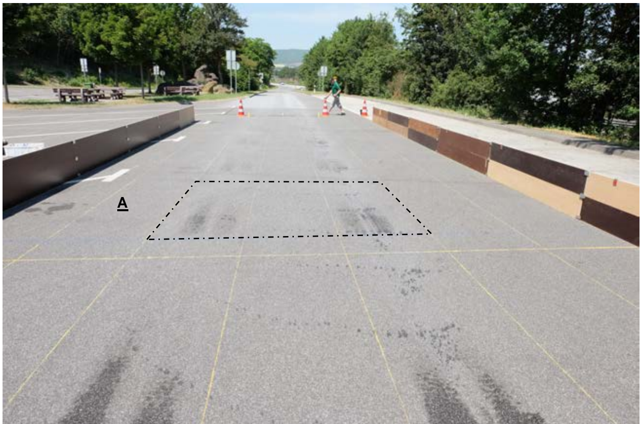
Bild 13: Blick auf das Messfeld A des Prüffeldes nach der ersten Überfahrt
