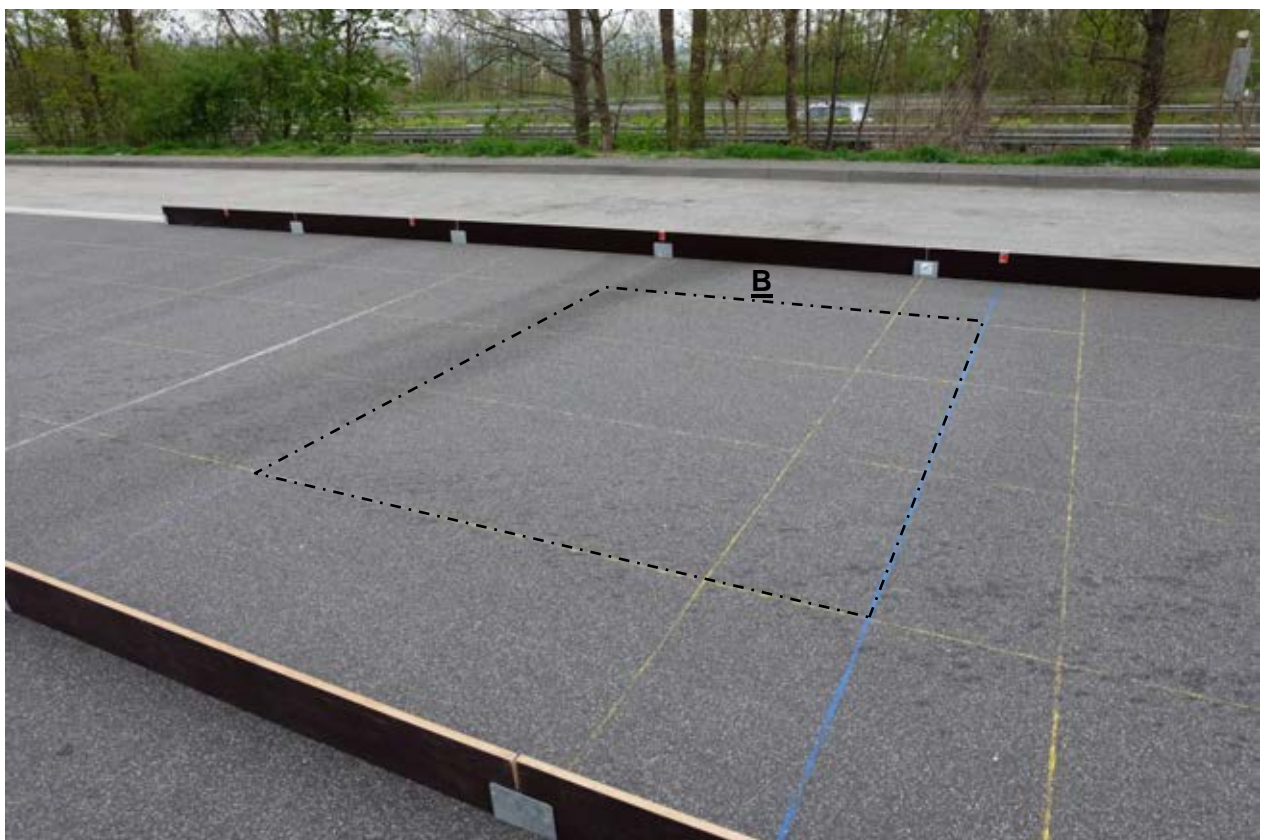
Bild 18: Blick auf Prüffeld B, Überfahrt 2 mit Reichweite der Sole
