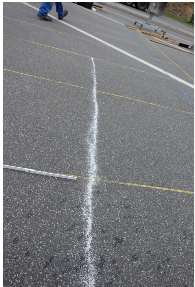
Bild 25: Linker Streubereich: Der Meterstab markiert die Reichweite der Sole
