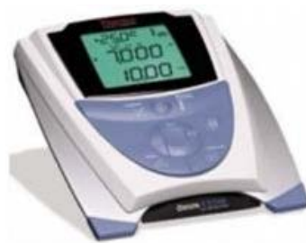
Abbildung 43: Ionenselektive Elektrode Orion 4-Star, Thermo Fisher Scientific
