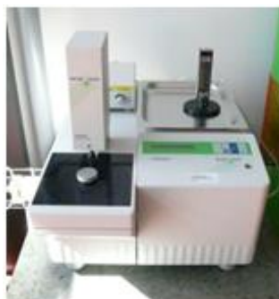
Abbildung 32: Thermogravimetrie - TG Waage
