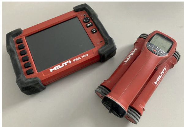
Abbildung 11: Bewehrungssuchgerät FerroScan PS 200, Hilti
