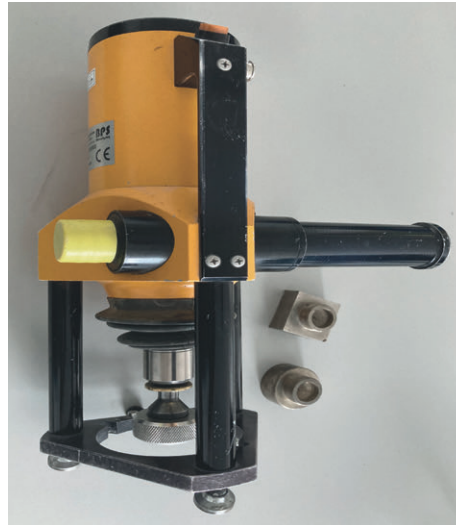
Abbildung 27: Haftzugmessgerät Easy M, BPS
