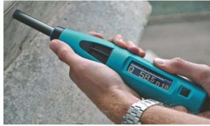
Abbildung 13: Betonrückprallhammer SilverSchmidt, Proceq
