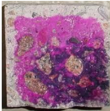
Abbildung 28: Beispiel für eine mit Phenolphthalein behandelten Probe
