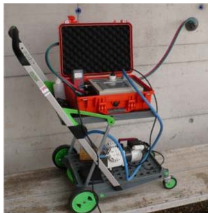
Abbildung 21: Permeabilitätsmessgerät Permea-Torr, TFB
