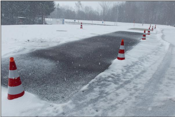
**Bild 4:** Geothermische Pilotanlage im Testbetrieb bei leichtem Schneefall im Februar 2020. Die beheizten Flächen sind deutlich zu erkennen (Quelle: BAST)
