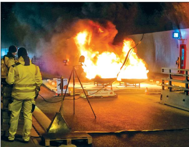
**Bild 2:** Brandversuch am Schönbuchtunnel bei Herrenberg (A 81) nach erfolgter Nachrüstung (Quelle: RP Stuttgart)
