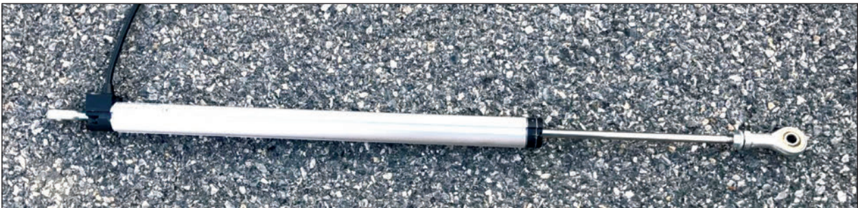
Bild 16: Wegaufnehmer 200 mm Novotechnik
