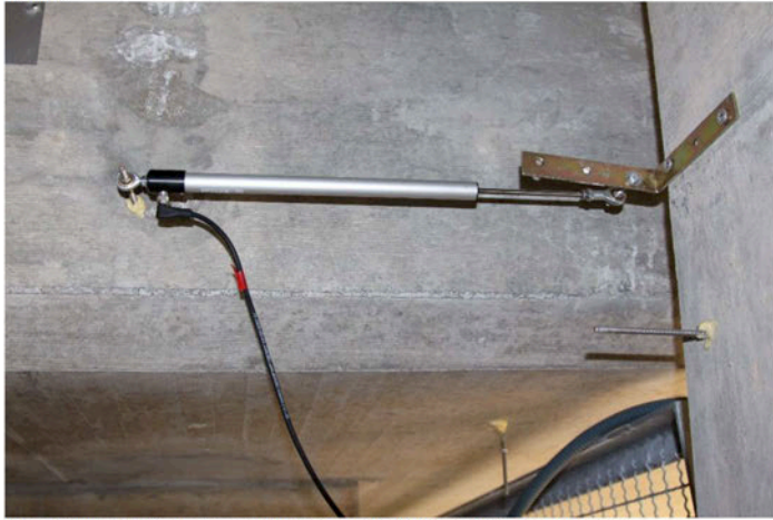
Neuer Wegaufnehmer „W längs 1.2.2“ Hangbrücke Würgau
