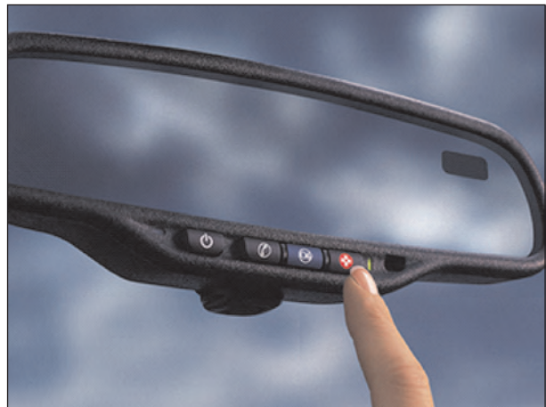
Bild 49: Kommunikations- und Sicherheitssystem von OnStar (USA) mit eCall Funktion 76
