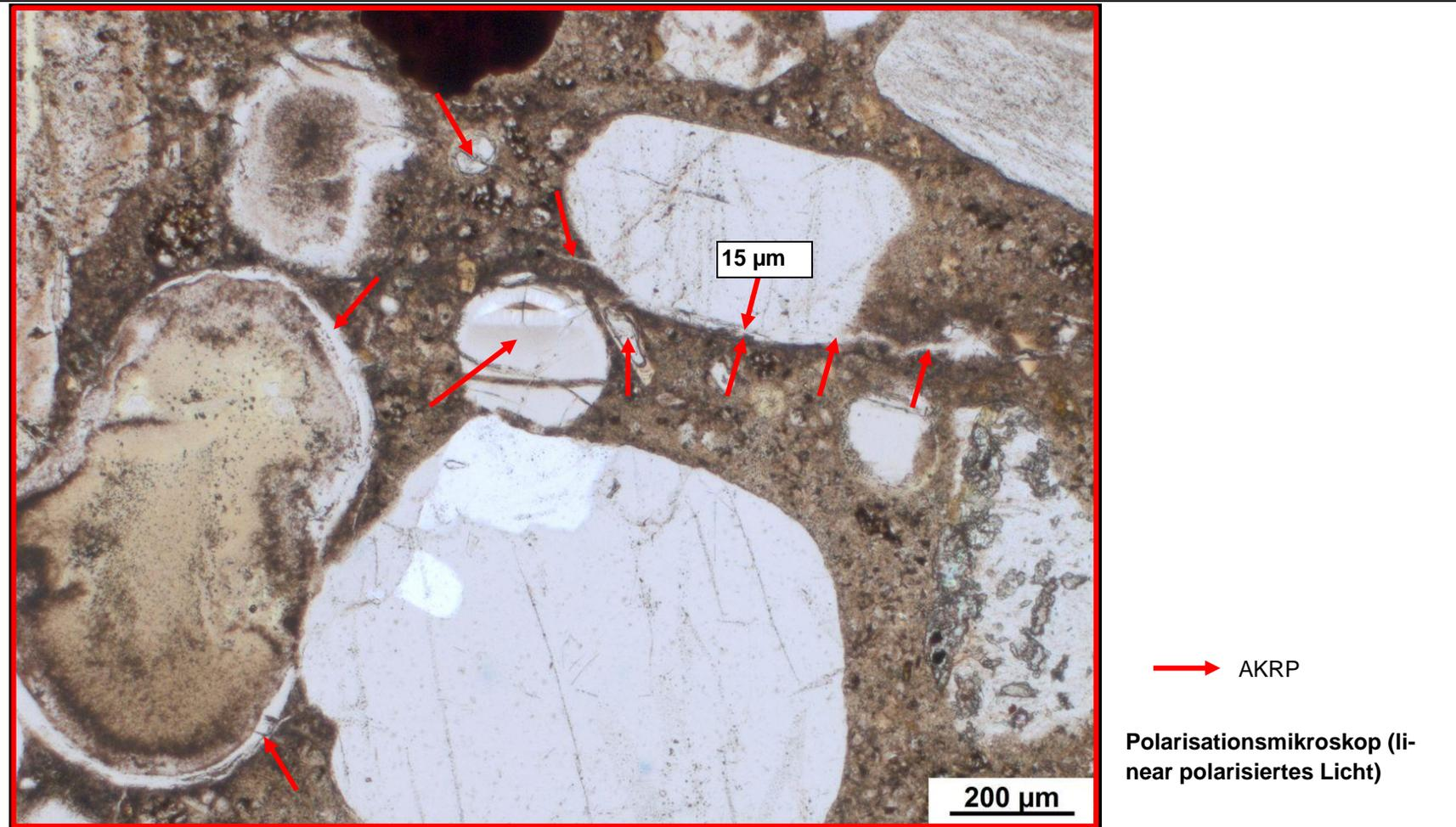
**Beschreibung:** Kompletzt mit AKRP gefüllte Poren und partiell mit AKRP gefüllte Risse, Rissweite: ca. 15 µm
