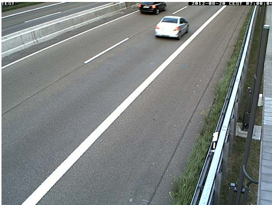
Bild 36: Aufnahme bei Tageslicht, eine Feststellung trocken oder feucht ist nicht möglich
