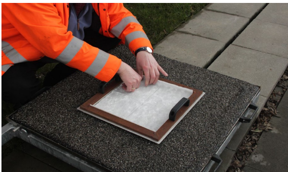
Bild 35: Durchführung eines Tuchtests (hier auf einer speziellen Prüffläche für berührungslos arbeitenden Sensoren)
