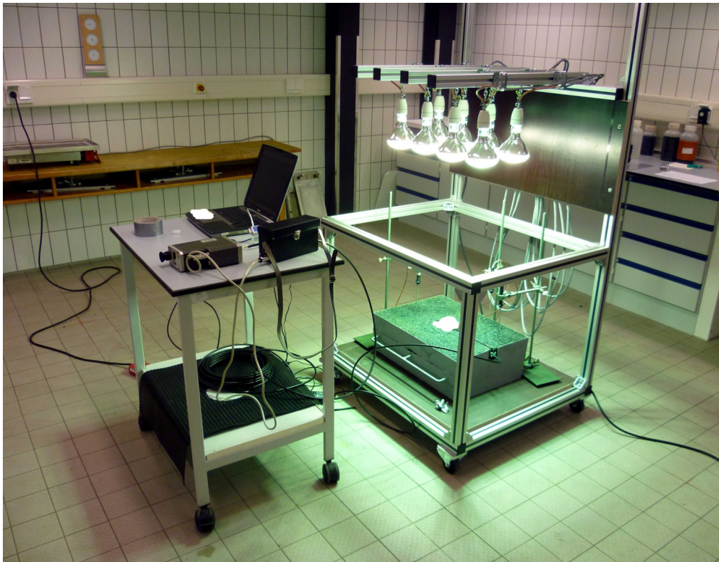
Bild 9: Versuchsaufbau in Anlehnung an die CEN/TS 15518-4 (Ausgabe 2013) für die Überprüfung der Fahrbahnoberflächentemperatur unter Strahlungseinfluss
