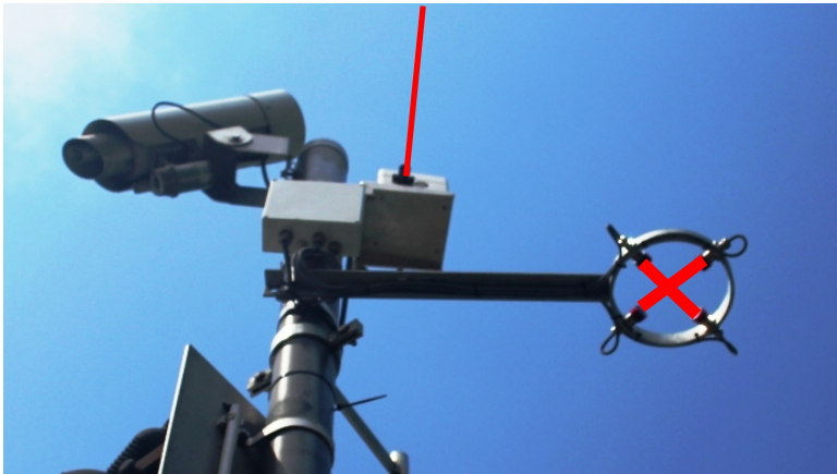
Bild 55: Niederschlagssensoren der Firma Boschung (rechts NI/SH, Mitte PWS)
