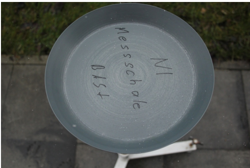
Bild 64: Auffangschale auf dem Testfeld A4 mit 400 cm 2 Auffangfläche
