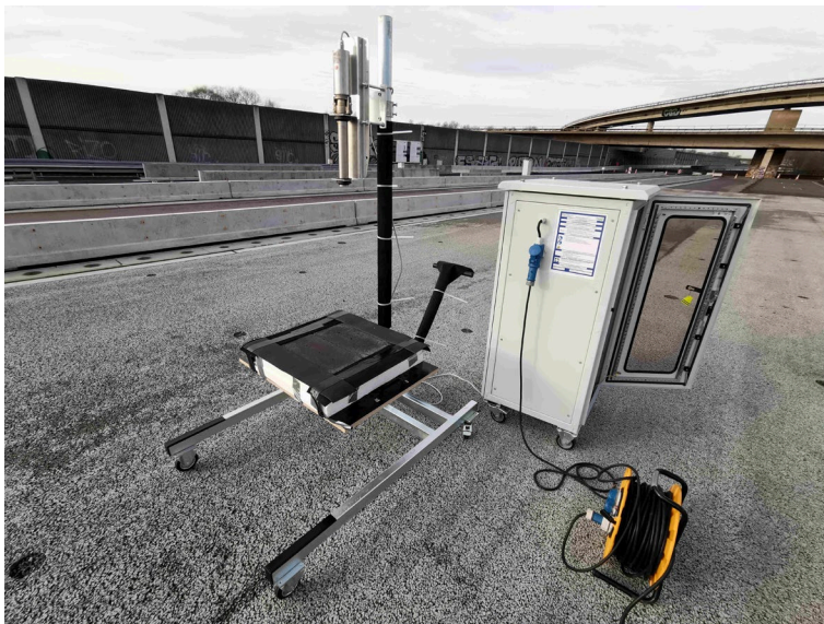
Bild 30: Versuchsstand für die Prüfung von Infrarotthermometer
