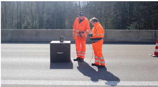
Bild 11: Messung der Fahrbahnoberflächentemperatur mit Hilfe einer Holzbox
