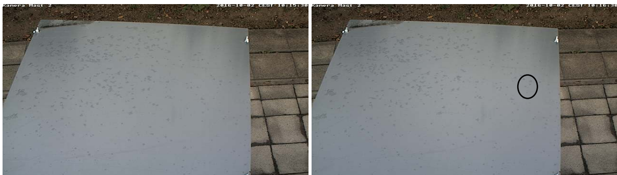
Bild 59 und Bild 60: Fotos von der Beobachtungsplatte für Niederschlag Regen im Testfeld – Kennzeichnung rechts zeigt einen Regentropfen, der im Foto eine Minute zuvor nicht vorhanden war
