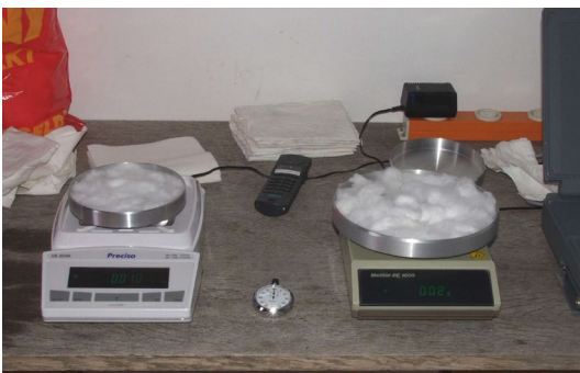
Bild 65: Messschalen mit 200 und 400 cm 2 Auffangfläche bei Wägung vor dem Sammeln von Niederschlag (Verbandswatte soll das Herausfliegen von stärkeren Regentropfen verhindern)
