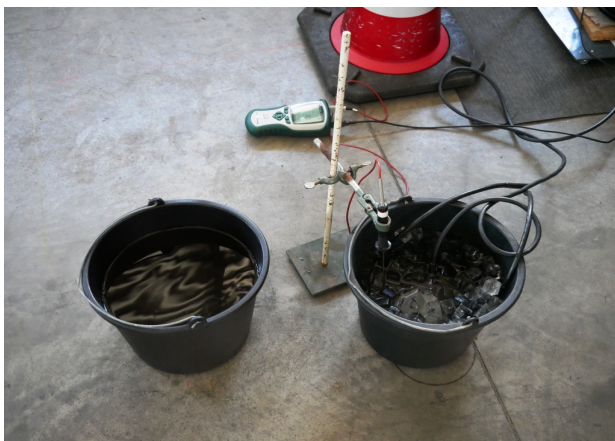
Bild 10: Möglicher einfacher Test für die Prüfung des Verhaltens von Sensor für die Fahrbahnoberflächentemperatur in Bodensonden
