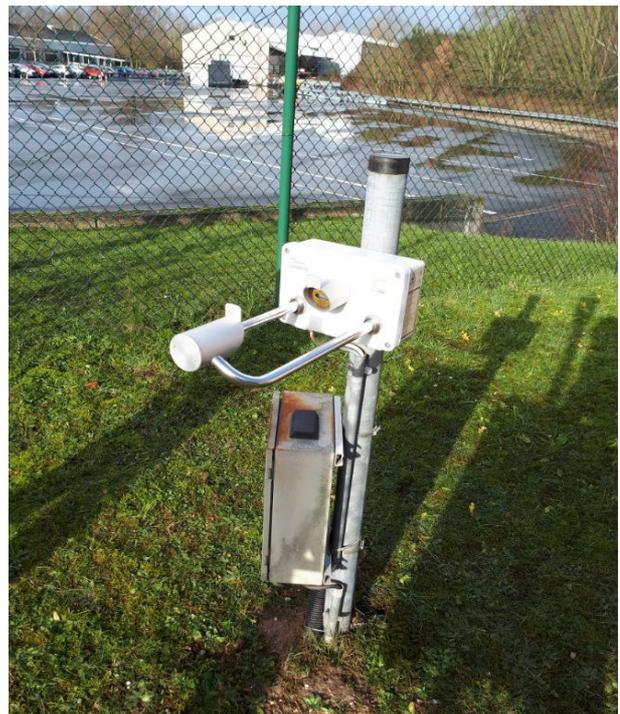
Abbildung 6: Meteorologie-Messstation auf dem rückwärtigen BAST-Parkplatz. Messparameter: p, rh, T, Nsch. Dargestellt ist hier die Nsch-Messung.
