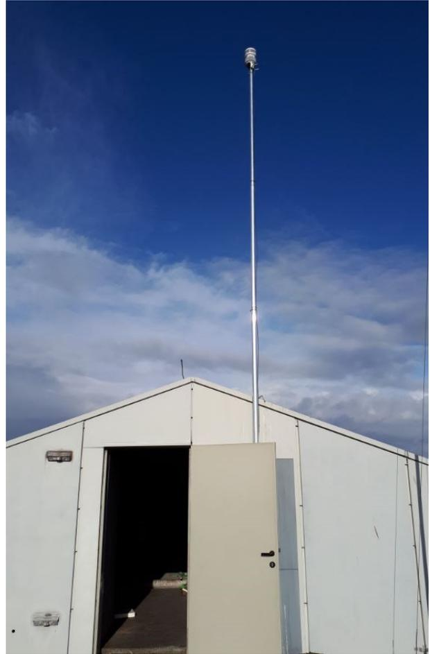
Abbildung 5: Meteorologie-Messstation auf dem Dach der BAST. Messparameter: p, rh, Strg, T, wd und vv.
