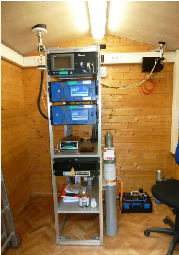
Abbildung 4: Messquerschnitt „A4\_OI\_2“ der BAB A4 in Fahrtrichtung Olpe – Innenansicht der Messhütte. Messparameter: NO<sub>x</sub>, PM<sub>x</sub>, Partikelanzahl, O<sub>3</sub>.
