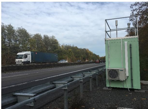
Abbildung 7: Messstation A4\_OI\_1 an der BAB A4 in Fahrtrichtung Olpe – Seitenansicht des neuen Messcontainers. Abstand zum äußeren Fahrstreifen: 5 bis 6 m.
