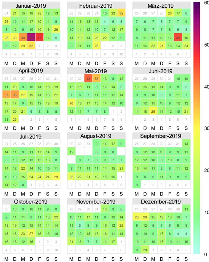
Abbildung 23: Kalenderplots mit Darstellung des Tagesmittelwertes von Partikeln PM<sub>10</sub> für das Jahr 2019 im Bereich der Messstation A4\_OI\_1 (erstellt mit R-Package: openair).
