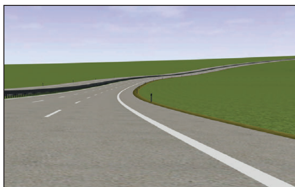
Bild 110: Aufwölbung mit den Parametern RQ 36, L_{ZG} = 200 m, \Delta s = 6 %, T = 100 m, R = + 1.000 m (nach LORENZ, 2015)
