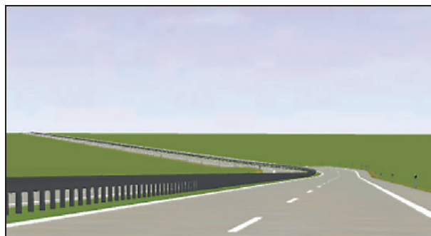
Bild 83: Linkskurve in der Wanne mit: R = 280 \text{ m} , A = 93,33 \text{ m} , RQ 25, \Delta s = 4 \% , H_W = 1.667 \text{ m} ( T = 100 \text{ m} )
