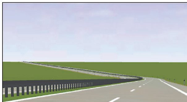
Bild 86: Linkskurve in der Wanne mit negativer Querneigung von q = -2,5 \% , R = 280 \text{ m} , A = 93,33 \text{ m} , RQ 25, \Delta s = 4 \% , H_W = 1.667 \text{ m} ( T = 100 \text{ m} )
