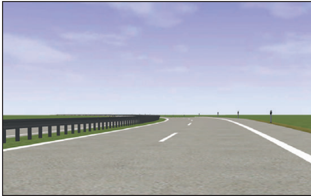
Bild 93: Kurze Zwischengerade mit Linkskurve, R = 500 m, L_R = 55 m, Länge der Zwischengerade: 100 m
