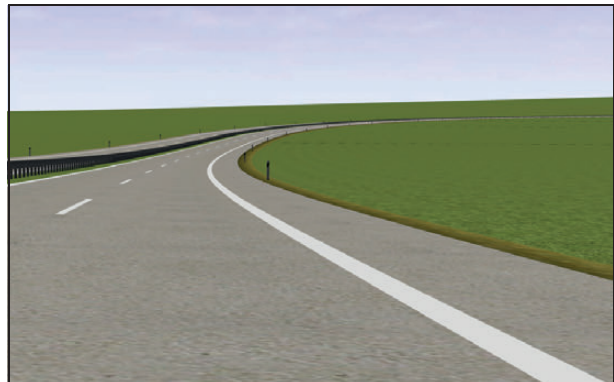
Bild 101: Aufwölbung mit den Parametern L_{ZG} = 750\text{ m} , R = +1.000\text{ m} , \Delta s = 6\% , RQ 25, T = 100\text{ m} (nach LORENZ, 2015)
