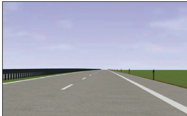
Bild 111: Abplattung mit den Parametern \Delta s = 0,5 %, RQ 25, L_{ZG} = 500 m, T = 100 m (nach LORENZ, 2015)
