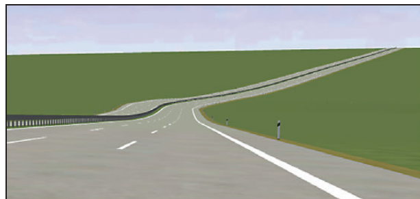
Bild 80: Rechtskurve in der Wanne mit: RQ 31,5, \Delta s = 12 \% , R = 250 m, A = 90 m, H_W = 3.333 m ( T = 200 m)
