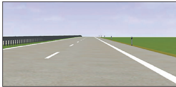
Bild 76: Kuppe mit T = 100 m und H_K = 1.667 m
