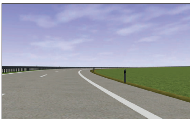
Bild 116: Abplattung mit den Parametern R = +500 \text{ m} , RQ 25, T = 75 \text{ m} , \Delta s = 1,0 \% , L_{ZG} = 250 \text{ m} (nach LORENZ, 2015)
