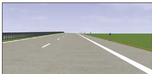
Bild 82: Rechtskurve in der Kuppe mit: \Delta s = 12 \% , H_K = 1.666,67 m ( T = 100 m), R = 280 m, A = 93,33 m
