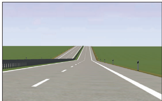
Bild 119: Verzerrung der Längsneigung mit RQ 25, H_W = 1.000 m und \Delta s = 4 %
