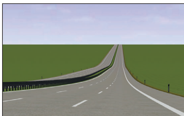
Bild 108: Aufwölbung mit den Parametern RQ 36, L_{ZG} = 200 m, \Delta s = 6 %, T = 100 m (nach LORENZ, 2015)
