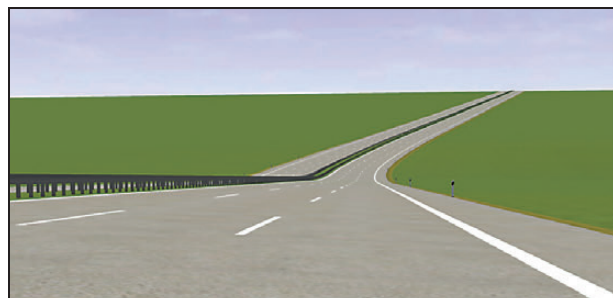
Bild 81: Rechtskurve in der Wanne mit: RQ 36, \Delta s = 12 \% , R = 720 m, A = 240 m, L = 75 m, H_W = 8.800 m ( T = 352 m)
