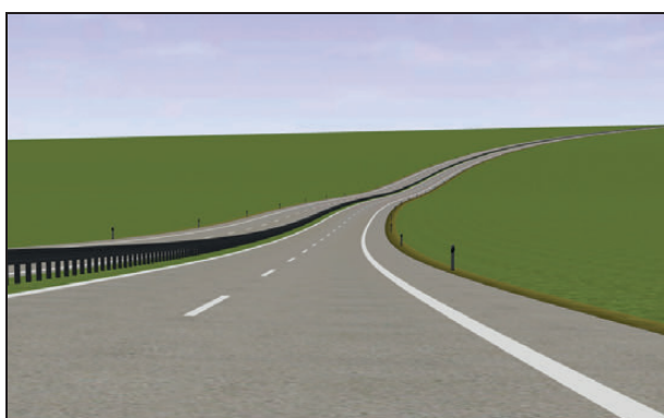
Bild 105: Aufwölbung mit den Parametern L_{ZG} = 200 m, R = + 3.000 m, \Delta s = 6 %, RQ 25, T = 100 m (nach LORENZ, 2015)
