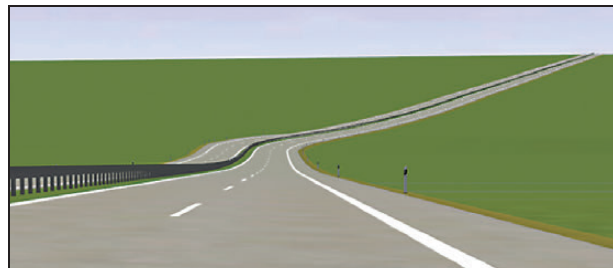
Bild 79: Rechtskurve in der Wanne mit: RQ 25, \Delta s = 12 \% , R = 250 m, A = 90 m, H_W = 3.333 m ( T = 200 m)
