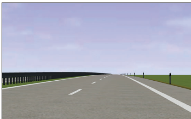
Bild 115: Abplattung mit den Parametern T = 125 \text{ m} , \Delta s = 1,0 \% , RQ 25, L_{ZG} = 400 \text{ m} (nach LORENZ, 2015)
