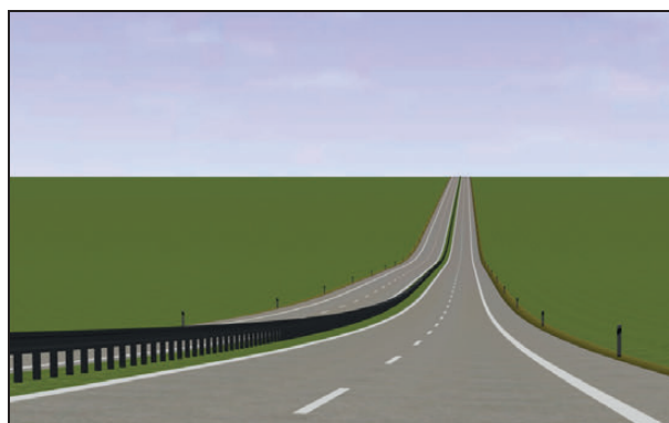
Bild 107: Aufwölbung mit den Parametern RQ 25, L_{ZG} = 200 m, \Delta s = 6 %, T = 100 m (nach LORENZ, 2015)
