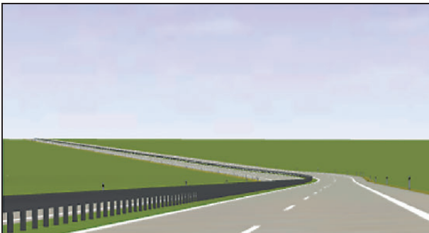
Bild 88: Linkskurve in der Wanne mit einseitiger Querneigung von q = 6,0 \% , R = 280 \text{ m} , A = 93,33 \text{ m} , RQ 25 , \Delta s = 4 \% , H_W = 1.667 \text{ m} ( T = 100 \text{ m} )
