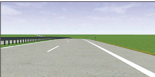
Bild 75: Rechtskurve mit RQ 36, R = 720 m, A = 240 m und L = 75 m
