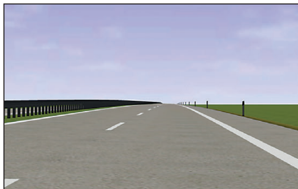
Bild 117: Abplattung mit den Parametern R = \infty , RQ 25, T = 75 \text{ m} , \Delta s = 1,0 \% , L_{ZG} = 250 \text{ m} (nach LORENZ, 2015)
