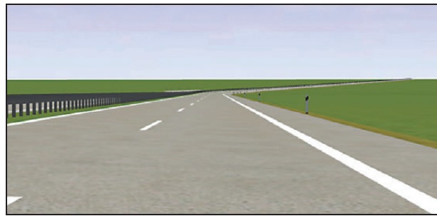
Bild 78: Rechtskurve in der Wanne mit: \Delta s = 2 \% , H_W = 10.000 m ( T = 100 m), R = 280 m, A = 93,33 m
