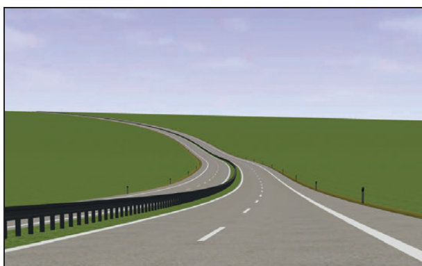
Bild 106: Aufwölbung mit den Parametern L_{ZG} = 200 m, R = - 3.000 m, \Delta s = 6 %, RQ 25, T = 100 m (nach LORENZ, 2015)
