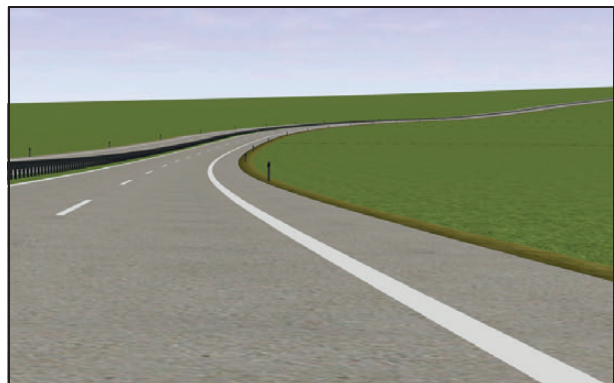
Bild 100: Aufwölbung mit den Parametern L_{ZG} = 400\text{ m} , R = +1.000\text{ m} , \Delta s = 6\% , RQ 25, T = 100\text{ m} (nach LORENZ, 2015)
