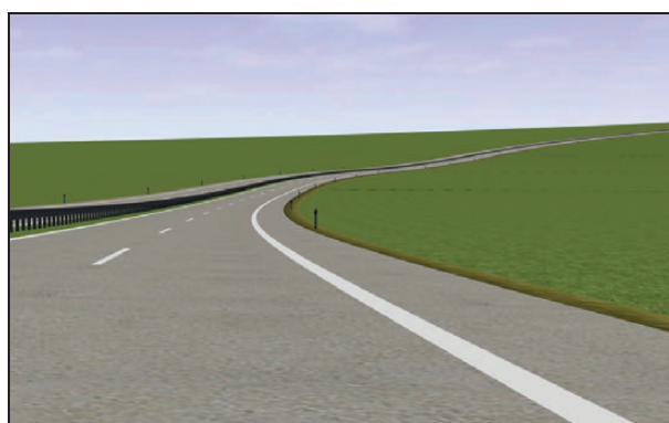
Bild 109: Aufwölbung mit den Parametern RQ 25, L_{ZG} = 200 m, \Delta s = 6 %, T = 100 m, R = + 1.000 m (nach LORENZ, 2015)
