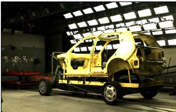
Bild 105: Golf IV-Karosze auf dem Versuchsschlitten
