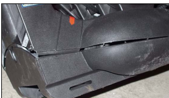
Bild 121: Aufgeplatzter Unterbau bei HighSpeed-Test (KSS M)
