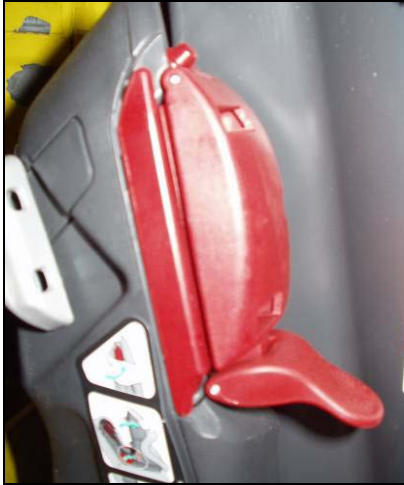
Bild 89: Gurtklemmer direkt am KSS befestigt
