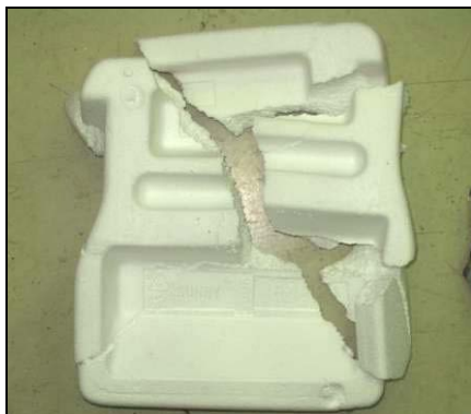
Bild 117: Zerbrochene Sitzerrhöhung K bei ECE-R44
