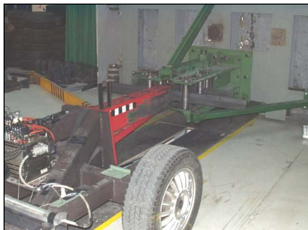
Bild 103: Verzögerungseinrichtung für Schlittentests
