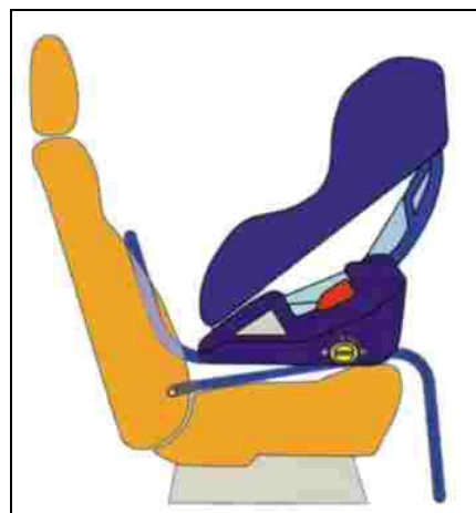
Bild 85: ISOFIX-KSS mit Grundgestell und Stützfuß [WAVO, 2005]
