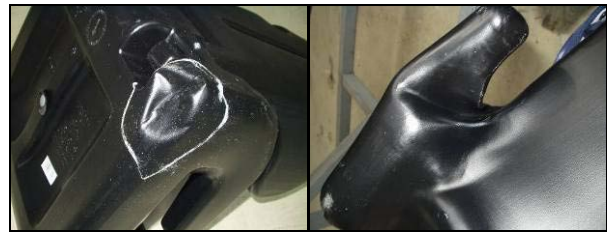
Bild 118: Eingedrückter Unterbau und abgeknickte Gurtführung bei HighSpeed (KSS O links, KSS N rechts)
