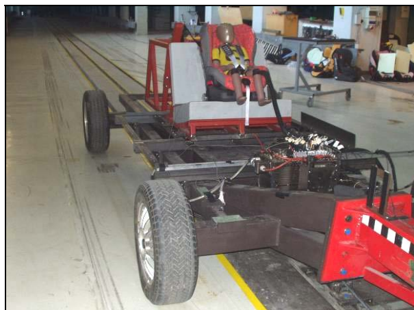
Bild 101: ECE-Bank auf Versuchsschlitten
