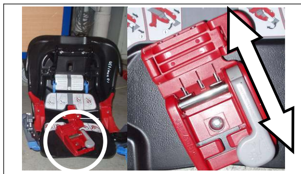
Bild 88: Per Hand zu bedienendes Spannsystem in Sitzbasis (links), Detailaufnahme (rechts)
