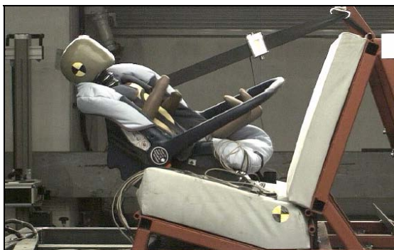
Bild 138: Q1,5 im KSS C bei maximaler Vorverlagerung
