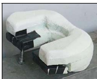
Bild 143: Kopf-Hals-Stütze aus Polystyrol [SCHULTZ, 2006]
