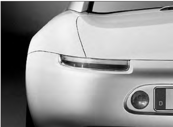
Bild 4: Niederdruck-Gasentladungslampe im Modell Z8 des Fahrzeugherstellers BMW; Quelle: [IQ09]
