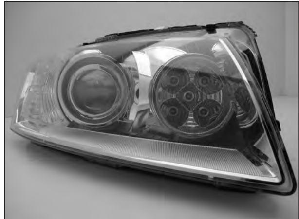
Bild 28: Scheinwerfer mit integrierter LED-Tagfahrleuchte bestehend aus 5 LEDs (Audi, Modell: A8 W12)
