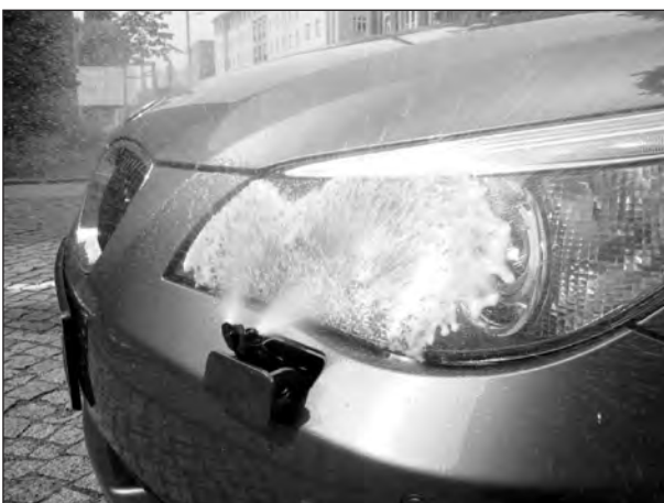
Bild 45: Scheinwerferreinigungsanlage für Gasentladungsscheinwerfer; Quelle: [IQ2]
