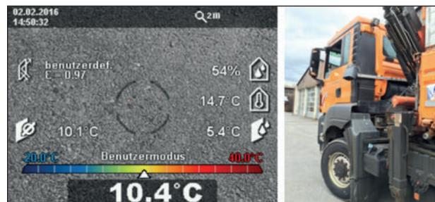
Bild 50: Vergleichsmessung/Kalibrierung MARWIS am Streufahrzeug SM Viechtach bei bedecktem Himmel (Foto: Karl Schedler)
