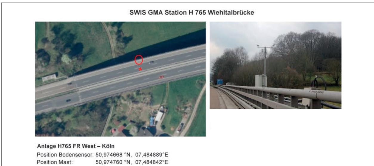
Bild 26: Lage der GMA Wiehltalbrücke H765 in der Satellitenkarte (Tool: GeoBasis-De/BKG(2020)). Anlage in FR West/Köln. Eine Bodensonde in FR West/Köln in der Mitte des linken äußeren Fahrstreifens (Foto: BAST)
