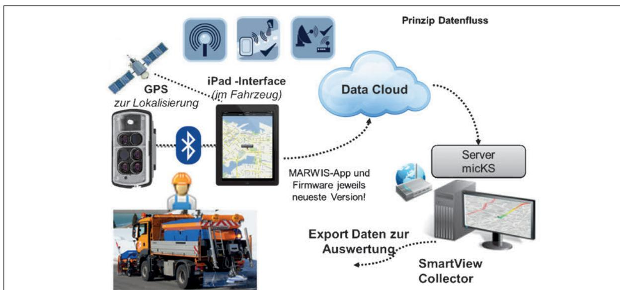
Bild 32: Prinzip der mobilen Datenerfassung an Einsatzfahrzeugen der Meistereien
