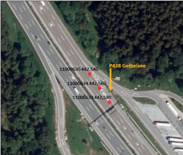
Bild 7: (Zoom-)Auszug aus dem Streckenmodell im Bereich der Station Gelbelsee mit Markierung der Referenzpunkte für die Streckensegmente. RSEG\_ID und KILOMTR. (Bitte beachten die Kilometerangabe im Modell stimmt nicht mit den offiziellen Betriebskilometer überein). (Tool: GeoBasis-DE/BKG(2020))
