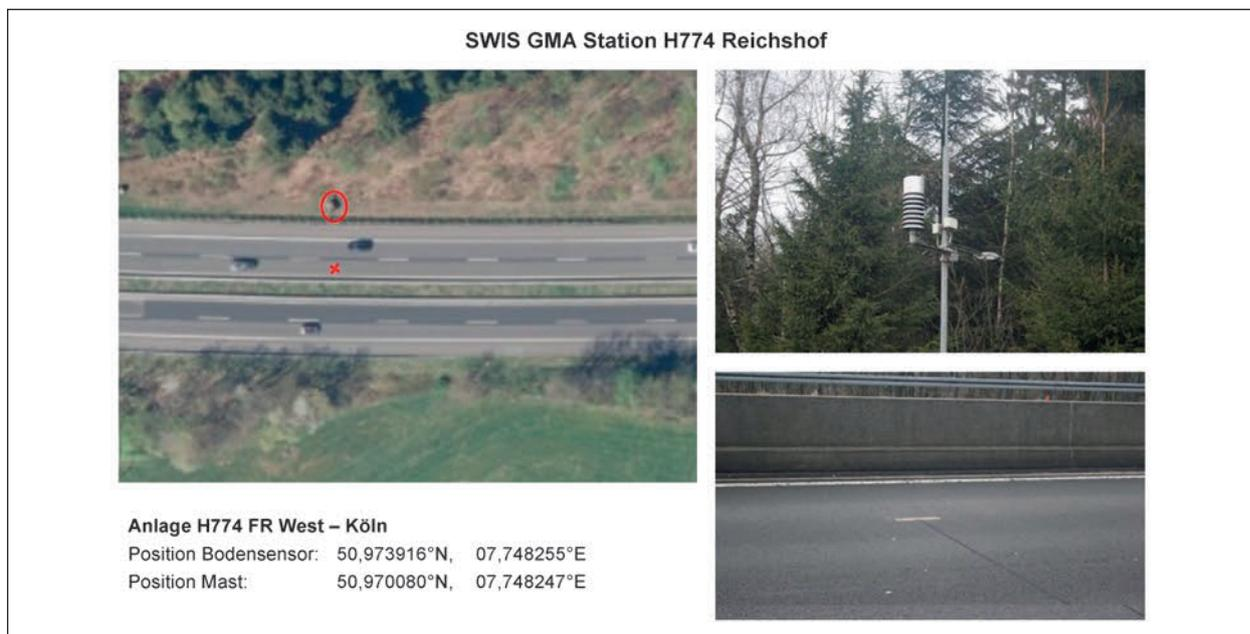
Bild 28: Lage der GMA Reichshof H774 in der Satellitenkarte (Tool: GeoBasis-De/BKG(2020)). Anlage in FR West/Köln. Eine Bodensonde in FR West/Köln in der Mitte des linken äußeren Fahrstreifens (Foto: BAST)
