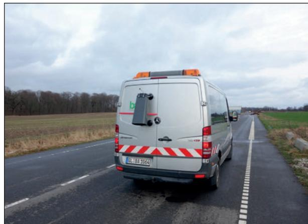
Bild 40: Dienstfahrzeug der BAST mit montiertem mobilen Sensor MARWIS 2m-Version mit langem Schutzgehäuse. Hier noch zu Beginn des Projektes ohne Strahlungssensoren und ohne atmosphärische Messung
