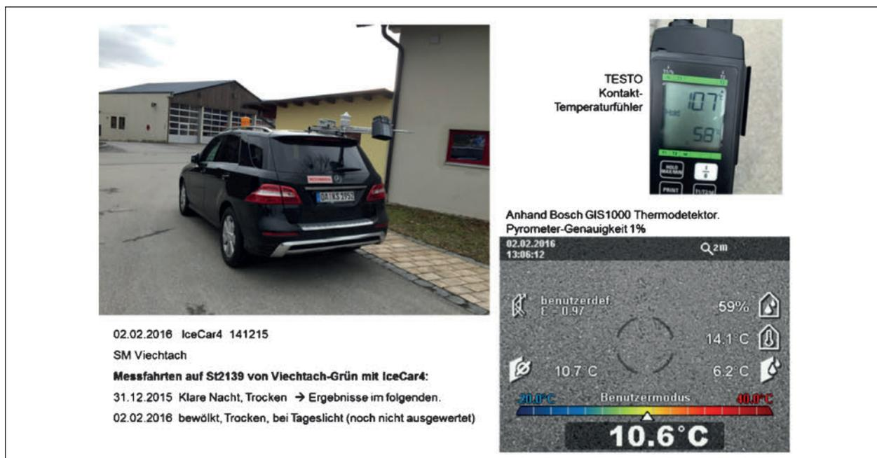
Bild 52: Kontrolle und Kalibrierung der MARWIS Temperaturmessung am IceCar4. Zusätzlich Vergleich mit Kontaktthermometer. MARWIS-Anzeige stimmt exakt mit Pyrometer überein. Kontaktthermometer zeigt um 0,1 °C höhere Temperatur und damit deutlich in der Toleranz (Fotos: Karl Schedler)
