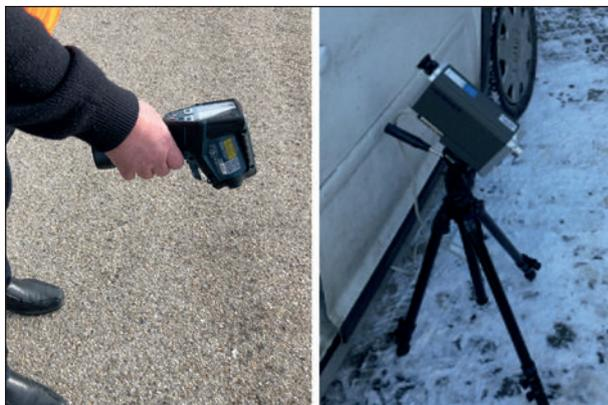
Bild 51: Handheld Pyrometer GIS 1000 C von Bosch und rechts ein HEITRONIC Labor-Pyrometer als Referenzinstrumente (Foto: Karl Schedler)
