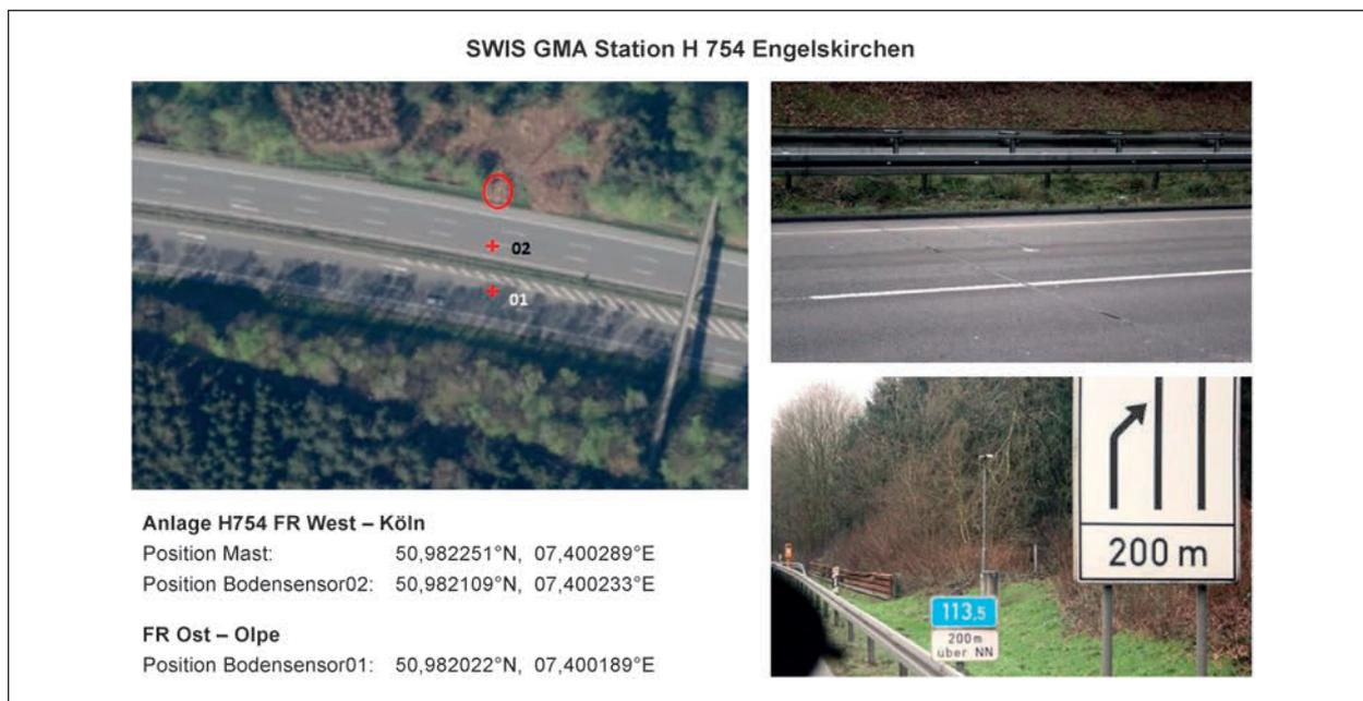
Bild 27: Lage der GMA Engelskirchen H754 in der Satellitenkarte (Tool: GeoBasis-De/BKG(2020)). Anlage in FR West/Köln. Je eine Bodensonde in beiden FR jeweils in dem linken äußeren Fahrstreifen (Fotos: BAST)
