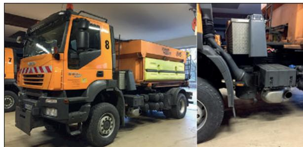
Bild 33: Montage des mobilen Straßenzustands-Sensors am Streufahrzeug (Lkw) der AM Greding. Der Abstand zum Führerhaus ermöglicht eine sichere Bluetooth (drahtlose) Datenverbindung (Fotos: Karl Schedler)
