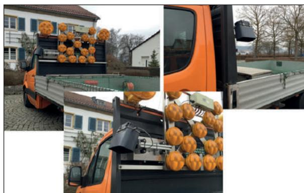
Bild 37: Montage des Straßenzustands-Sensor MARWIS am Kolonnenführer-Fahrzeug (KoF) der AM Greding. Eine 2m-Version (Messabstand ca. 2 m) mit kurzem Schutzgehäuse (Fotos: Karl Schedler)
