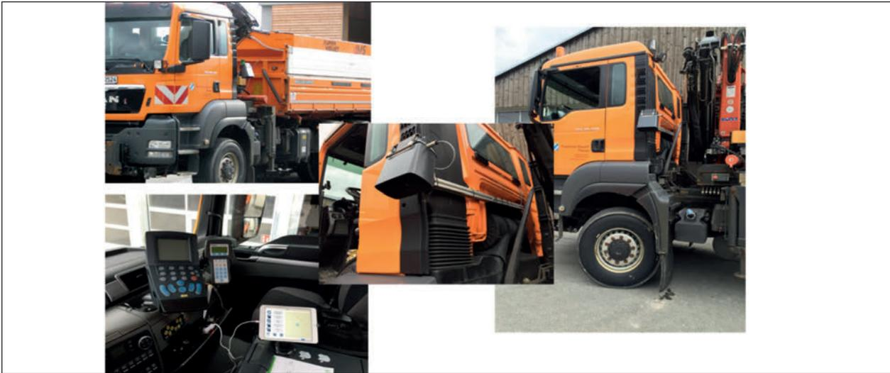
Bild 38: Ausstattung des MAN Streuerfahrzeugs (Streuer: Küpper-Weisser) der SM Viechtach mit Straßenzustands-Sensor MARWIS 2m-Version mit kurzem Schutzgehäuse. Montiert auf der Rückseite des Führerhauses mit Magnethalterung und mechanischer Sicherung. Im Führerhaus miniIPAD von Apple mit MARWIS-App und Mobilfunkanbindung (Fotos: Karl Schedler)
