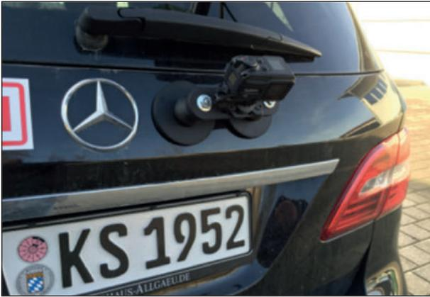
Bild 46: Action-Kamera GARMIN VIRB und Anbringung der Kamera über Magnethalterung am Heck des Fahrzeugs (alternativ auch auf dem Dach an der Front) (Foto: Karl Schedler)
