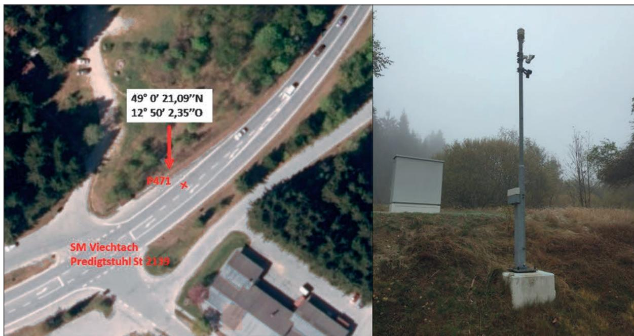
Bild 21: Lage der GMA Predigtstuhl P471 auf der St2139 (Bild: SM Viechtach). Ansicht der atmosphärischen Sensoren mit Kamera auf einem Mast am Straßenrand (Foto: Karl Schedler)
