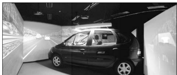
Bild 5: Immersiver Fahrsimulator des Fraunhofer IAO und des Instituts IAT der Universität Stuttgart
