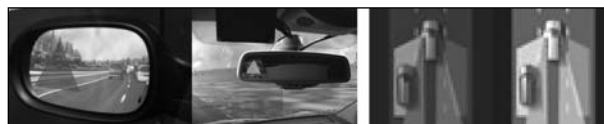
Bild 7: Visuelle Rückmeldung der BSW im linken Außenspiegel bzw. Innenspiegel (links); Statusanzeige „off/on“ im Kombiinstrument (rechts)
