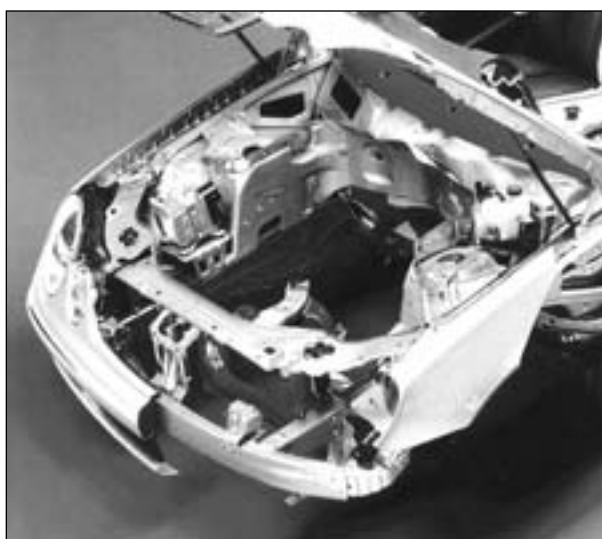
Bild 4.6: Vorbau Mercedes-Benz E-Klasse W211 (Modell ab 2002), nach SCHÖNEBURG et al. (2002) [51]
