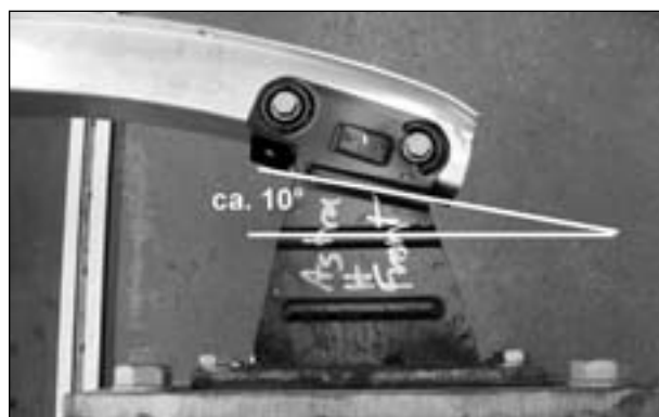
Bild 4.28: Crashbox Opel Astra H (Modell ab 2004), möglicherweise bereits ausgelegt für RCAR/AZT-10°-Barriere-test
