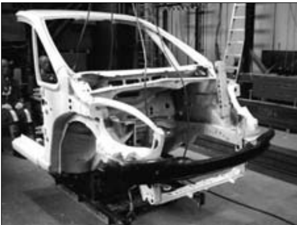
Bild 6.6: Frontteil der Rohkarosserie Citroën Xsara Picasso mit einem Querträger aus Kunststoff
