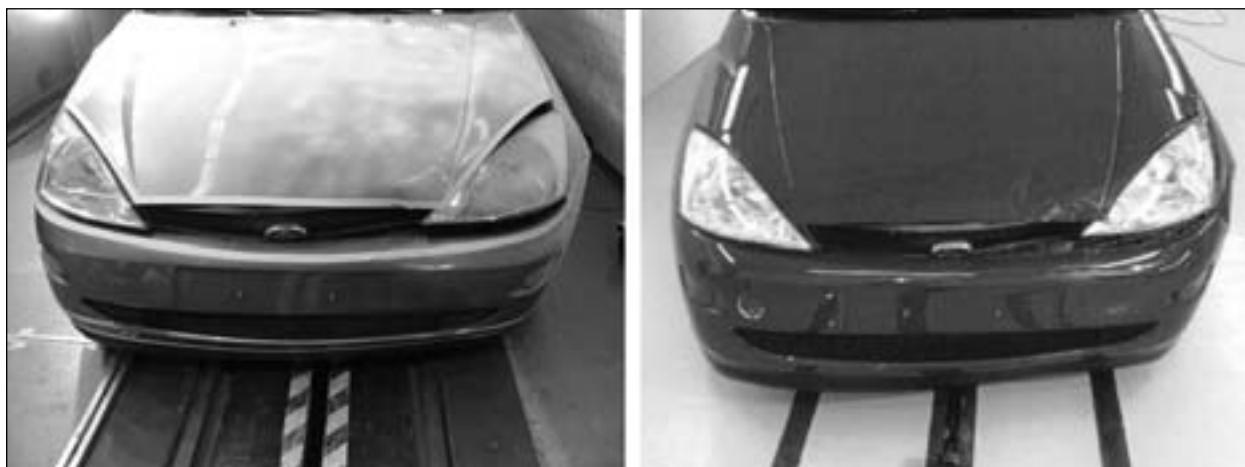
Bild 7.5: Fahrzeuge nach durchgeführtem Frontcrash (links IFT-, rechts AZT-Versuch, Nr. 1070 aus Eurotax [17]), Ansicht frontal
