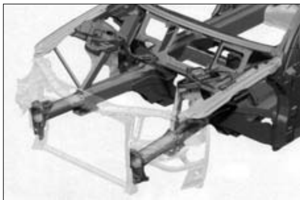
Bild 4.4: Vorbau Audi A8 (Modell ab 2002) mit Strangpressprofilen als Längsträgerelemente, Frontmaske transparent abgebildet, aus MAYER et al. (2002) [39]
