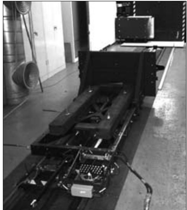
Bild 6.4: Versuchsaufbau (Vordergrund: Prüfschlitten bestückt mit Zusatzgewichten, Prallbarriere, Datenerfassungstechnik; Hintergrund: Aufprallbarriere)
