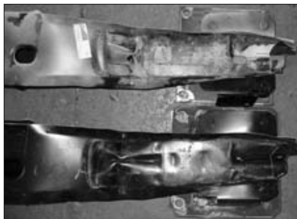
Bild 7.1: Querträger Ford Focus nach Versuchen, oben: Versuch 52, unten: Versuch 31
