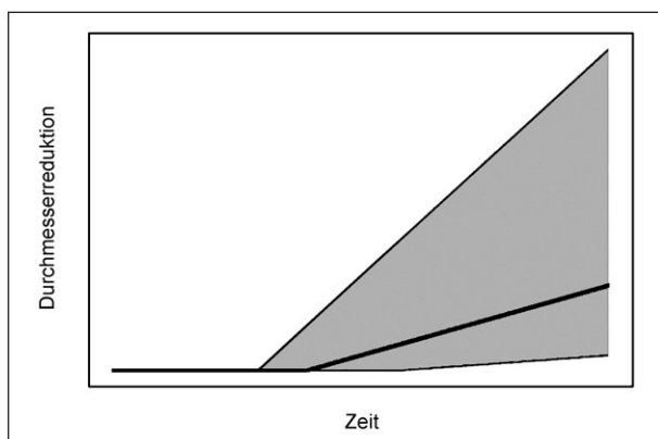
Bild 6-9: Beispiel der Prognose vom Reduktion des Bewehrungsdurchmessers (Mittelwert \pm Standardabweichung) durch gleichmäßige Korrosion
