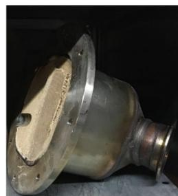
Abbildung 6.3: DPF: Einbaulage, Bauteil und Änderung auf Flanschsystem
