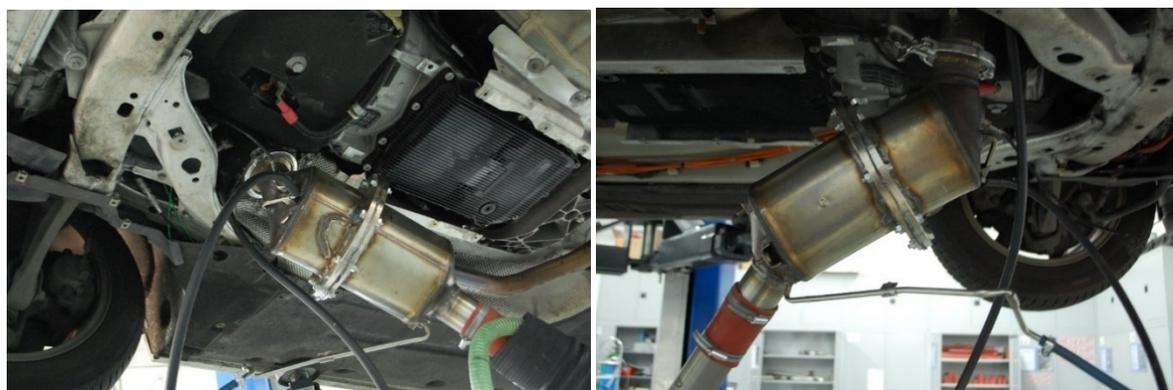
Abbildung 6.7: Partikelanzahlmessungen mit beschädigtem DPF
