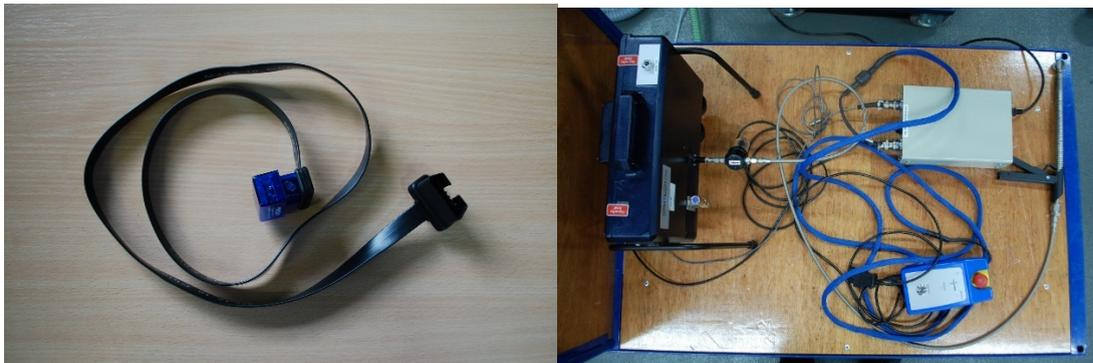
Abbildung 2.2.3: OBD Adapter mit Bluetooth Übertragung links (Version 1 mit Kabel rechts)
