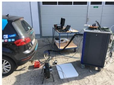
Abbildung 5.3.2: Testfahrzeug VW Golf Sportsvan und Messaufbau
