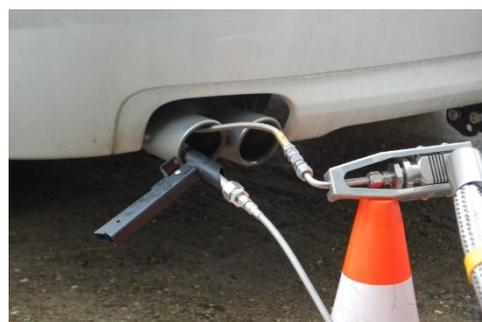
Abbildung 6.6: Partikelanzahlmessung, BMW 520 dA mit DPF „intakt“
