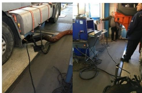
Abbildung 7.2.3: Partikelanzahlmessung und Abgasuntersuchung
