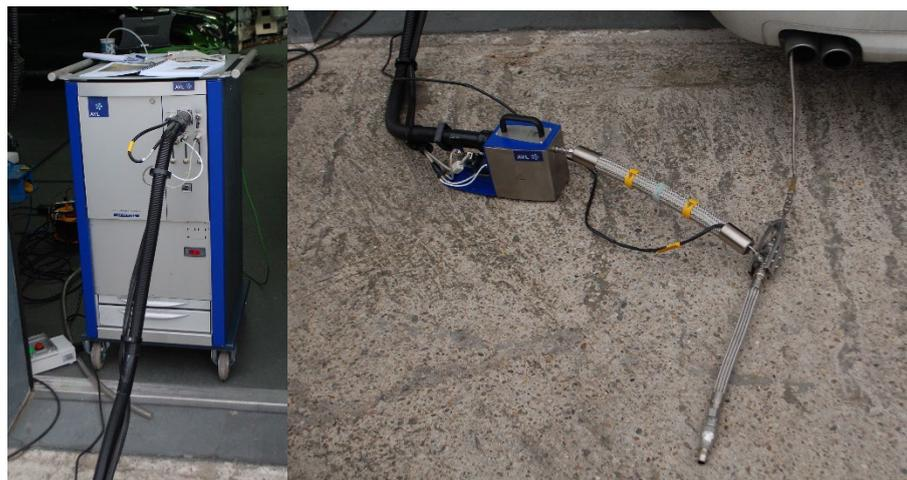
Abbildung 2.1: Referenzzähler AVL 489, beheizte Entnahmesonde, Vorverdünner und Hochdruckoption
