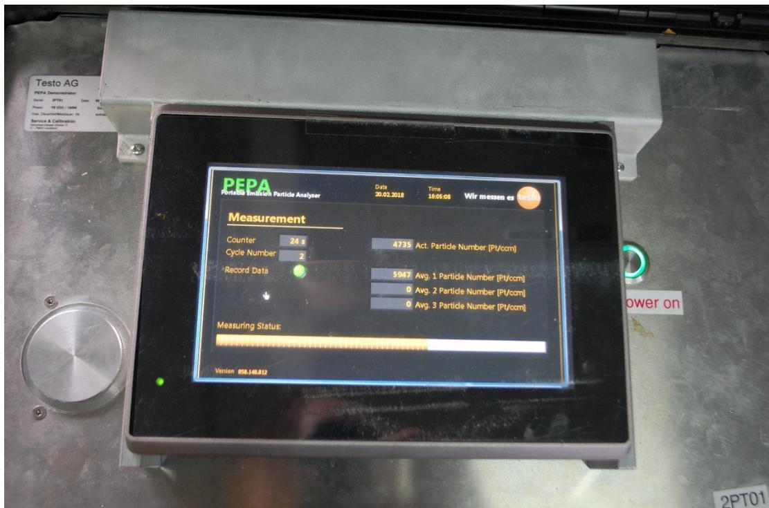
Abbildung 2.3.4: Messung der Partikelanzahlkonzentration der Umgebungsluft
