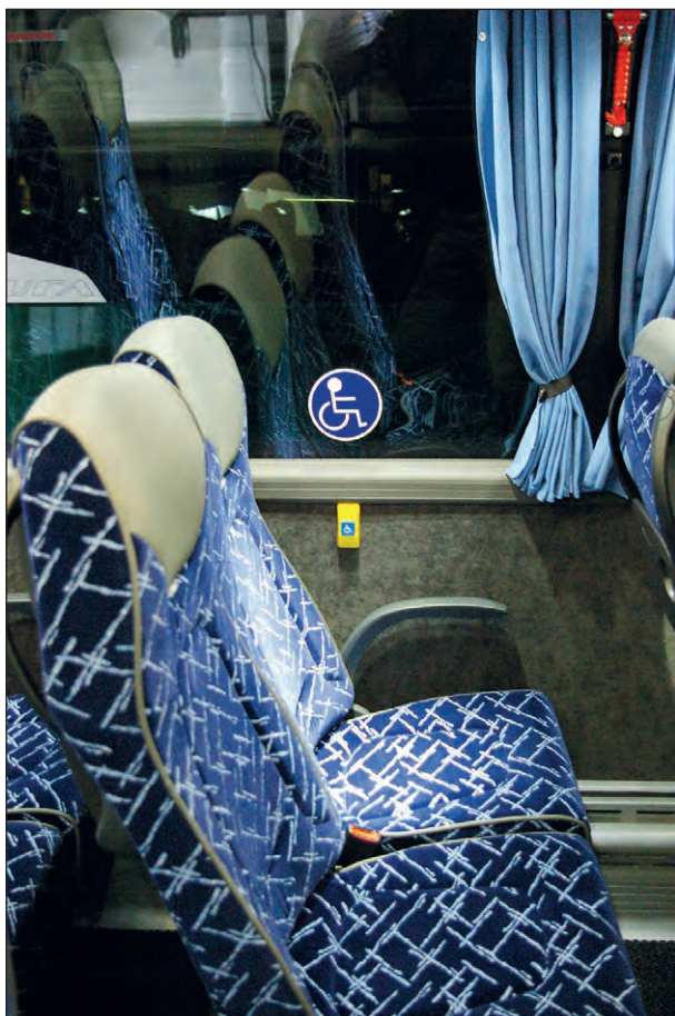
Bild 25: Piktogramm zur Kennzeichnung des Rollstuhlstellplatzes und Kommunikationseinrichtung (hier mit eingebauten Fahrgastsitzen am Rollstuhlstellplatz) (Quelle: VDL Bus & Coach B. V.)
