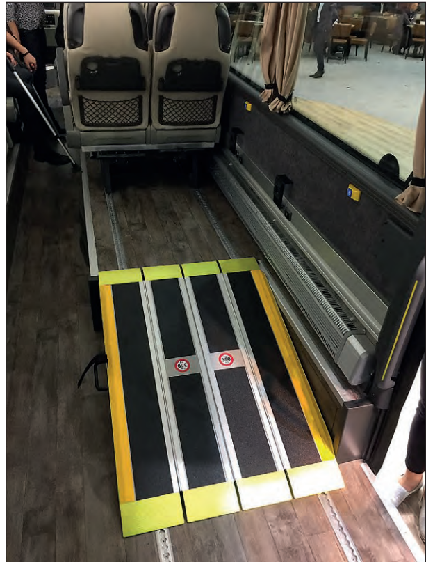
Bild 15: Faltrampe ausgelegt zur Auffahrt zum Rollstuhlstellplatz auf einem Podest
