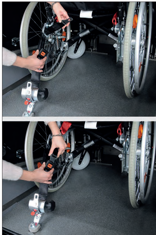
Bild 34: Verbinden des Rückhaltesystems mittels Gurt und Öse am Kraftknoten (Quelle: AMF Bruns)
