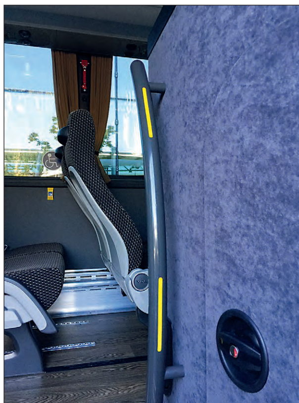
Bild 41: Visuell kontrastierend markierte Haltestangen im Bus
