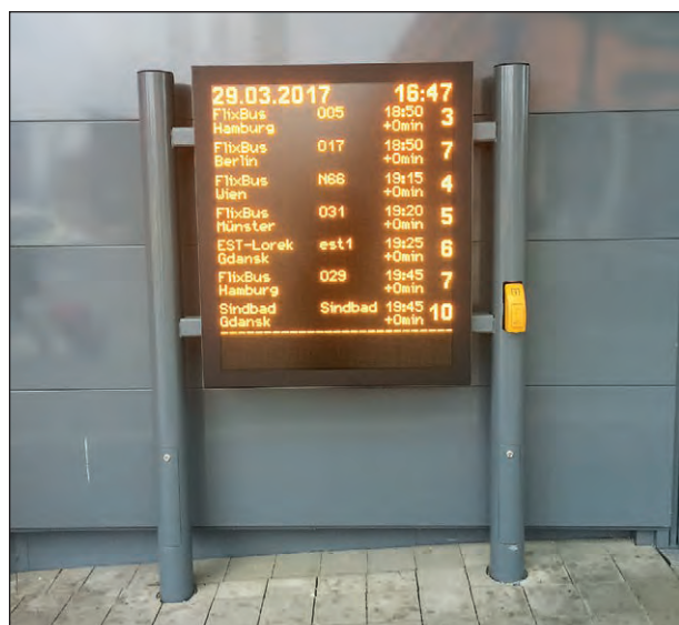
Bild 102: Dynamische Fahrgastinformation mit Anforderungstaster zum Abrufen akustischer Informationen – Beispiel ZOB Hannover
