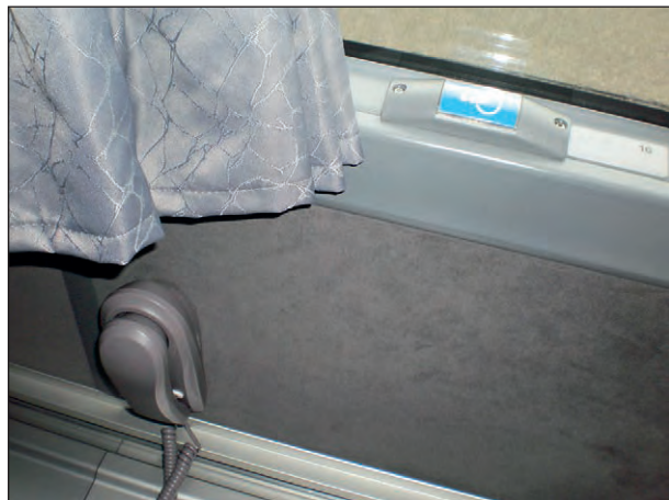
Bild 40: Kommunikationseinrichtung am Rollstuhlstellplatz: (bidirektional) (Quelle: Deutsche Bahn AG)
