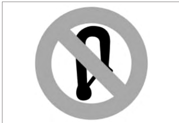
Bild 24: Warnhinweis, dass der Rollstuhl nicht den Anforderungen an die Stabilität für die Verwendung als Fahrzeugsitz gem. ISO 7176-19 entspricht
