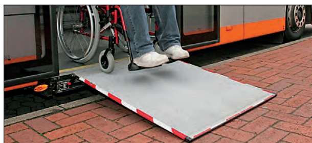
Bild 11: Elektrisch betriebene Rampe mit visuell kontrastierender Randmarkierung (Quelle: Palfinger MBB)
