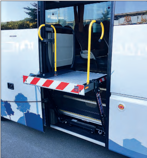
Bild 17: Hublift mit innenliegender Kassette im Betrieb
