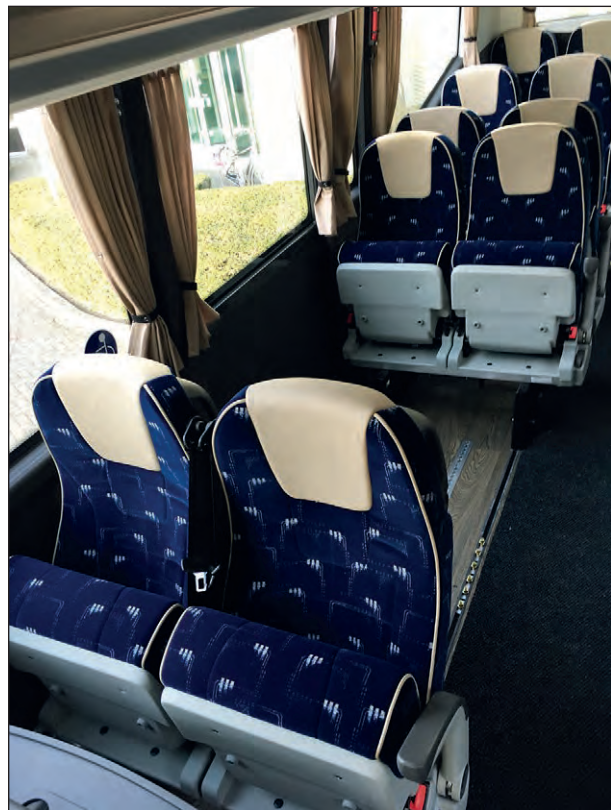
Bild 29: Zusammengeschobene Sitzreihen am Rollstuhlstellplatz („Kino-Sitze“ mit klappbarer Sitzfläche) (Quelle: VDL Bus & Coach B. V.)
