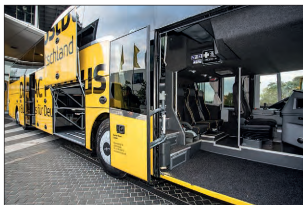
Bild 4: Beispiel für einen Hochdeckerbus mit Unterflurcockpit und Niederflureinstieg vorne (Quelle: ADAC)
