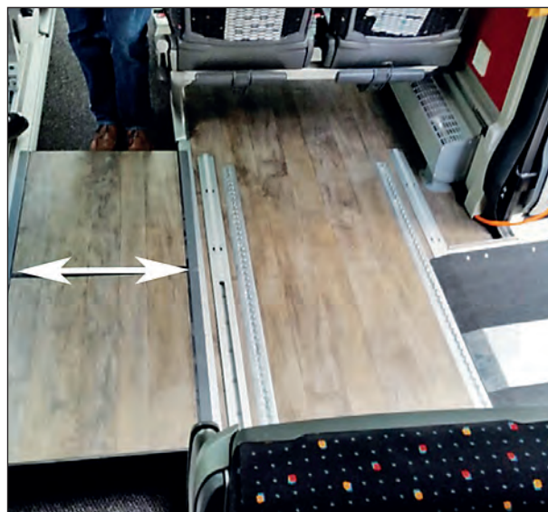
Bild 26: Auszugelemente zur Abdeckung des tiefen Ganges bei Podesten (Quelle: BLB)
