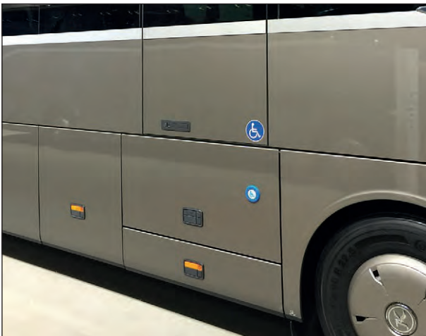
Bild 6: Kennzeichnung der Betriebstür für den Zugang eines Rollstuhlfahrers mittels Piktogramm an der separaten Schlagtür
