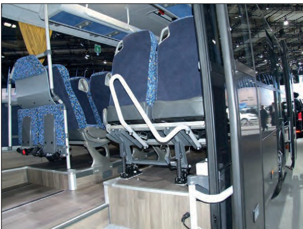
Bild 19: Nach vorne geklappte Sitzbank, um die erforderliche lichte Weite für den Betrieb des Hubliftes zu erreichen
