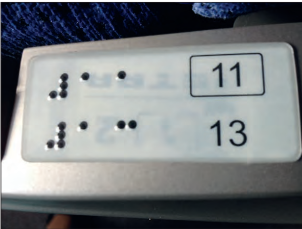
Bild 47: Taktile ertastbare und visuell kontrastierende Sitzplatznummerierung - Detailansicht (Quelle: Deutsche Bahn AG)
