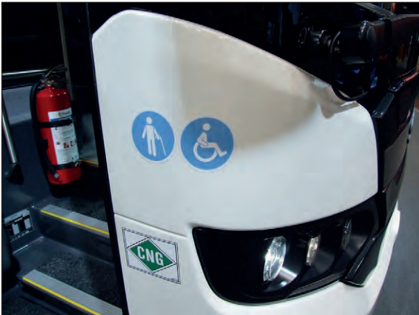
Bild 5: Kennzeichnung eines Busses an der vorderen Betriebstür mit Piktogrammen gemäß UN/ECE R 107
