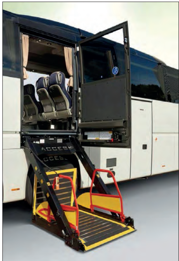
Bild 21: Hublift mit außenliegender Kassette an einer Schlagtür über der Hinterachse (Quelle: VDL Bus & Coach B. V.)
