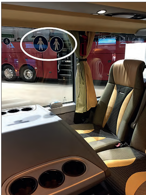
Bild 44: Kennzeichnung der Sitze für mobilitätseingeschränkte Fahrgäste in gegenüberliegender Anordnung und zusätzlichem Tisch durch Piktogramme gem. UN/ECE R 107
