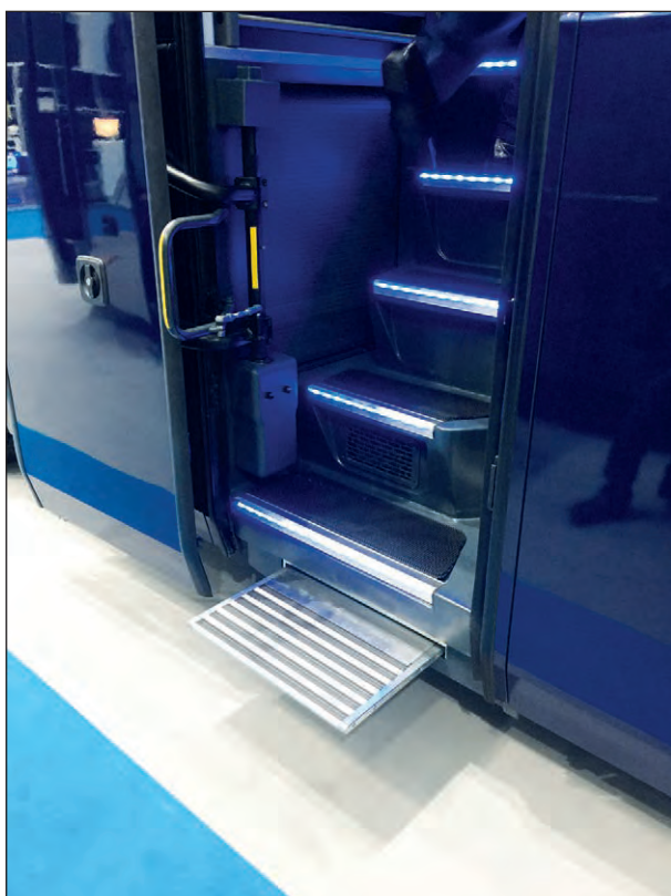
Bild 7: Schiebetritt zur Verringerung der Stufenhöhe der ersten Stufe zur Einhaltung der vorgeschriebenen Grenzwerte für die Höhe der ersten Stufe über der Fahrbahnoberfläche
