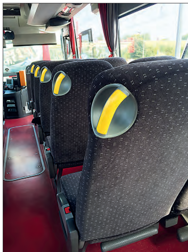
Bild 42: Visuell kontrastierende Ausführung der Handgriffe an den Fahrgastsitzen
