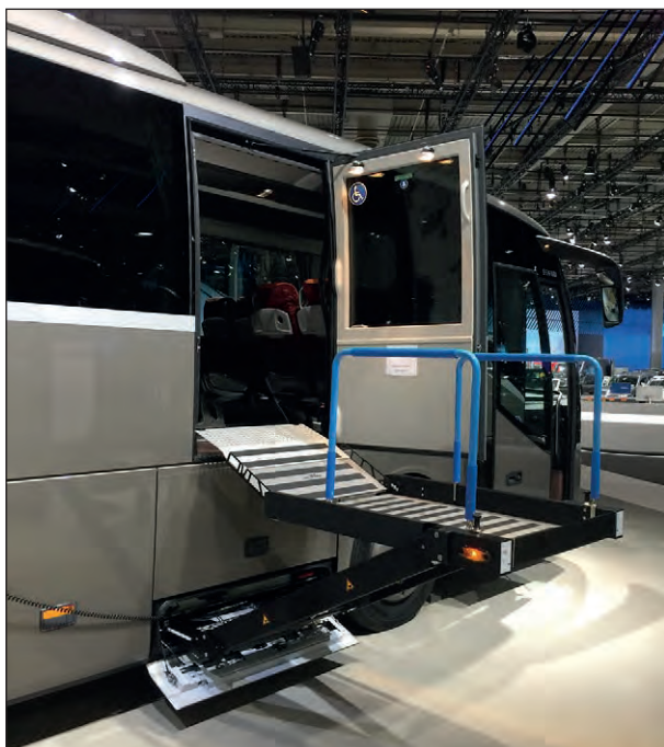
Bild 22: Hublift mit außenliegender Kassette an einer hinter der Vorderachse angeordneten Schlagtür
