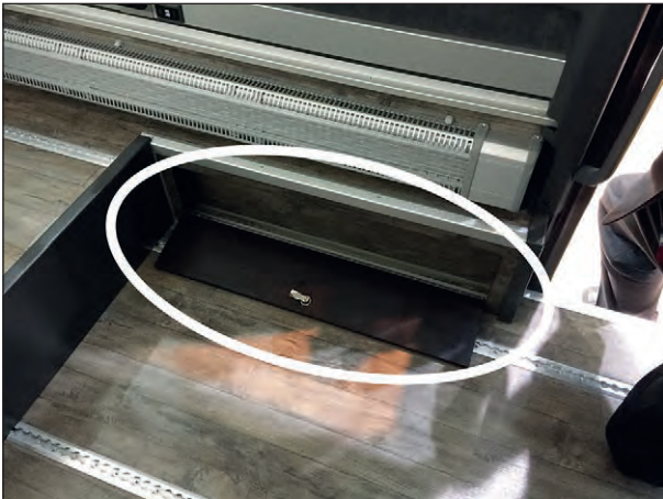
Bild 38: Fach für Rückhalteeinrichtungen neben einem Rollstuhlstellplatz
