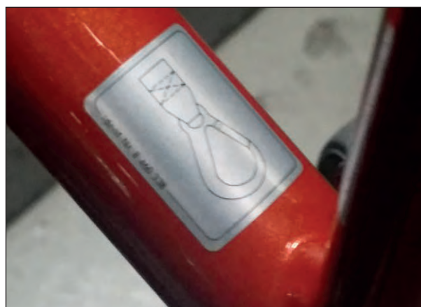
Bild 30: Kennzeichnung eines geeigneten Befestigungspunktes für das Rückhaltesystem am Rollstuhl nach ISO 7176-19 (Quelle: MEYRA GmbH)
