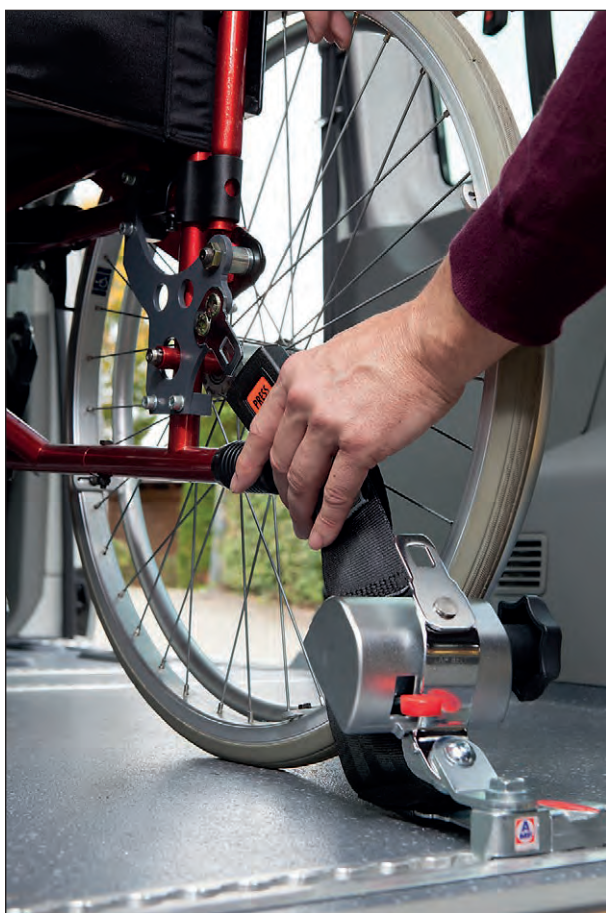
Bild 35: Verbinden des Rückhaltesystems mittels Gurtschloss und Schlosszunge am Kraftknoten (Quelle: BGW/Eva Häberle)
