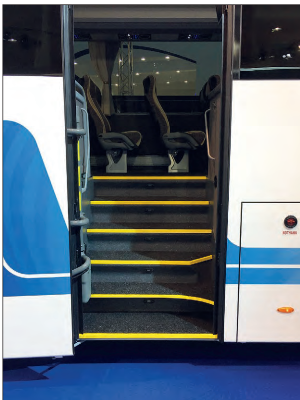
Bild 8: Einstiegsstufen mit visuell kontrastierender Stufenkantenmarkierung
