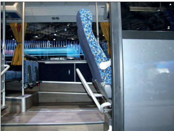
Bild 18: Sitzbank im Betriebszustand mit Einschränkung der lichten Weite des Türbereichs
