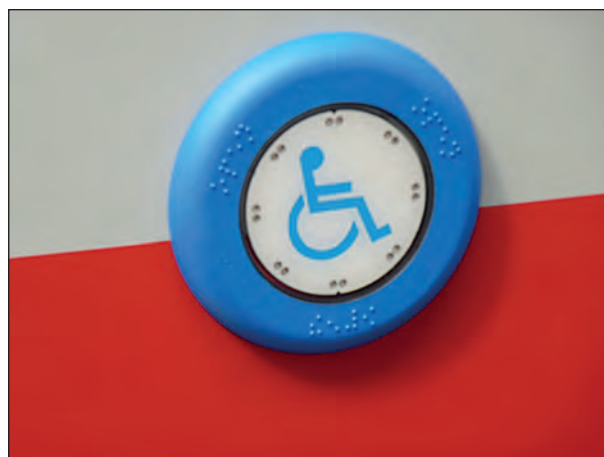
Bild 23: Kommunikationseinrichtung zur Anforderung einer Einstiegshilfe neben der Betriebstür an der Fahrzeugaußenseite (Quelle: BSK)
