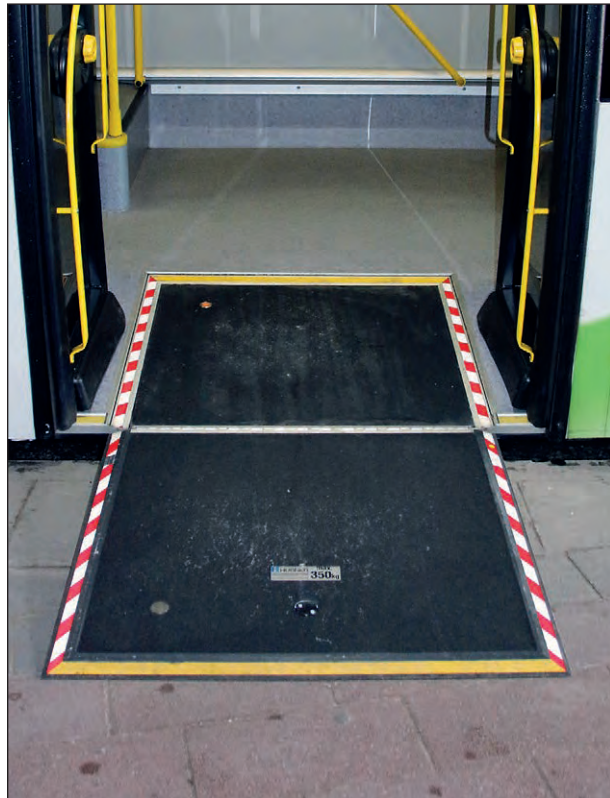
Bild 10: Klapprampe mit visuell kontrastierender Randmarkierung
