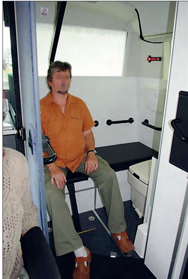
Bild 51: Beispiel für ein barrierefreies WC im Heckbereich eines Reisebusses (Foto: BSK, Peer Maßmann)
