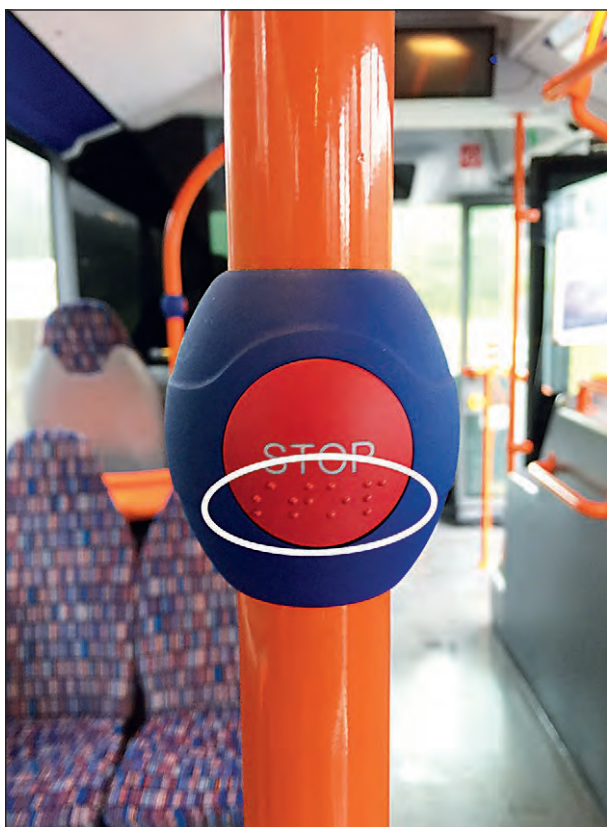
Bild 49: Beispiel für eine taktile Kennzeichnung einer Kommunikationseinrichtung (hier: Haltewunschtafter) im Bus 38 (Beispiel aus dem ÖPNV)
