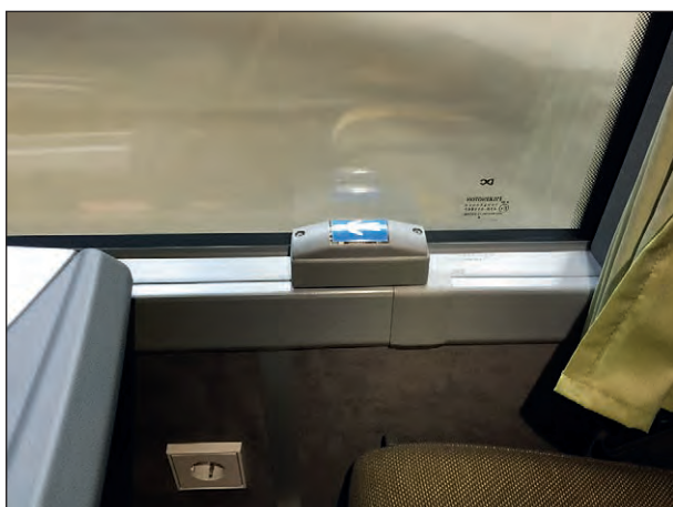
Bild 48: Kommunikationseinrichtung neben dem Sitzplatz für Fahrgäste mit eingeschränkter Mobilität
