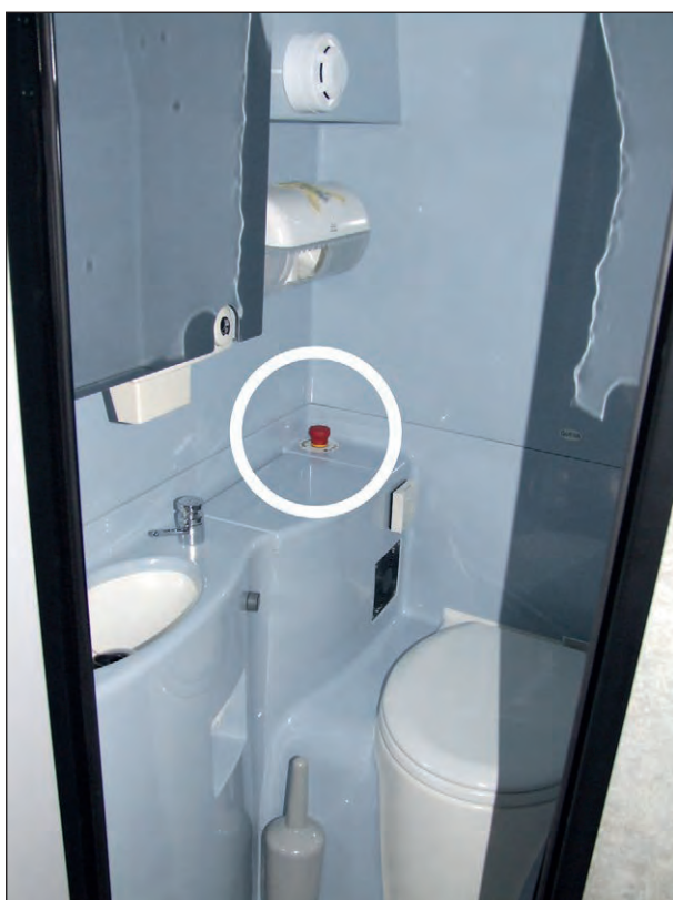
Bild 53: Bord-WC mit visuell kontrastierendem Notruftaster
