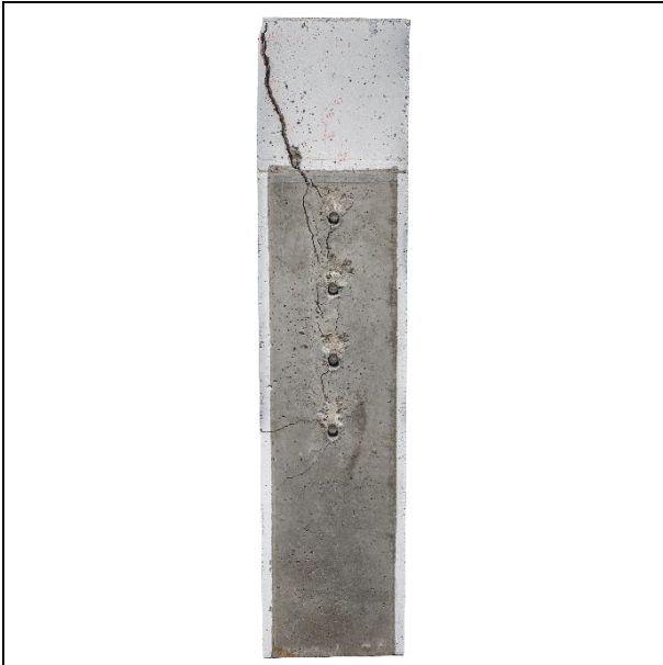
Bild 3-13: Rissbild der Stirnflächen des Betonkörpers am Ende des Versuchs (P-07)
