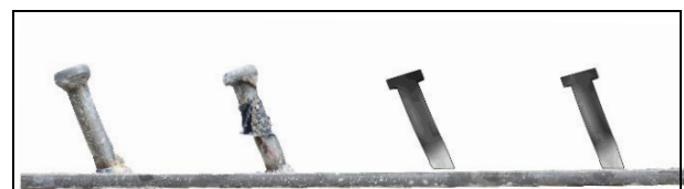
Bild 4-25: Vergleich der Verformungen der Kopfbolzen P-11 (nach Überschreiten der Traglast, maßstäbliche Darstellung)
