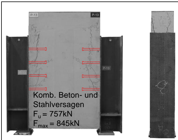
Bild 3-29: Versuchskörper P-13 am Ende des Versuchs
