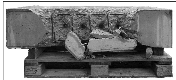
Bild 3-50: Betondruckstrebenbruch: Versuchskörper P-10
