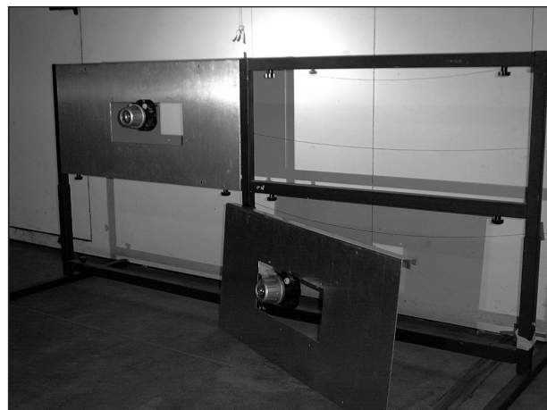
Bild 9.1: Messgestell mit einer aufgesetzten Scheinwerferhalterung
