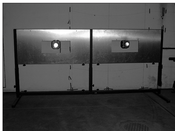
Bild 9.2: Messgestell mit aufgesetzten Scheinwerferhalterungen
