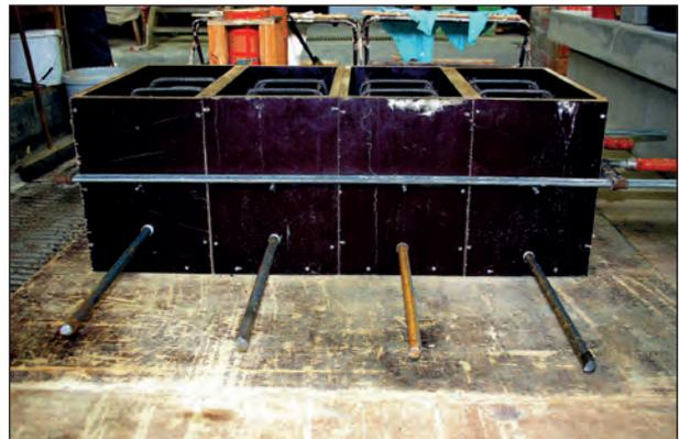
Bild 16: Versuchskörper der Charge 1 unmittelbar vor der Betonage
