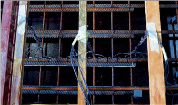
Bild 42: Kabelführung der DMS
