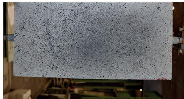
Bild 19: Zufallsmuster für das Messsystem ARAMIS
