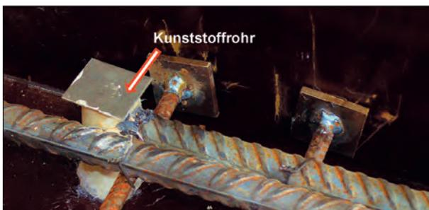
Bild 44: Realisierung der Schlupfmessung
