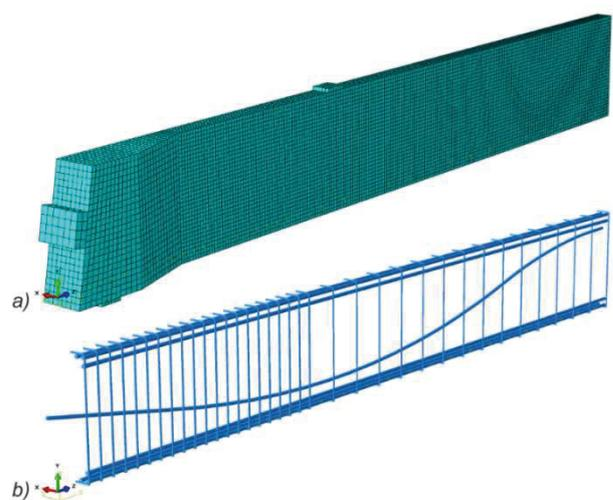
Bild 48: Darstellung der a) Volumenelemente für Beton; b) Fachwerkelemente für Bewehrung und Spannglied
