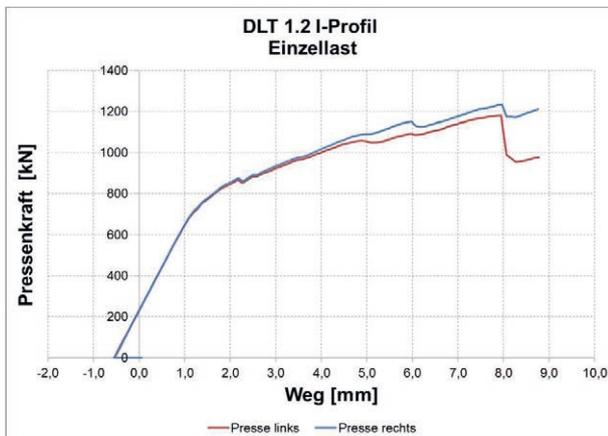
Bild 219: Last-Verformungs-Kurven aus der ATENA Simulation
