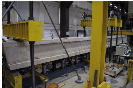
Bild 40: a) Versuchsanordnung und Messtechnik Streckenlastversuch; Versuchsaufbau von b) DLT 1.4, c) DLT 1.5
