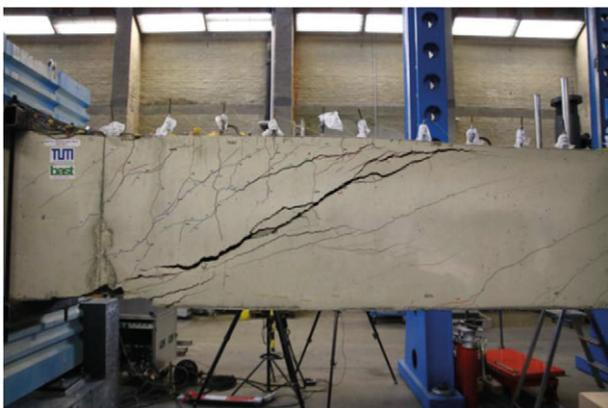
Bild 136: Bruchbild des Trägers V4 mit oben offenen Bügeln und geraden Stabenden im Bereich der Mittelstütze
