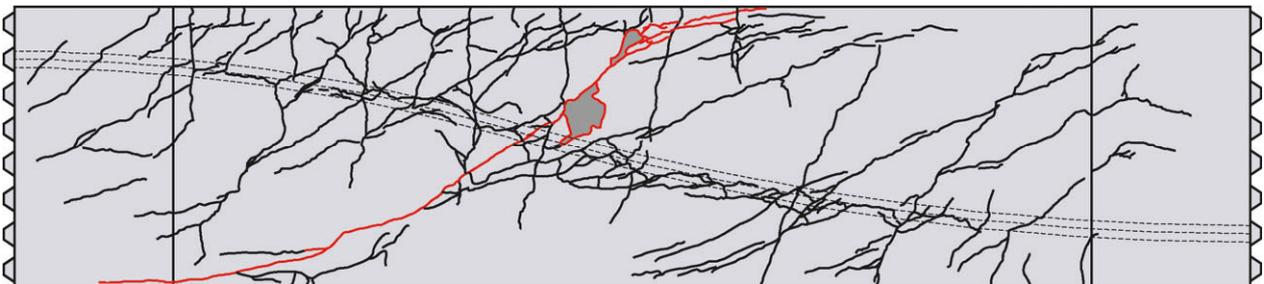
Bild 146: Rissbild Versuch V9, gestoßene Bügel Ø6/25, nach dem Bruch
