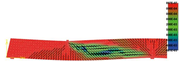
Bild 278: Rissbild Simulation (kurz vor Bruch); Rissbreiten  $\geq 0,1$  mm
