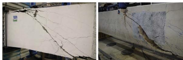
Bild 118: Vergleich der Rissbilder (kritischer Schubriss im Feldbereich) für ein Durchlaufträger-Teilsystem bei Prüfung im Substruktur-Versuchsstand (linkes Teilbild) und einen ganzen Durchlaufträger (rechtes Teilbild, Querkraftversuch DLT 1 RWTH Aachen) (SCHRAMM, 2020)
