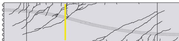
Bild 151: Rissbild V3 für Laststufe 88%  $V_{max}$  und zugehörige Lage des betrachteten Bügels Nr. 8
