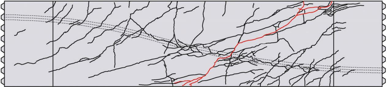
Bild 143: Rissbild Versuch V6, , geschlossene Bügel Ø6/25 + Steckbügel im Stützbereich, nach dem Bruch
