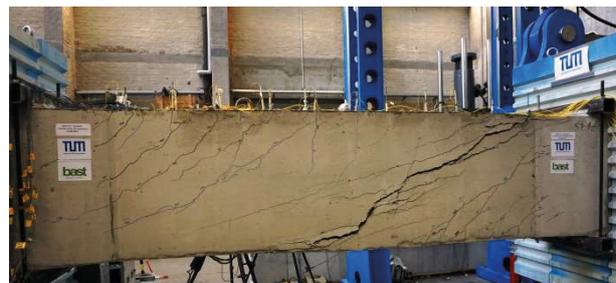
Bild 138: Bruchbild des Trägers V6 mit geschlossenen konventionellen Bügel Ø6/25 und Stecker-Zulagen im Stützbereich; Versagensstelle im Feldbereich
